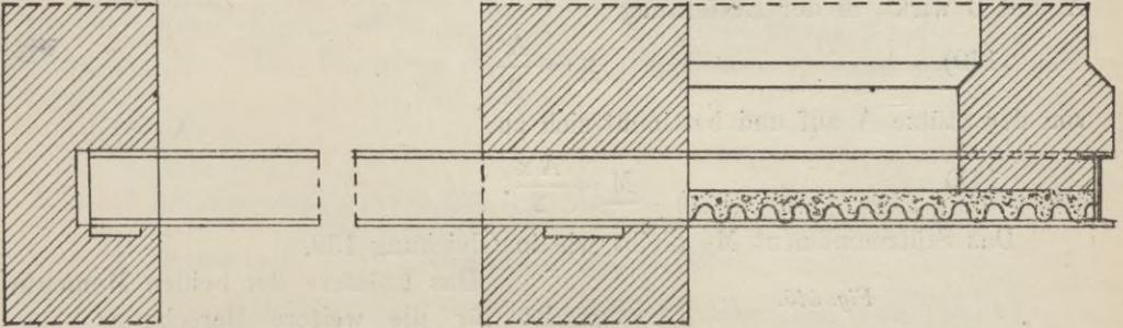
in den beiden Frontmauern findet, lässt die Balkonträger bis an diesen Träger gehen, mit welchem jene vernietet werden und schiebt die Deckenträger an den Hilfsträger an.
