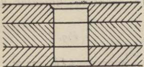
Kommen Verschiebungen der Nietlöcher vor, so muss diesem Uebelstande durch Aufreiben mit der Reibahle abgeholfen werden. In derart aufgeriebene Löcher sind entsprechend stärkere Nietbolzen einzuziehen (Fig. 9 und 10).
