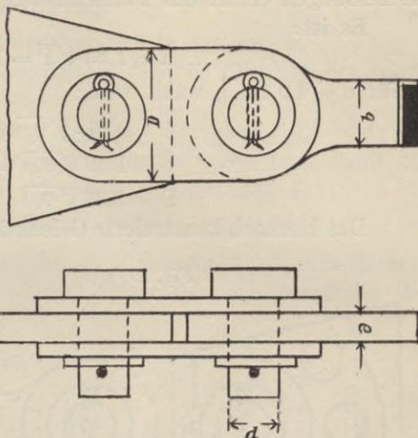
**Berechnung des zweisechnittigen Gelenkes.** Bezeichnet  $d$  den Durchmesser des Bolzens,  $P$  die ziehende Kraft in  $t$ , so wäre gegen Abscheren mit  $800 \text{ kg} = 0,8 \text{ t/qcm}$  zulässiger Beanspruchung des Querschnittes:
