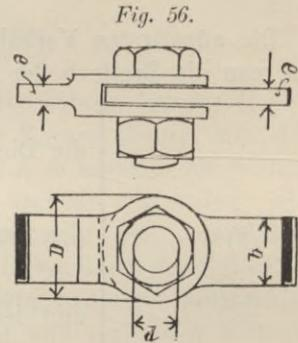
Fig. 56 zeigt das Gelenk mit der gabelförmigen Endigung. Diese ist indessen nur sehr schwer herzustellen und daher teuer, ausserdem bei nicht ganz sorgfältiger Ausführung unzuverlässig.
