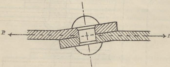
Infolge der Wirkung des auftretenden Kräftepaars, dessen Moment  $M = P \cdot \delta$  beträgt, wird jedenfalls eine Verbiegung des Nietes oder der Bleche oder gleichzeitig beider Teile auftreten. Die aus dem Momente herrührenden Biegungs-Spannungen können unter Umständen eine sehr grosse Höhe erreichen.
