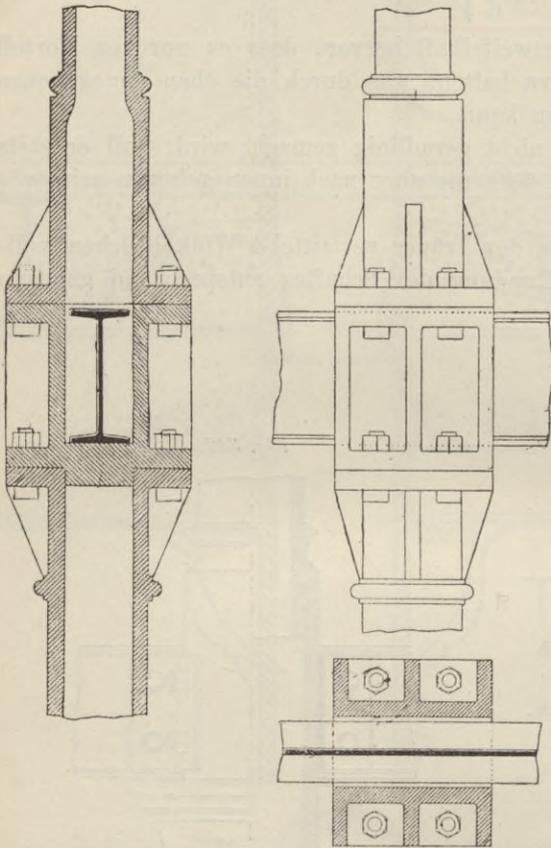
dessen ist zu bemerken, dass das Durchstecken der Träger oft Schwierigkeiten macht wegen der Länge des Unterzuges.
