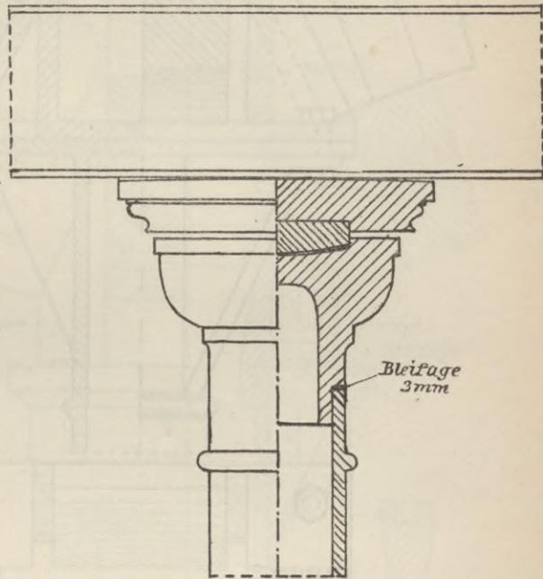
geführten Schaft gelegt unter Zuhilfenahme eines Bleiringes. Ein ausgezeichnetes Mittel, die Last achsial zu übertragen, bietet das bewegliche Kugellager, wovon Fig. 324 ein Beispiel liefert. Bei derartigen Säulen ist der Fuss entsprechend ausgebildet. Leider haben derartige Säulen im Hochbau noch wenig Eingang gefunden.
