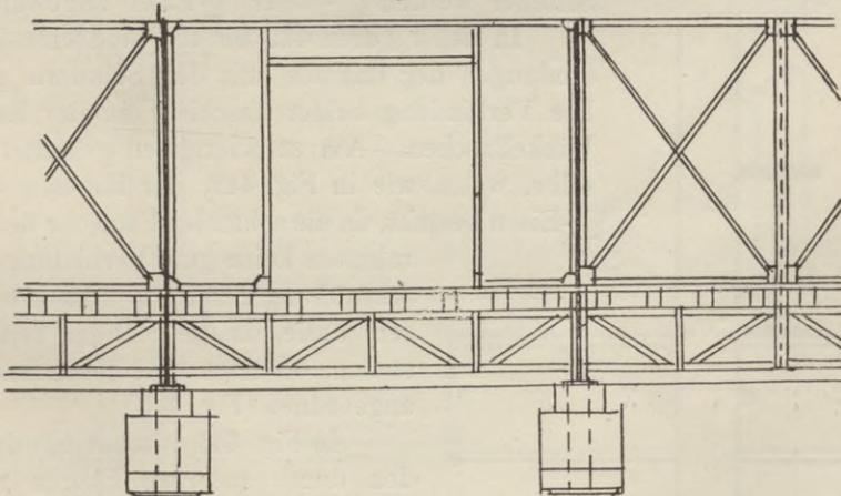
**Schwellen.** Zu den Schwellen werden in der Regel flach gelegte  $\square$ -Eisen benutzt, die ihrer ganzen Länge nach auf dem Fundamentmauerwerk ruhen und ihre Flansche nach oben kehren. Auch kommen  $\Gamma$ - und  $\sqsubset$ -Eisen häufig zur
