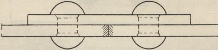
Mit Beziehung auf Fig. 18 bezeichne  $P$  die zu übertragende Kraft,  $\delta$  die Blechstärke.
