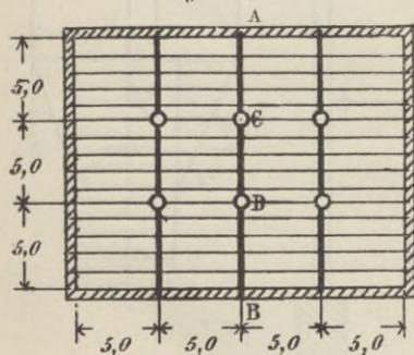
geschoß dient zu Wohnzwecken. Die dasselbe tragenden Säulen übertragen auf die unteren Säulen eine achsiale Last von 18000 kg (Fig. 363).
