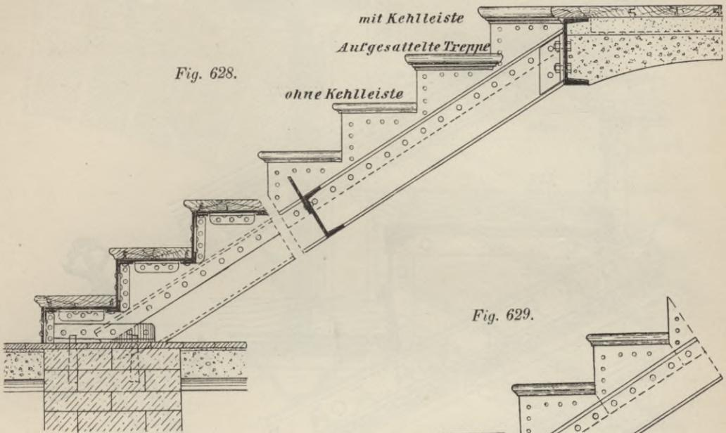
Eine andere Art der Stufen-dreiecke zeigt Fig. 628. Sie sind aus einem vollen Bleche heraus-geschnitten, welches mit der  $\square$ -Eisenwange vernietet ist. Da hierbei viel Material verloren geht, so werden vielfach die Stufen-dreiecke einzeln gefertigt und nun in derselben Weise mit der Wange verbunden (Fig. 629).
