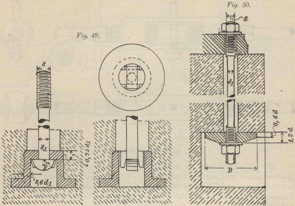
messer  $d$  des Bolzens gegeben. Die Muffe ist entweder rund, achteckig oder sechseckig, offen oder geschlossen. Der äussere Durchmesser der runden bzw. derjenige der dem achteckigen oder sechseckigen Querschnitt umschriebenen Kreises ist  $2d$ , die Länge des Spanschlusses etwa 7 bis 8  $d$ .
