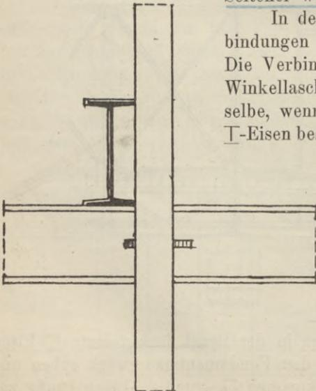
**Rahmen.** Für die Rahmen nimmt man meist T-Eisen, die entweder einzeln oder doppelt angeordnet werden, namentlich dann, wenn sie die Deckenbalken unterstützen. Letztere liegen entweder bündig mit den T-Eisen des Rahmens und werden mit diesen durch Winkellaschen verbunden oder sie gehen darüber fort. Seltener werden □- oder └-Eisen angewandt.
