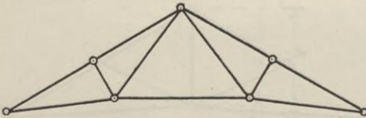
Bei den vorstehend genannten Dächern steigt der Untergurt in der Regel etwas an, etwa  $\frac{1}{10}$  der Dachhöhe. Die Binder erhalten dadurch ein gefälligeres Ansehen.
