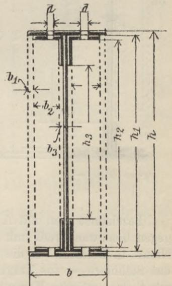
Das Trägheitsmoment des in Fig. 179 gezeichneten Querschnittes ist mit Rücksicht auf die Nietlöcher:
