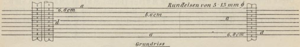
Linie eines an beiden Enden eingespannten Trägers gebogen. Die Stärke der Betonplatte beträgt 6 bis 10 cm, die Trägerentfernung 1,5 bis 6,0 m. Das Eigen-
