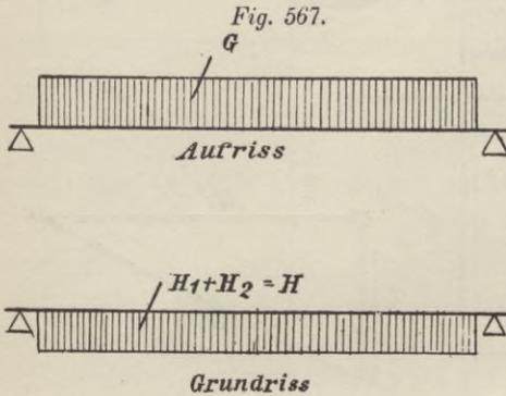
In Verbindung mit der Mauer muss dieser Träger im stande sein, die horizontale Belastung aufzunehmen. Wird die Spannung der äussersten Fasern zu gross, so ist für eine den Umständen entsprechende Verankerung Sorge zu tragen.
