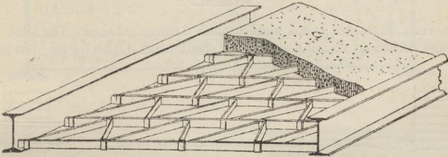
gestellter Flacheisenstäbe  $2\frac{6}{3}$ , Tragstäbe genannt, die durch aus Bandeisen  $2\frac{6}{1/2}$  gebildete Zickzackfedern, mit Hilfe von eisernen Klammern, miteinander verbunden sind. Die Entfernung der Tragstäbe beträgt etwa 15 cm. In dieses Eisengerippe wird nach Unterbringung einer dichten, um 2 cm abstehenden Schalung die 8 cm starke Betonmischung eingestampft. Die Trägerentfernung richtet sich nach der Belastung und kann nachstehender Tabelle entnommen werden.
