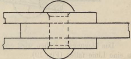
Nach Zerstörung der Nieten würden, mit Rücksicht auf die oben angegebene Möglichkeit 1. der Trennung, die Bleche nach Fig. 15 und 16 übereinander weggleiten.
