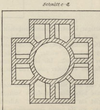
Aus Gründen, die bereits oben bei der Besprechung des Säulenfusses auf Seite 129, sowie der des Kopfes näher erörtert wurden, wird man auch hier dazu gelangen, Fuss und Schaft zu trennen. In den Beispielen 330 bis 333 sind eine
