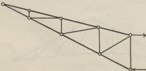
**Belastung.** Was die Belastung der Dachbinder anbelangt, so setzt sich dieselbe zusammen aus der bleibenden und der zufälligen Last. Die erste besteht aus dem Gewicht der Deckung, der Latten, der Sparren und des Binders, die zufällige Last aus dem Winddruck und dem Gewichte des Schnees.
