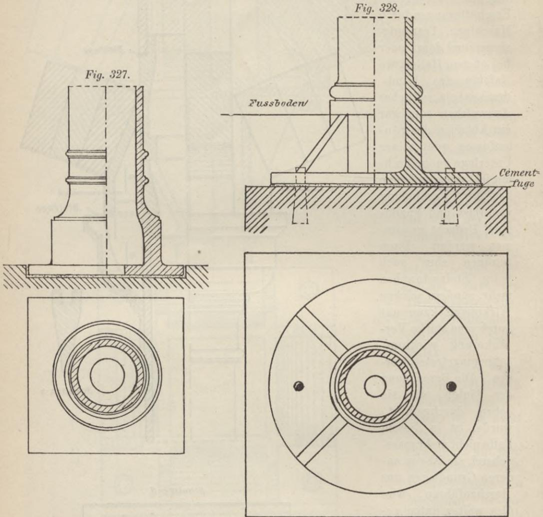
Reihe derartiger Konstruktionen mitgeteilt, die zur Ausführung sehr geeignet sind. In allen Fällen wird der Säulenschaft stumpf auf den Säulenfuß aufgesetzt. Die Berührungsfleichen beider sind alsdann sauber zu bearbeiten oder aber es ist auch hier wieder eine 3 bis 5 mm starke Zwischenlage aus Blei oder Kupfer vorzusehen. Die seitliche Verschiebung wird durch eine 5 bis 10 cm lange Muffe, der entweder einen Teil des Schaftes oder des Fusses bildet, verhindert.
