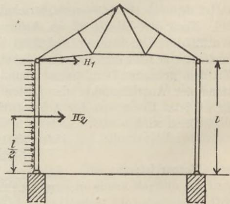
Bei freistehenden Hallendächern genügt es, den auf eine Dachfläche wirkenden Winddruck am oberen Ende der Säule angreifend zu denken (Fig. 366).
