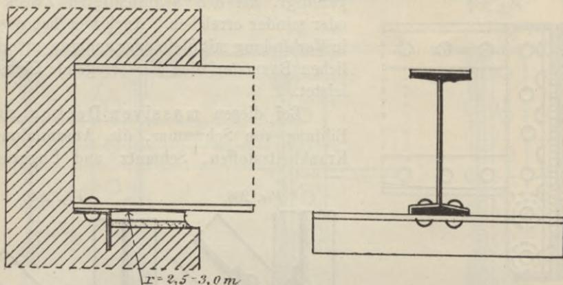
bleiben und der Wirkung des Feuers ausgesetzt sind, kann die Decke dadurch, dass das Eisen in der Glut seine Tragfähigkeit verliert, einstürzen. Solche Decken können daher nur als bedingt feuersicher angesehen werden. Bei jeder Decke unterscheidet man zwei Hauptkonstruktionsteile:
