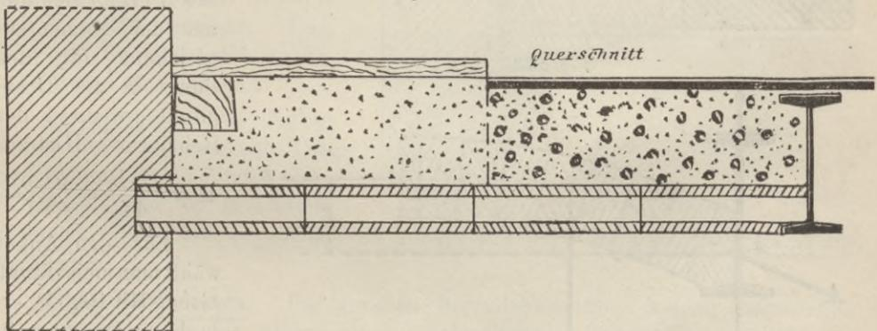
Ein Vorzug dieser Decke ist der, dass sie keinen Seitenschub ausübt, wie dies bei den gewölbten Decken stets der Fall ist.
