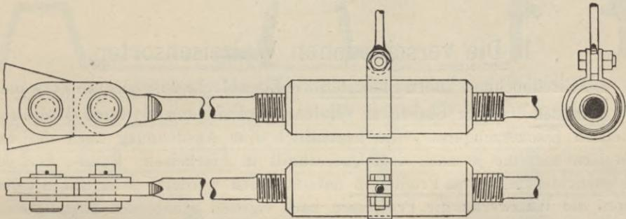
Die Abmessungen, welche das Gelenk erhält, sind dann aber derart, dass man vorzieht, das Rundeisen zu einem Flacheisen auszuschmieden unter Zugrundelegung der Gleichungen 10 bis 13.
