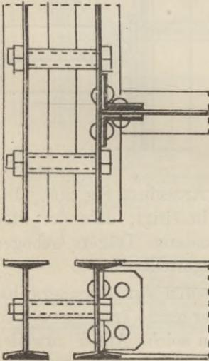
Der Anschluss von  $\perp$ -Eisen an genietete Träger ist aus den Figuren 205 und 206 zu ersehen. In
