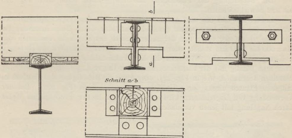
genietet sind. Am besten eignen sich hierzu Winkel 80/120/10 oder 80/160/10. Das seitliche Abrutschen wird durch kleinere an den Unterzug genietete Winkel 60/60/8 verhindert. In Fig. 215 sind die Balkenenden ausserdem durch ein aufgelegtes Flacheisen miteinander verankert; während in Fig. 216 die Verbindung der Balkenenden durch zwei seitliche Flacheisen mit Hilfe zweier Schraubenbolzen geschah. Der Steg der T-Eisen erhält zum Durchstecken der Flacheisen entsprechende Schlitze.
