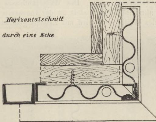
Die Eckständer sind in der Regel Winkeleisen, auf welche die flach geschlagenen Tafelränder genietet oder geschraubt werden. Die Deckung der stets wellig bleibenden Kante geschieht durch ein aufgelegtes Flacheisen (Fig. 479).
