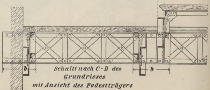
Winkel des Stufendreiecks daran genietet werden können. Die Verbindung der Winkel des Stufendreiecks untereinander geschieht durch kleine Knotenbleche.
