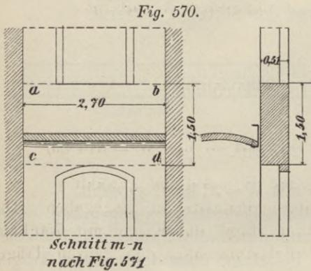
Den Teil a, b, c, d der Frontmauer (Fig. 570) betrachte man als einen zwischen den seitlichen Treppenhausewänden eingespannten Träger. Das grösste Moment bei einem gleichmässig belasteten, beiderseits eingespannten Träger (Fig. 271) ist nun:
