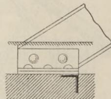
Wie man das Lager auch anordnen möge, stets ist dasselbe mit Zement zu untergiessen, damit der Druck ganz gleichmässig auf das Mauerwerk übertragen wird. Die Zementschicht erhält dabei eine Dicke von 1,0 cm.
