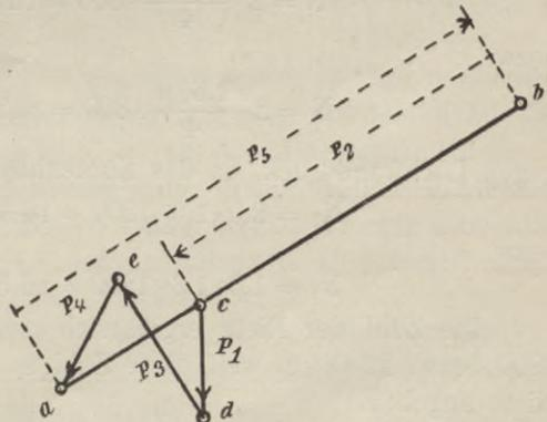
Hieraus ergibt sich, dass es äusserst vorteilhaft ist, wenn man die Stäbe der Gurtungen an den Knotenpunkten durchlaufen lässt, da man alsdann die Gurtstäbe am Knotenpunkt nur mit derjenigen Nietzahl an das Knotenblech anzuschliessen hat, die der Differenz ihrer Spannungen entspricht.
