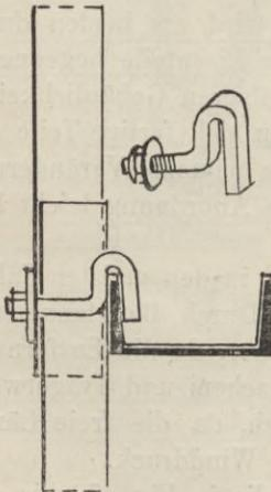
Der Stoss in der Längsnaht geschieht durch Ueberdeckung einer halben Welle. Die Fuge muss dabei von der Wetterseite abgekehrt sein. Der Abstand der Niete in der Längsnaht wird etwa zwischen 300 bis 500 mm angenommen (Fig. 474).
