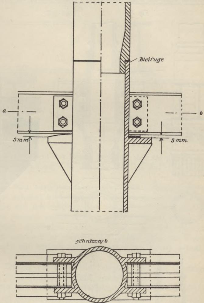
Namentlich in Fabrikgebäuden, in Speichern und Warenhäusern, wo durch einseitige Belastung oder durch horizontale Kräfte, wie z. B. die Riemenspannung bei Transmissionen die Säulen sowohl auf Druck wie auf Biegung beansprucht werden, sind die schmiedeeisernen Säulen allein am Platze.
