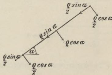
Die Komponente  $Q \cdot \sin \alpha$  erzeugt im oberen Teile des Trägers Zugspannungen, im unteren Teile Druckspannungen, deren Grösse als unwesentlich vernachlässigt werden kann.
