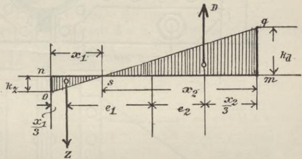
Nach Fig. 377 ist die Breite der Fussplatte auf 35 cm festgesetzt bei Anordnung von 4 Rippen.
