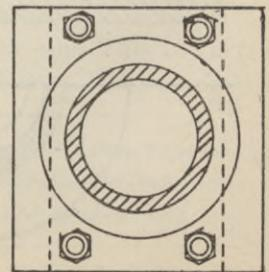
Zur zentrischen Druckübertragung vorzüglich geeignet sind die mit Kugelenk ausgestatteten Säulenfüsse (Fig. 334 und 335). Die Fussplatte wurde hier mit Kreuzrippen versehen, welche in entsprechende Vertiefungen des Auflagersteines eingreifen und dadurch die seitliche Verschiebung unmöglich machen.
