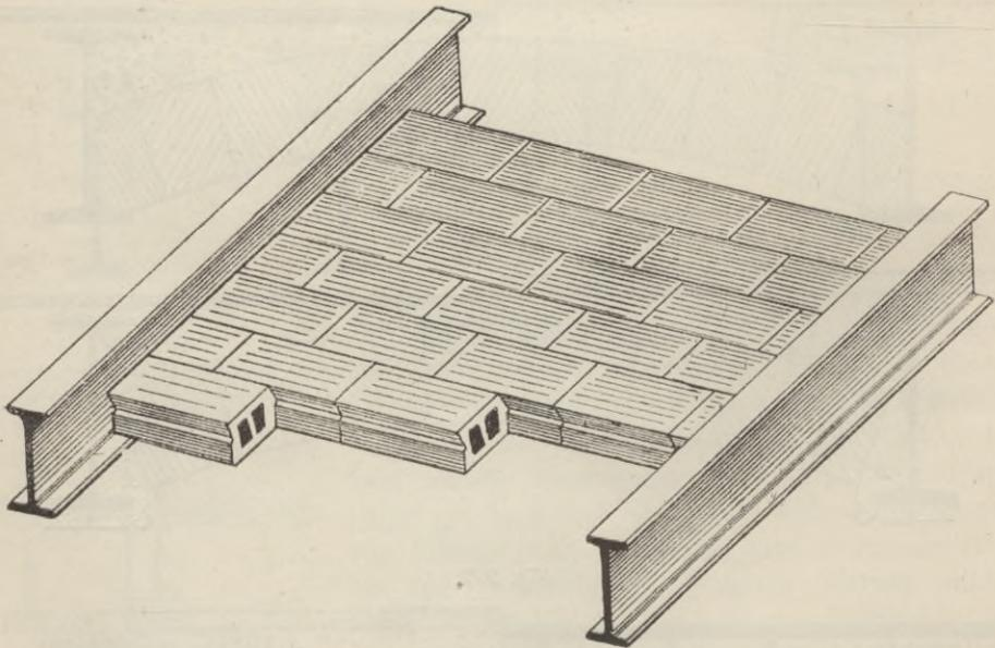
Die Steine werden als poröse gebrannte Lochsteine hergestellt und haben eine Länge von 25 cm, eine Breite von 13 cm und eine Stärke von 10 bis 13 cm. Die 10 cm starken Steine werden angewandt bei Spannweiten bis zu 1,70 m und 13 cm starke Steine bis zu 3 m.
