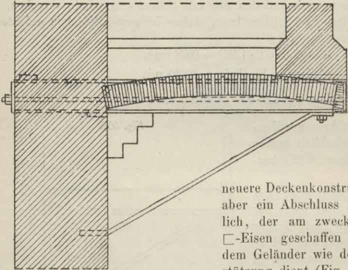
Um die freie Länge des Trägers zu verkürzen, werden häufig unter demselben mehrere Steinschichten ausgekragt (Fig. 511).
