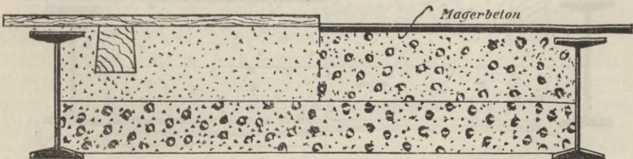
masse (Kies oder Kleinschlagbeton) feststampft und hierauf als Auffüllung einen leichteren Beton (Schlackenbeton) oder andere geeignete Materialien aufbringt; in den letzteren liegen die durch Keile genau ausgerichteten Lagerhölzer für den Holzfußboden (Fig. 235). Die Trägerentfernung wird nie über 1 m angeordnet.
