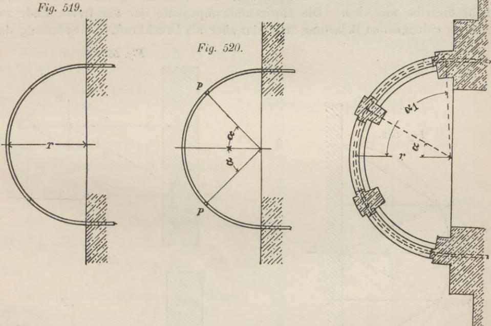
Beispiel. Ein nach einem Radius von 1,4 m gekrümmter Balkonträger erhalte von den Brüstungswänden 250 kg pro laufende Meter, durch die Balkonplatte von zwei Trägern je 480 kg. Nach Fall 4 und Fig. 522 wird alsdann:
