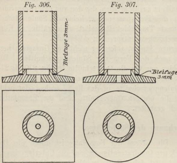
AB wie CD abgetrennten Teile der Fussplatte als längs dieser Linien eingespannte und von unten mit  $k$  kg/qcm gleichmässig belastete Träger. Als dann folgt aus der Biegungsgleichung mit Beziehung auf die dort gewählte Bezeichnung für den rechteckigen Streifen, mit Rücksicht auf die für Guss-eisen zulässige Biegungsanstrengung
