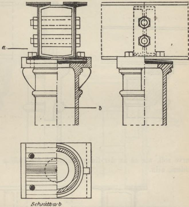
starker Blei- oder Kupferring eingeschaltet. Die Länge der in den Säulenschaft eingreifenden Muffe des Kopfes genügt mit 50 bis 100 mm. Die Uebergangs-
