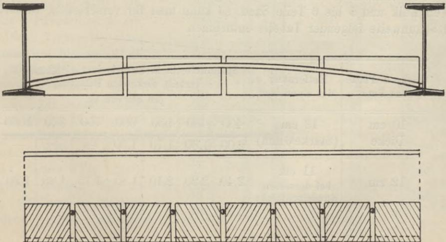
(Spanneisen) von 6 mm Durchmesser, die wie bei der Kleineschen Decke in jeder Fuge in Mörtel eingebettet werden (Fig. 247). Auch bei dieser Decke können die Steine sowohl hoch- wie flachliegend vermauert werden. Durch die Anordnung der Spanneisen findet ein Aufhängen der Platte an den Eisenbögen statt. In den Endfeldern hat man daher für die Aufhebung des von den Eisenbögen ausgeübten Seitenschubes zu sorgen. Soll die Decke absolut feuersicher
