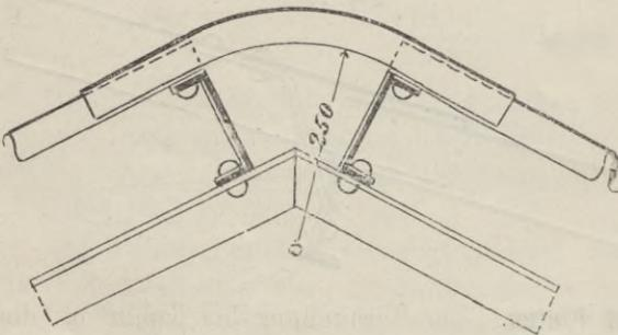
benutzten Profiles (Fig. 755). Die Längenausdehnung wird dadurch ermöglicht, dass die Nietlöcher im unteren Wellblech länglich angeordnet werden. Fig. 756 zeigt eine Firstkappe aus flachem Blech. Die Wellblechtafeln werden durch ein
