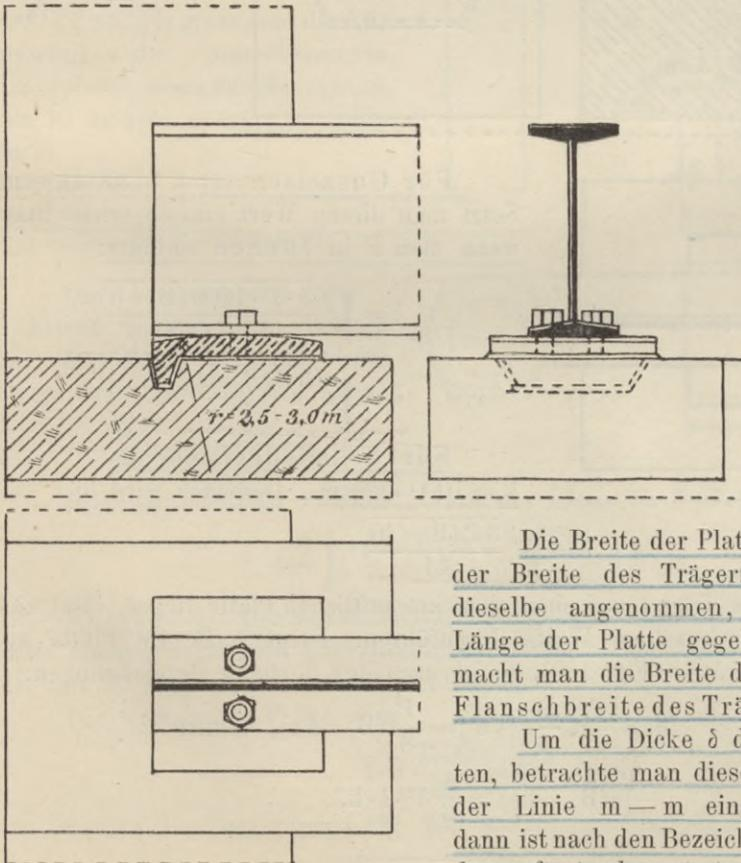
Die Breite der Platte richtet sich nach der Breite des Trägerflansches; hat man dieselbe angenommen, so ist damit die Länge der Platte gegeben. Zweckmässig macht man die Breite der Platte gleich der Flanschbreite des Trägers + 5 bis 10cm.
