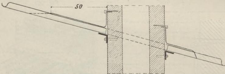
lässt man das Wellblech (Fig. 771) bis an den Schornstein gehen, wo es auf einen an diesem befestigten Winkel gelagert wird. Das als Zungenblech ausgebildete Dichtungsblech, das oben rechtwinkelig umgekanet und in einer Mauerfuge befestigt ist, wird auf dem Wellblech parallel der Dachfläche umgebogen und legt sich mit seinen Zungen in die Wellenthäler. Durch eine allseitige sorgfältige Verlötung wird eine gute Dichtung erzielt.
