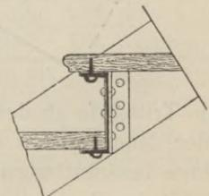
Einfache Treppen mit Holztritten veranschaulichen die Fig. 617, 618, 619. In Fig. 617 sind keine Setzstufen angeordnet, es ist daher ratsam, die beiden
