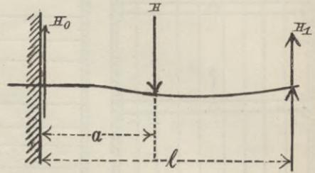
Um den Einfluss der Kraft H kennen zu lernen, betrachte man die Säule als einen Träger, der an einem Ende fest eingespannt ist und am anderen Ende frei aufliegt (Fig. 371).
