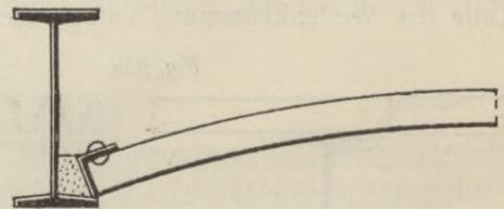
kleiner Winkel vernietet, der sich gegen eine Zementausfüllung stützt, während in Fig. 262 ein Gussstück als Widerlager für das Wellblech dient. Angegossene, dem Trägerflansch angepasste Rippen, deren Entfernung 30 bis 40 cm betragen kann, geben dem Gussstücke die nötige Steifigkeit.
