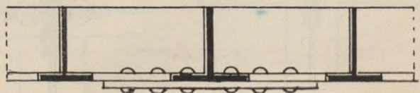
Fachwerken (Fig. 141). Durch den der Dicke des Knotenbleches entsprechenden Schlitz geht dann das Flacheisen, welches durch einen Niet mit den Winkeln verbunden wird. Winkeleisen wie Flacheisen erhalten aber meist längliche Löcher, um die Ausdehnung der Stäbe ungehindert zu gestatten.
