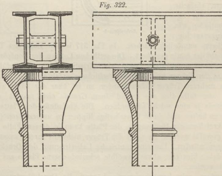
Der Kopf der Säule in Fig. 322 muss wegen seiner Ausbauchung durch innere Rippen abgesteift werden, welche den Druck auf den Schaft übertragen sollen. Da die Trägerflansche hier nicht in ihrer ganzen Breite aufliegen, so wird besser eine schmiedeeiserne konvex gestaltete Zwischenplatte von 15 mm Stärke eingeschoben, wie dies auch in Fig. 319 angedeutet ist.
