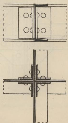
Laufen beide  $\perp$ -Eisen durch, wie dies vielfach bei Sprossen geschieht, so erreicht man eine zweckmässige Verbindung dadurch, dass man bei dem einen Eisen die Flansche, bei dem anderen den Steg ausklinkt und nun die Eisen ineinander schiebt (Fig. 144).
