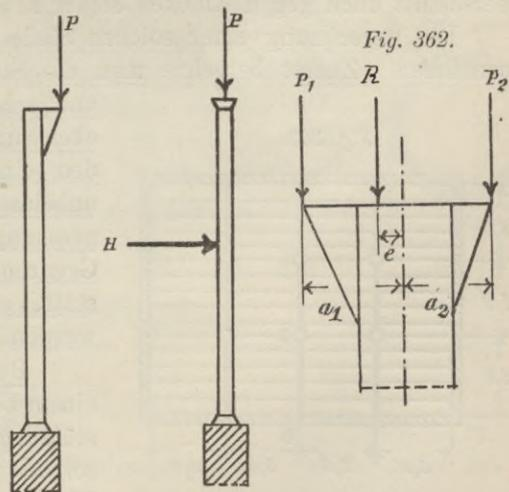
gewichtszustande nichts geändert worden. Es ergibt sich aber sofort, dass die Säule von der im Schwerpunkte des Querschnittes nach unten gerichteten Kraft  $R$  auf Druck beansprucht wird. Die beiden anderen Kräfte dagegen bilden ein Kräftepaar, dessen Moment  $M = R \cdot e$  im Säulenquerschnitte Biegungsspannungen hervorruft.
