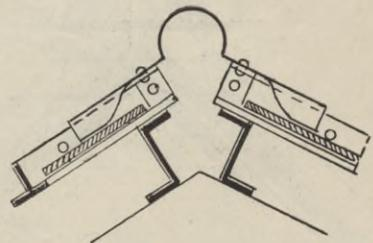
Eine andere Anordnung zeigt Fig. 790. Hier sind die Rinnensprossen oben durch kleine Winkelstücke geschlossen und die Dichtung durch ein  $\perp$  ge-
