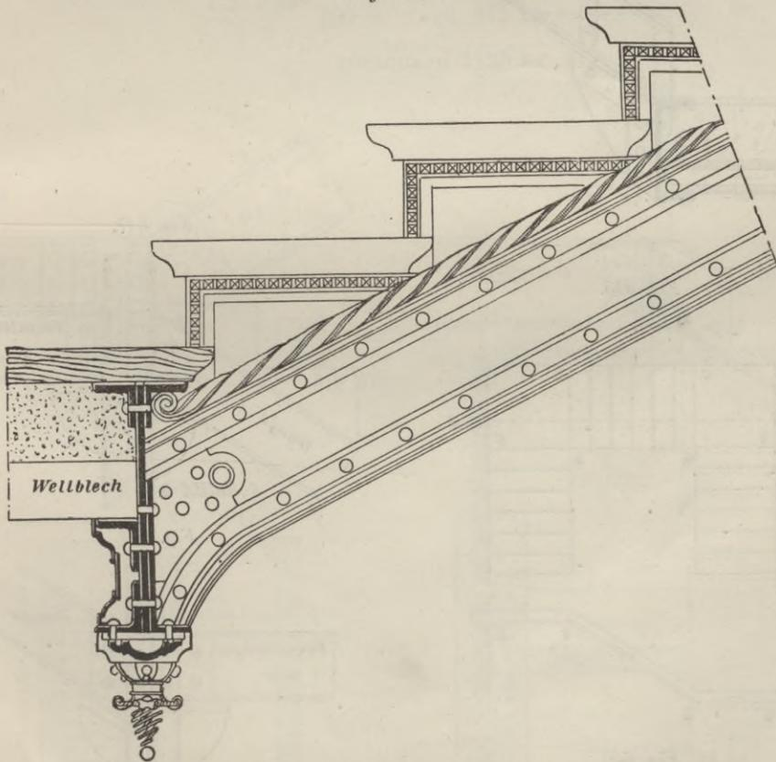
Fig. 632d und e zeigen die Verbindung der als Fachwerkträger ausgebildeten Wangen mit einem Fachwerk-Podestträger. Der Anschluss der Wangen geschieht daselbst an ein Blech von der Breite  $b$  mit Hilfe von Winkeleisen. Die Befestigung der Fachwerkwang an ein  $\square$ -Eisen, welches als Podestträger dient, ist in Fig. -632 dargestellt.
