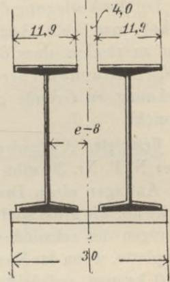
Mit dem Träger durch Feststelldorne verbunden ist das obere Sattelstück. Die Verbindung beider durch Schrauben, wie sie öfter ausgeführt wird, ist nicht gerechtfertigt, da ein Abheben des mehr oder weniger schwer belasteten Trägers nicht eintreten kann.
