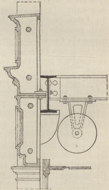
unterhalb des Fussbodens ein stumpfer Stoss der Säulen ausgeführt und die Unverschieblichkeit beider durch Flanschenverschraubung gesichert. Die T-Träger ruhen dann entweder auf Konsolen, oder aber jene werden mit Hilfe von angegossenen Laschen mit der Säule verschraubt. Fig. 385 zeigt ein derartiges Beispiel.
