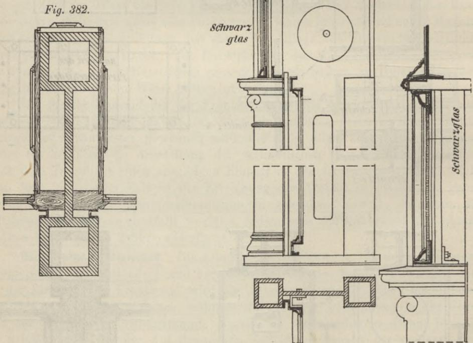
Verkleidung zu verstecken. Auch kann als Verkleidung das aus Schwarzglas bestehende Firmenschild mit Vorteil verwandt werden, das sich mit Hilfe Mannstädtscher Zierrisen in geeigneter Weise anbringen lässt. Die Figuren 379a und b zeigen diese Anordnung.
