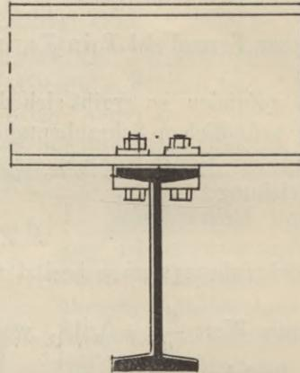
2. wenn Teile miteinander verbunden werden, bei denen schwere Hammerschläge vermieden werden müssen, also wenn es sich darum handelt, gusseiserne Bauteile zu befestigen, 3. wenn eine Zugbeanspruchung des Bolzens stattfindet, wie dies immer bei Zugstangen und Ankern der Fall ist, 4. wenn das Nieten wegen beschränkter Oertlichkeit unmöglich ist und endlich 5. wenn eine gewisse Nachstellbarkeit und Beweglichkeit der Verbindung gefordert wird.
