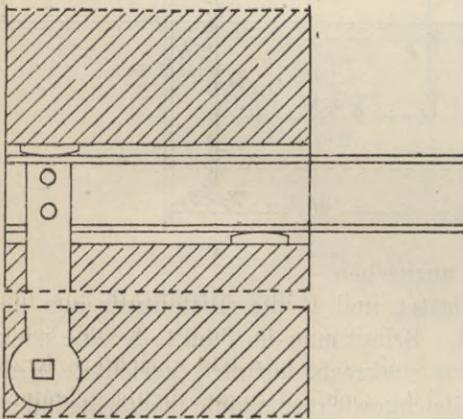
Reicht der über dem Lager liegende Mauerkörper dazu nicht aus, so muss zu einer Verankerung des unteren Mauerwerks geschritten werden, wie dies in Fig. 150 angedeutet ist. Die Länge des Ankers ist dabei so zu bemessen, dass das Gewicht des angehängten Mauerwerks den fehlenden Beitrag an dem Gesamtgewicht liefert.
