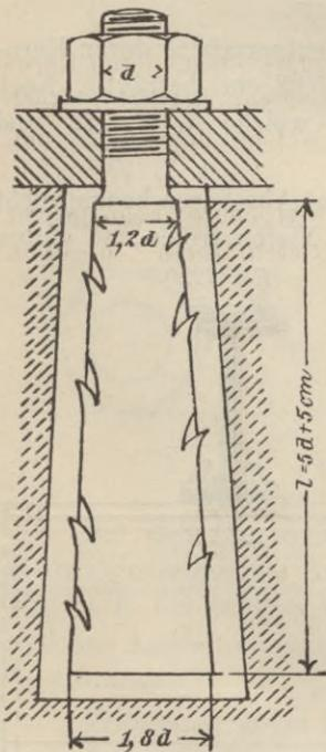
**Besondere Formen der Schrauben.** Ausser der bisher besprochenen Mutterschraube finden im Hochbau noch die in den Fig. 43 bis 53 dargestellten Schrauben häufiger Anwendung.
