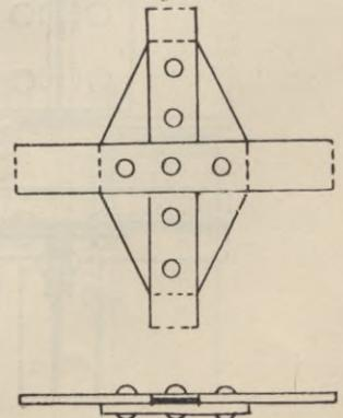
sprochenen Endanschlüsse ergeben. Die Kreuzung der Flacheisen in Fig. 139 ist durch Anwendung zweier Flacheisenlaschen erfolgt. Die in Fig. 140 gezeichnete Kreuzung zweier Doppel-Flacheisen ist durch ein zwischen denselben liegendes Knotenblech bewirkt worden.
