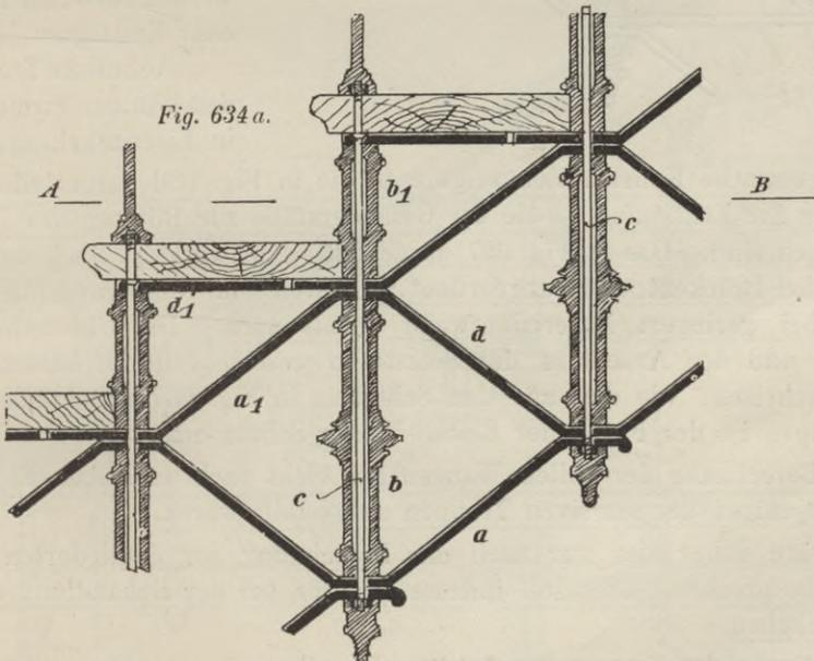
Hierher gehören auch die dem Eisenwerke Joly in Wittenberg patentierten Treppen (Fig. 634, 635). Die Gurtungen sind aus parallelen Flacheisen  $a$  und  $a_1$ ,
