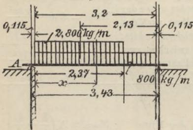
moment besitzen muss von  $\frac{934,2}{2} = 467,1 \text{ cm}^3$ . Dem entsprechen aber 2  $\bar{\text{T}}$ -Eisen N. P. Nr. 26 mit je  $W = 441 \text{ cm}^3$ .
