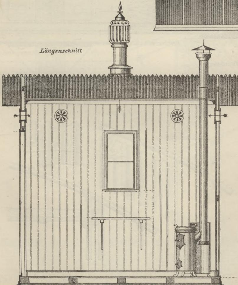
Holzbekleidung genagelt wird. Das Wellblech hat unten kleine Löcher, durch welche ein Luftstrom eintritt, der durch den Luftsauger auf dem Dach abgeführt wird.
