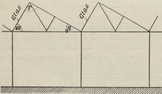
Die steileren gegen die Horizontale unter  $60^\circ$  bis  $90^\circ$  geneigten Dachflächen werden verglast, während die flacheren unter  $20^\circ$  bis  $30^\circ$  gegen die Horizontale geneigten Flächen mit einem anderen Material abgedeckt werden. Der Firstwinkel soll nicht kleiner als  $70^\circ$  sein. Bei diesen Dächern wird die verglaste Seite des ruhigen Lichtes wegen meist nach Norden gelegt.
