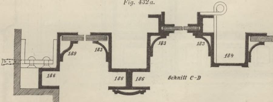
Das in den Konstruktionen 412 und 413 benutzte Fussprofil (Fig. 406) besitzt kreisrunde Oeffnungen, deren Abstand rund 50 mm und deren Durchmesser rund
