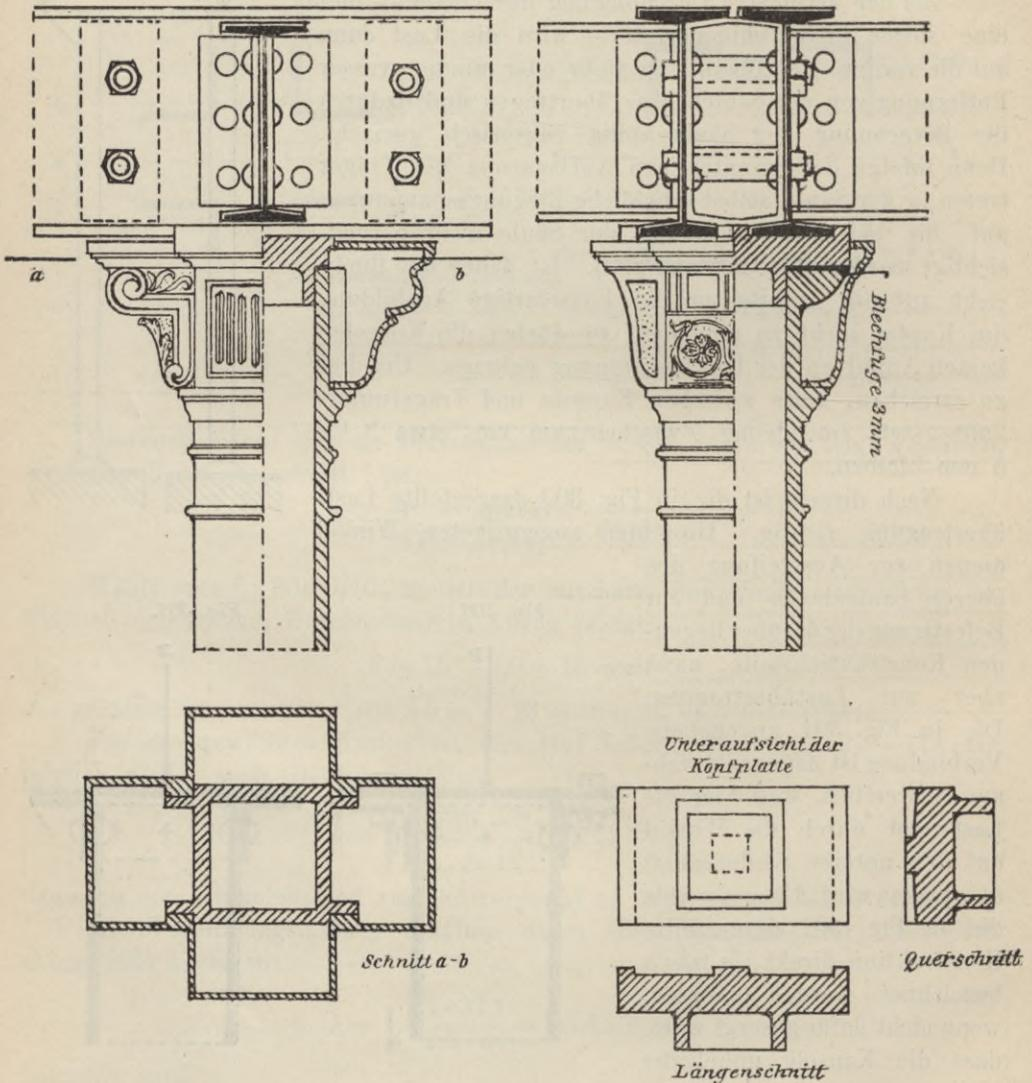
Die Fussplatte besteht entweder mit der Säule aus einem Stück oder aber, was bei weitem vorzuziehen ist, sie wird für sich hergestellt. Das letztere sollte schon aus dem Grunde immer geschehen, weil die Aufstellung der Säulen hierdurch wesentlich erleichtert wird. Bei gusseisernen Säulen, die grosse Drücke aufzunehmen haben, ist es übrigens aus anderen konstruktiven Gründen, die
