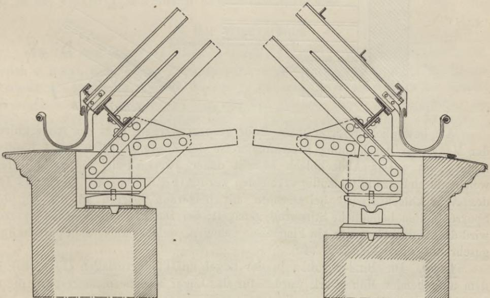
ausreichend. Hierauf lässt sich das Lager selbst einzeichnen und zwar so, dass der Angriffspunkt des Auflagerdruckes senkrecht unter dem theoretischen Knotenpunkt liegt. In Fig. 738 ist ein Fusspunkt mit dem festen Lager, in Fig. 739 a
