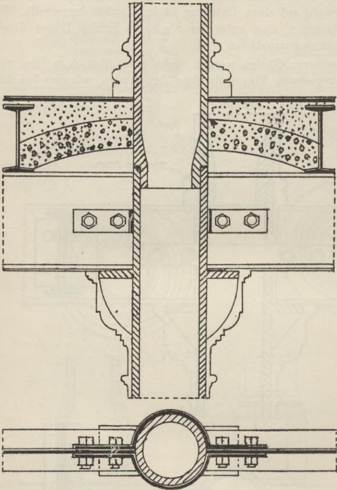
Der gleichmässigen Druckübertragung wegen sind die Stossflächen entweder wieder sauber zu bearbeiten oder aber es ist wieder eine Zwischenlage aus Blei oder Kupfer anzuordnen.
