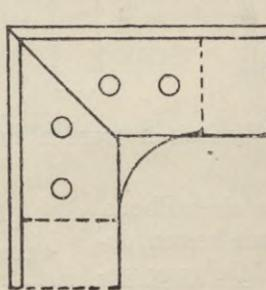
jedoch darauf zu achten, dass die Auflagerfläche für das Glas nicht uneben wird. Die Nietköpfe müssen demnach versenkt werden. In Fig. 108 und 109 sind mehrere Ecken dargestellt. Die Bildung geschah unter Zuhilfenahme von Knotenblechen und Winkellasche.
