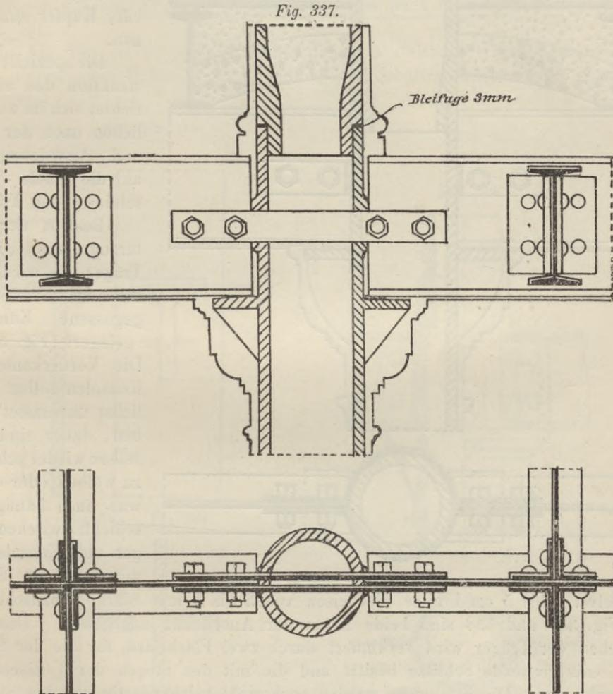
modernen Kaufhäusern, Warenlagern, Speichern u. s. w. der Fall ist, so werden Säulenstösse erforderlich. Der Stoss wird stets an einer Stelle angeordnet, wo die Säule durch anschliessende Träger oder andere Konstruktionsteile gegen seitliches Ausbiegen gehindert ist.
