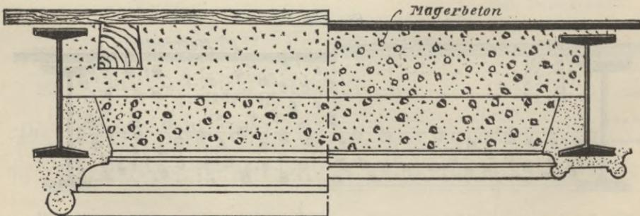
Durch Ausfüllung der Gefache in der vollen Trägerhöhe werden die Decken sehr schwer. Eine leichtere Decke zeigt Fig. 236. Durch Umhüllung der Trägerflansche mit Beton oder Zementmörtel werden diese Decken absolut feuersicher.
