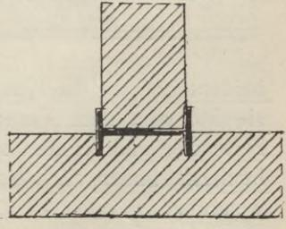
**Streben und Bänder.** Die Streben erhalten in der Regel einen L- oder T-Eisenquerschnitt und werden mit den Schwellen, Rahmen und Pfosten durch Winkellaschen verbunden (Fig. 468).
