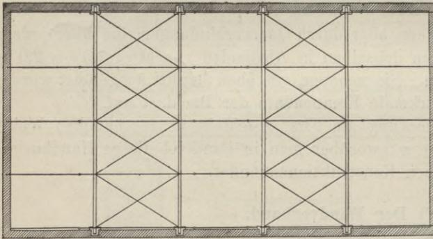
Die Achse der Diagonalen muss im Grundrisse durch die theoretischen Knotenpunkte gehen.
