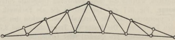
4. Der französische oder Polonceau-Binder ist eine Kombination mehrerer Hängewerke. Fig. 689 zeigt den einfachen, Fig. 690 den doppelten Polonceau-Binder. Er ist für alle Spannweiten geeignet und wird sehr häufig ausgeführt.
