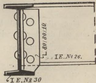
Winkelecke, dass der Nietkopf mit seinem Rande 3 bis 5 mm von der inneren Abrundung des Winkels bleibt (Fig. 35). Die Entfernung der Niete untereinander wird dabei  $e = 3 - 4d$  gemacht.
