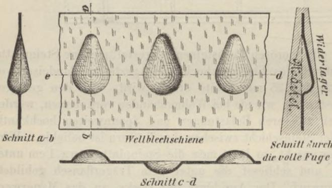
Höhe, die in Abständen von etwa 33 cm auf den Unterflansch der Deckenträger verlegt werden, schwach gekrümmte Kappen aus Schwemmsteinen oder porösen Lochsteinen hergestellt werden (Fig. 244 bis 246). Bei gering belasteten Decken genügt es, die Steine flachkantig ein-
