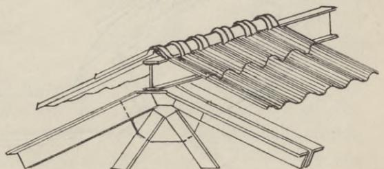
Bei nur einer Firstpfette benutzt man am besten geknickte Firstbleche, wie sie unter anderen von der Firma Hilgers in Rheinbrohl hergestellt werden (Fig. 761).
