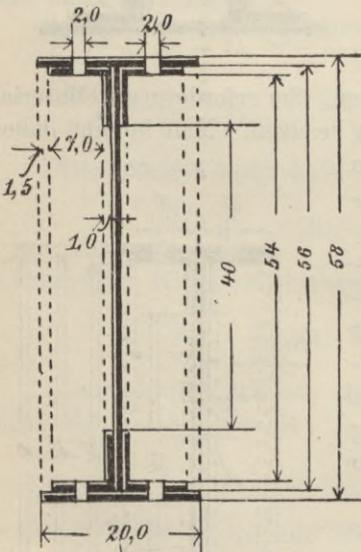
Ist der passende Querschnitt gefunden, so ist die Entfernung der Niete in den Gurtwinkeln zu berechnen.
