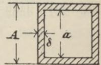
Bei den zusammengesetzten Querschnitten in Fig. 266 bis 269 bestimmt man den auf jede Säule enthaltenden Teil der Belastung und berechnet dann das Trägheitsmoment für jeden Teil des Querschnittes besonders, ohne auf den Steg Rücksicht zu nehmen.
