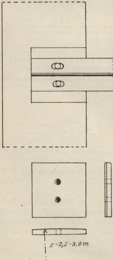
**Ausdehnung der Träger.** Ist  $l$  die Länge des Trägers in m,  $\alpha$  der Ausdehnungskoeffizient des Eisens für 1° C., so wäre die Längenänderung  $\lambda$  für einen Temperaturunterschied von 800°:
