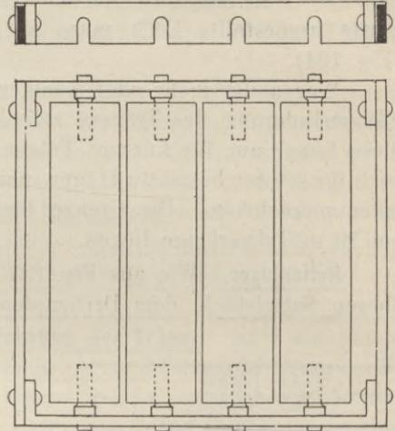
grosse Drucke wird man, um nicht zu viele Rollen zu erhalten, diese aus Stahl anfertigen lassen, für mittlere und kleine Drucke genügen schmiedeeiserne oder gusseiserne Rollen.
