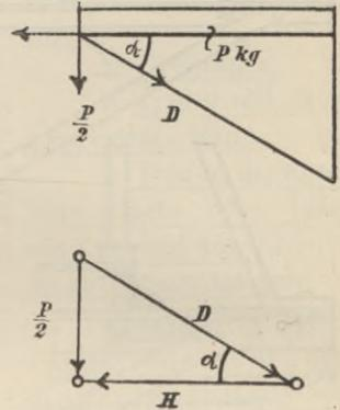
Beispiel. Eine 1,0 m ausladende Gallerie ist alle 0,8 m durch eine schmiedeeiserne Konsole unterstützt. Die Abdeckung besteht aus Riffelblech von 6 mm Stärke und rd 40 kg Gewicht pro Quadratmeter. Die Nutzlast beträgt 200 kg pro Quadratmeter.
