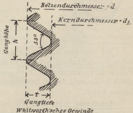
Das Gangprofil der scharfgängigen Schraube, wie es vom Verein deutscher Ingenieure angenommen worden ist, zeigt Fig. 39, während Fig. 40 das Gangprofil der noch viel im Gebrauch befindlichen Whitworth'schen Schraube darstellt.
