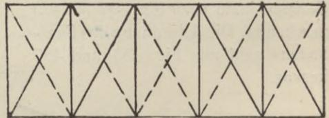
Er besteht aus: 1. Vertikalen, welche die hintereinander stehenden Stiele der vorderen und hinteren Fachwerkwand an ihrem oberen Ende miteinander verbinden und die, da sie Druckspannung erhalten, steif, also aus  $\lfloor$ -,  $\lrcorner$ - oder  $\sqcap$ -Eisen konstruiert werden; 2. aus Diagonalen, die in den entstehenden rechteckigen Feldern kreuzweise angeordnet werden. Sie nehmen Zugspannung auf und werden daher als Flacheisen angeordnet.
