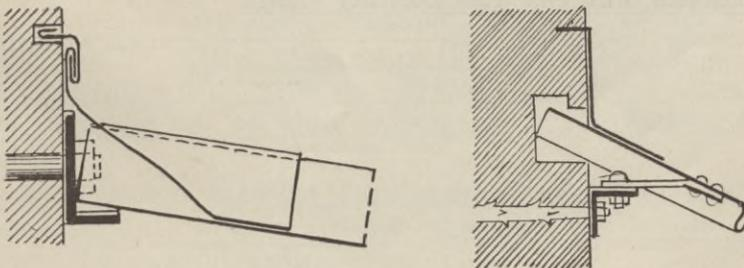
Als Anschluss des Wellbleches an Mauern, die senkrecht zur Wellenrichtung laufen, verwendet man zweckmässig die von der Firma Hilgers hergestellten Mauerfirstbleche (Fig. 767). Einen anderen Anschluss zeigt Fig. 768, bei welchem das Pressblech zweckmässige Verwendung gefunden hat. Die Verbindung des Winkeleisens mit der Mauer erfolgt durch Steinschrauben, die etwa alle 80 bis
