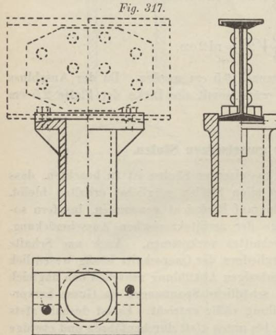
ersichtlich, ist die Kopfplatte nach der Längsrichtung schwach gewölbt, so dass der Träger genau über der Säulenachse sein Auflager findet. Es reicht völlig aus, wenn der Radius der Abrundung mit 2,50 bis 3,0 m bemessen wird.
