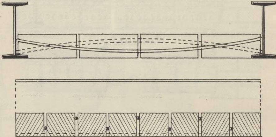
hergestellt werden, so werden statt der Spanneisen, nach unten gebogene Rund-eisen (Hangeisen) eingelegt (Fig. 248) und die Unterkante der Decke tiefer als die Trägerunterkante angeordnet.
