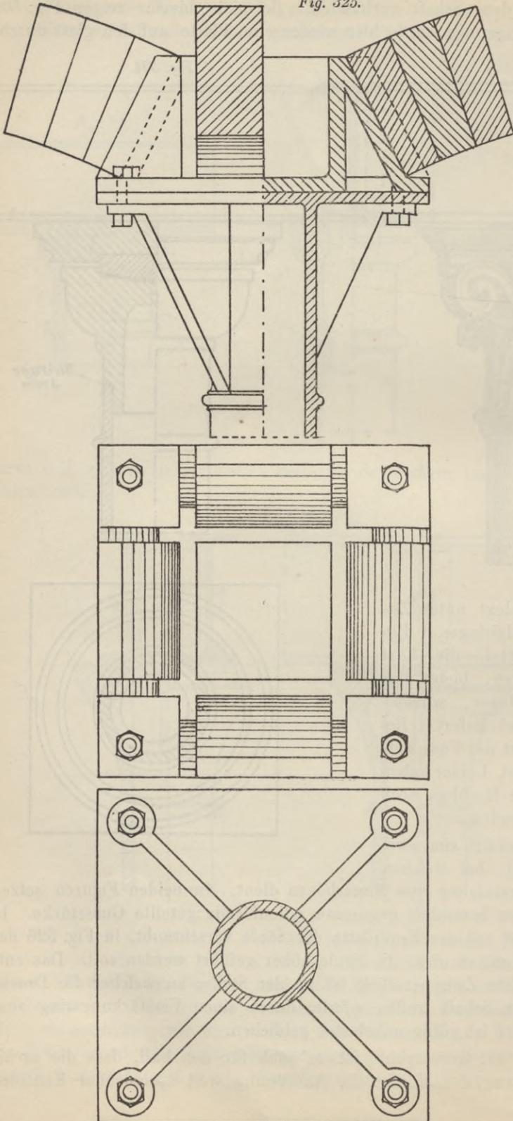
erheischt, immer möglichst, das Kapitäl als besonderen Bestandteil am Säulenschaft anzubringen. Zu diesem Zwecke ist hier der Schaft mit schmalen angegossenen Leisten versehen worden, welche den Konsolen zur sicheren Befestigung dienen.
