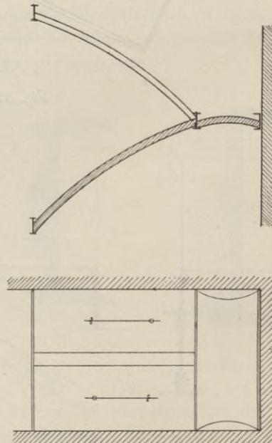
in Bezug auf Tragfähigkeit und gutes Aussehen den Vorzug verdienen. Der Schub, den die flachen Bögen, die mit einem Pfeil von  $\frac{1}{12}$  bis  $\frac{1}{20}$  der Spann-
