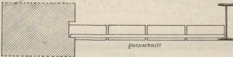
Ermöglicht wurde die Ausführung dieser Idee dadurch, dass die in Betracht kommenden Materialien, Eisen- und Zementmörtel, einen nahezu gleichen Aus-
