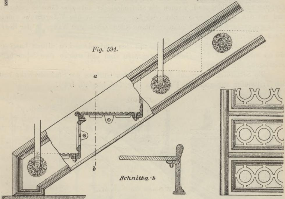
**Stufen zwischen den Wangen.** Werden schmiedeeiserne Wangen benutzt, so ruhen die Trittstufen auf kleinen angenieteten Winkeln, mit denen sie durch Schrauben verbunden sind. Auch die Setzstufen können sich gegen solche lehnen.
