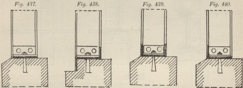
mauerung besteht, so ergibt sich für die Höhe der Profile das Maass von 140 mm, so dass die Flansche der  $\square$ - und  $\Gamma$ -Eisen die Ausmauerung umfassen.
