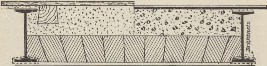
**Förster'sche Decke.** Eine bemerkenswerte Decke dieser Art ist die Förster'sche Decke (Fig. 229 bis 231). Sie besteht aus besonders geformten Steinen, welche in der oberen und unteren Hälfte entgegengesetzte Widerlager aufweisen.
