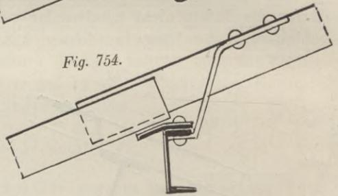
Bei den Wellblechdächern sind die Pfetten meist rechtwinkelig zur Dachfläche angeordnet, um dem Wellblech eine gute Auflagerfläche zu bieten. Will man die Pfetten senkrecht stellen, so kann man die Auflagerflächen dadurch schaffen, dass man auf den oberen Flansch des  $\square$ - oder  $\Gamma$ -Eisens ein Blech von
