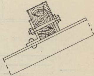
Die Verbindung von Pfette und Binder wird dadurch allerdings einfacher, indessen muss bei der Berechnung der Pfetten hierauf Rücksicht genommen werden. Der Schwerpunkt des Pfettenprofils soll stets senkrecht über dem theoretischen Knotenpunkt des Binders liegen.
