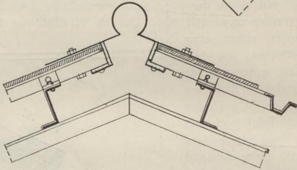
**Anordnung bei einer Firstpfette.** Ist nur eine Firstpfette vorhanden, so kann die Bildung des Firstes nach Fig. 791 bis 794 erfolgen. In Fig. 791 dient ein  $\perp$ -Eisen als Pfette, dessen Flansche in die Dachebene gebogen sind. Auf diesen
