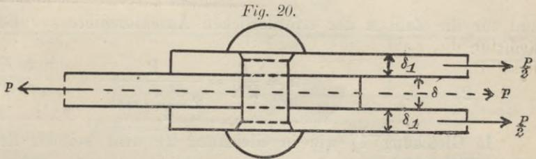
die in den äusseren Stücken wirkenden Kräfte, so ist die Mittelkraft aus den beiden letzteren gleich und entgegengesetzt P und diese hebt sich in der Mittelachse mit der Spannung P auf. Es tritt somit kein biegendes Moment auf; die Nietquerschnitte werden demnach nur auf Abscheren angestrengt.
