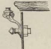
Wird die Handleiste aus Eisen hergestellt, so wird vielfach das in Fig. 71 dargestellte Normalprofil benutzt. Die Firma Mannstädt & Komp. hat für
