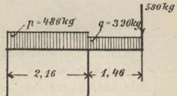
Der Einfachheit halber wird der Träger über seine ganze Länge von Auflager zu Auflager gleichmässig belastet angenommen.
