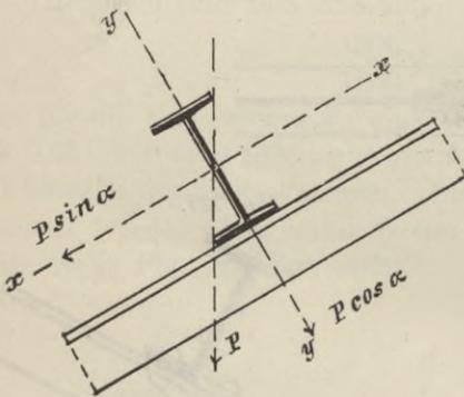
Es sei  $P$  die Last, welche eine Pfette aufnimmt. Diese zerlegt sich dann nach Fig. 730 in eine Komponente  $P \cos \alpha$  in der Richtung der  $y-y$  Achse, und in eine zweite Komponente  $P \sin \alpha$  in der Richtung der  $x-x$  Achse, wobei  $\alpha$  den Neigungswinkel der Dachfläche mit der Horizontalebene bezeichnet.
