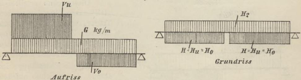
kappe.  $H$  und  $H_1$  sind entgegengesetzt gerichtet, es kommt also nur ihre Resultierende  $H_2 = H - H_1$  zur Wirkung. Da  $H$  wohl meist grösser ist als  $H_1$ , so ist  $H_2$  nach der dem Podestträger parallelen Treppenwand gerichtet. In Fig. 566 ist die Belastung des vorderen Podestträgers dargestellt.
