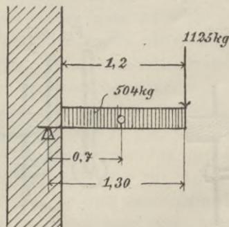
Nimmt man die Einspannstelle 0,1 m hinter der Kante des aufgehenden Mauerwerks an, so folgt aus Gleichung 30 und Fall 3, Seite 54:
