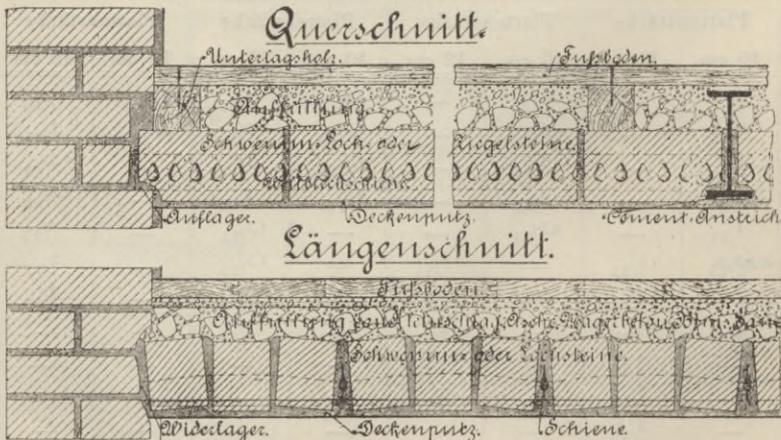
verteilte Lasten von 4500 kg pro Quadratmeter lassen keine wahrnehmbaren Ausweichungen erkennen. Auf ein Quadratmeter Decke gebraucht man an
