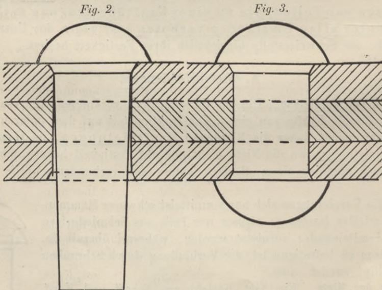
**Länge der Niete.** Die Länge des Schaftes ist so zu bemessen, dass aus ihm der Niet tadellos geschellt werden kann. Bei zu kurzem Nietschaft wird der Schliesskopf sich nur unvollständig bilden, bei zu langem Schaftes wird am Schliesskopf überflüssiges Material, ein sogenannter Bart, stehen bleiben. Beides darf bei guten Vernietungen natürlich nicht vorkommen. Der erste Mangel beeinträchtigt die Tragfähigkeit, der letztere das gute Aussehen der Vernietung.
