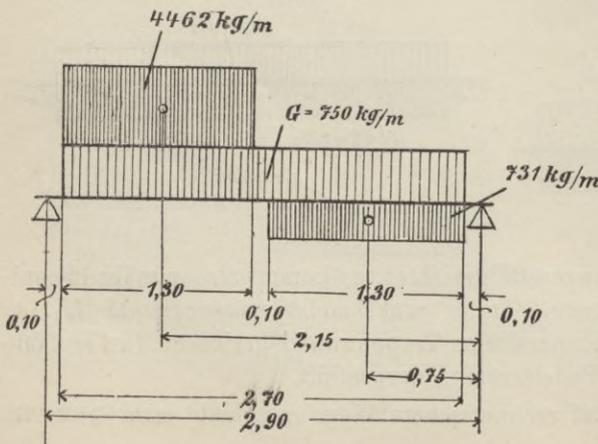
Dieser Schub verteilt sich gleichmässig über den ganzen Träger, wenn man von dem kleinen Zwischenraum von 0,10 m, der sich zwischen den Treppenbögen befindet, absieht.
