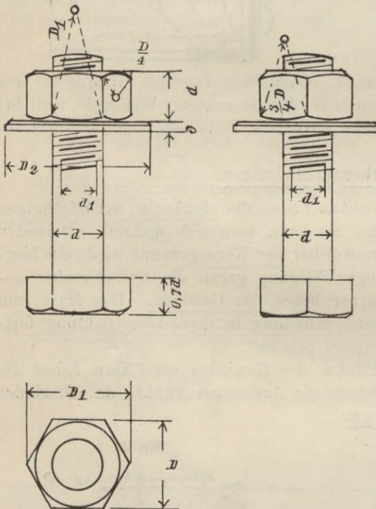
**Schraubenkopf.** Der Schraubenkopf ist entweder vier- oder sechseckig, seine Höhe  $= 0,7 d$ . Die übrigen Abmessungen des sechseckigen Kopfes sind sonst dieselben wie bei der Mutter.
