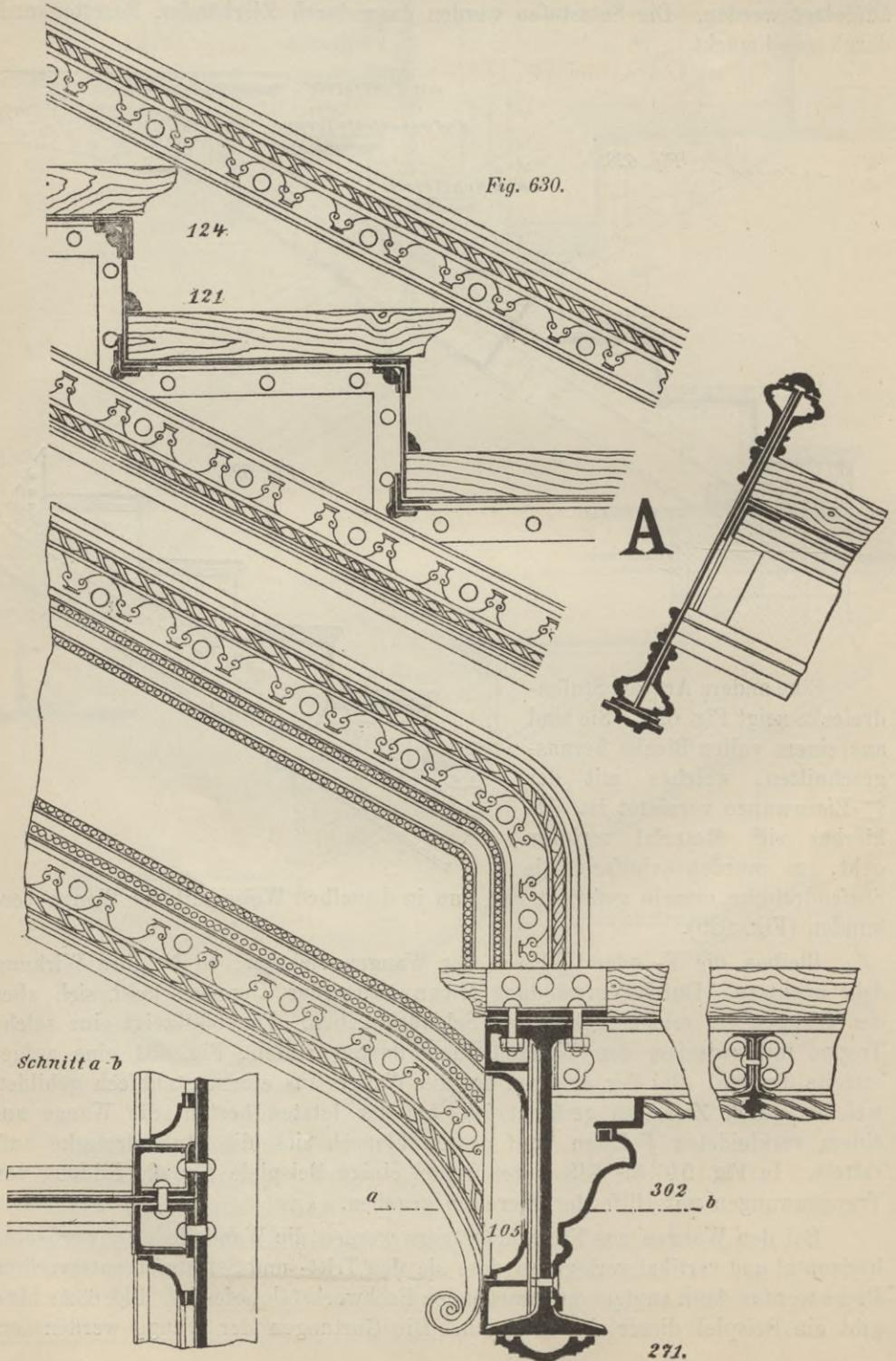
die Trittstufe bilden können. Die vertikalen Fachwerkstäbe sind aus Flacheisen hergestellt und über die Gurtung hinaus so weit verlängert, dass die vertikalen
