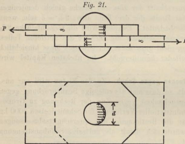
Dieser ist aber nicht gleichmässig über die Cylindermantelfläche verteilt, sondern, wie aus Fig. 21 ersichtlich, ist er am grössten in der Scheitel, von wo aus
