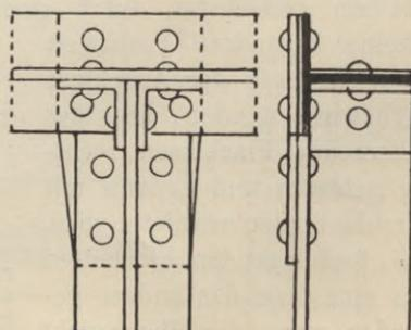
dass die Flansche des einen  $\perp$ -Eisens so weit beseitigt werden, dass die beiden Eisen ineinander geschoben werden können. Mit Hilfe eines Knotenbleches findet sodann die Befestigung beider statt. Bei grösseren  $\perp$ -Eisen werden ausserdem auch Winkelaschen benutzt (Fig. 125 und 126). An der Glasseite müssen die Nietköpfe versenkt werden, damit das Glas eine ebene Auflagerfläche findet.
