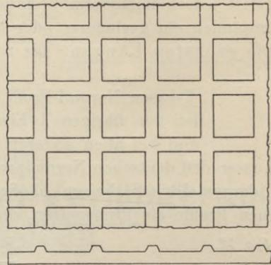
Bei den flachen Wellblechen ist die Wellenhöhe kleiner als die halbe Wellenbreite (Fig. 82). Die Stärke schwankt zwischen 0,5 und 2 mm.
