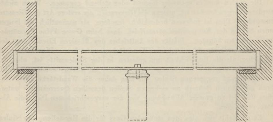
Geht ein Träger über einer Säule fort, so muss er auf derselben stets sein festes und in den Seitenwänden seine beweglichen Auflager finden (Fig. 318).
