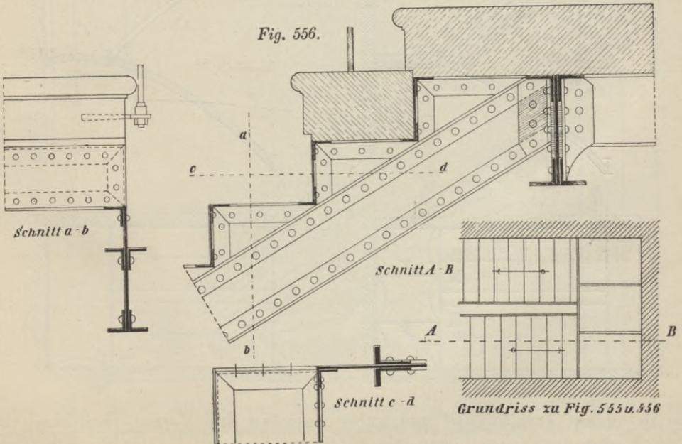
ist hergestellt aus einem 5 mm starken Stehblech, welches mit denselben kleinen Winkeln besäumt ist. Die Schnitte ergeben das Nähere. Der Nietdurchmesser beträgt 8 mm. An der Seite, an welche die Stufe mit dem  $\Gamma$ -Eisen in Berührung kommt, sind die Niete zu versenken.
