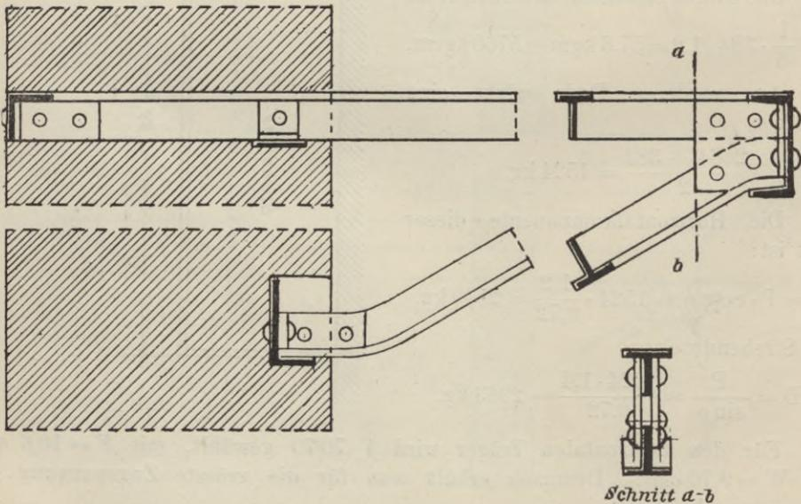
Die Konstruktion des Balkones ist in Fig. 526 angegeben. Statt der  $\perp$ -Eisen wird man vorteilhaft auch Winkeleisen benutzen können, die Anordnung würde sich dann nach Fig. 527 treffen lassen.
