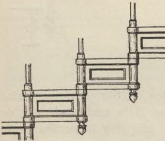
Eine andere Art dieser Treppen zeigt Figur 590. Hier werden Tritt- und Setzstufe und die Stirnstücke für sich gegossen und durch Schraubenbolzen, zu denen der untere Teil der Geländerstäbe ausgebildet wird, miteinander verbunden. Die Stirnstücke besitzen zu diesem Zwecke Hülsen, durch welche die Schraubenbolzen hindurchgehen. Die Setzstufen greifen in entsprechende Nuten der Hülsen ein.
