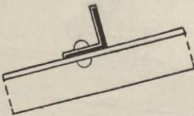
**Pfetten aus Winkeleisen.** Pfetten aus Winkeleisen dürften wohl nur bei kleinen Dächern mit geringer Binderentfernung am Platze sein. Die Befestigung der Pfette mit der Gurtung könnte dann nach Fig. 712 bis 714 geschehen.
