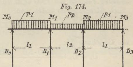
Die Momente  $M_0$  und  $M_3$  über den Endstützen sind gleich 0; die Grösse der über den Mittelstützen auftretenden negativen Momente  $M_1$  und  $M_2$  sind zu bestimmen aus der Gleichung:
