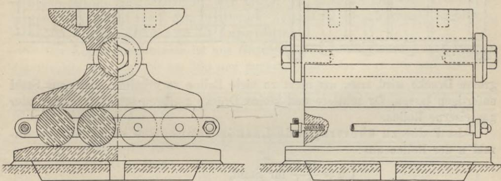
der Lagerplatte. Der obere Teil entspricht also völlig dem in den Figuren 191, 192 und 193 gezeichneten Kipplager. Das untere Sattelstück muss natürlich so lang sein, dass es bei der grössten Längsverschiebung des Trägers auf allen Rollen aufliegt.
