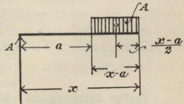
Da für den linken Trägerteil der Stützendruck A die einzige nach oben gerichtete Kraft ist, so folgt, dass die Belastung links vom gefährlichen Querschnitt gerade gleich dem Stützendruck A sein muss, da sonst die Resultierende aus beiden Kräften nicht gleich Null sein kann.
