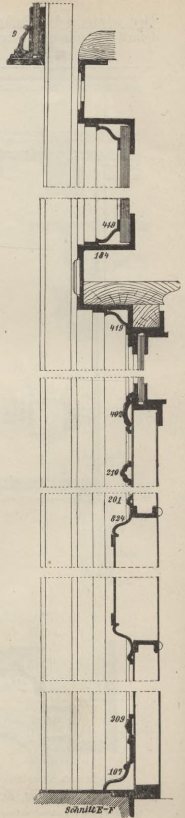
20 mm beträgt, damit der kalten Luft von aussen der Zutritt zur inneren Seite des Fensters ermöglicht wird. Hierdurch wird der Bildung des Schwitzwassers an den Scheiben vorteilhaft entgegengewirkt.
