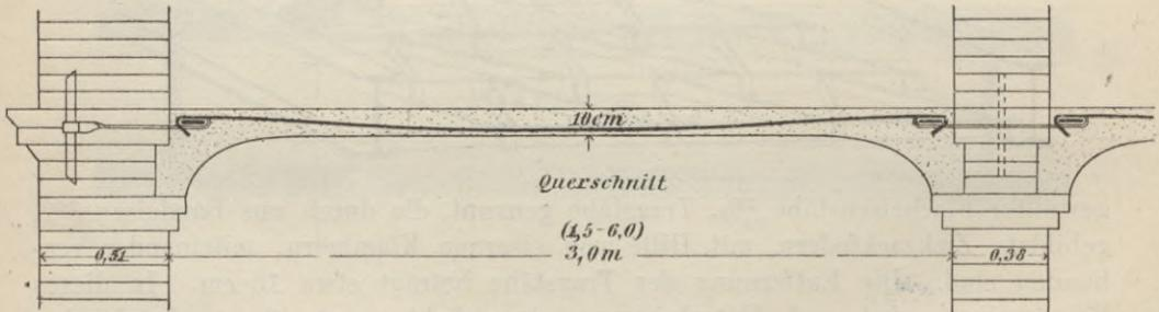
gewicht der Decke stellt sich auf rund 250 kg/qm. Auch diese Decke ist äusserst tragfähig, da Lasten von 4 bis 6000 kg keine bleibenden Durchbiegungen verursachen.
