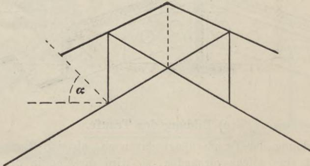
Ist keine Rinne längs der Traufe vorgesehen, wie dies bei Laternen häufig vorkommt, so lässt man die Sprossen und Glastafeln über die lotrechte Wand vorstehen, dass der Winkel  $\alpha$  (Fig. 798) etwa  $45^\circ$  wird.
