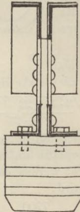
Das Sattelstück ruht auf dem Lagerbock, der oben entweder einen halbcylindrischen Zapfen besitzt oder eine halbcylindrische Vertiefung aufweist. Im ersten Falle ist in dem Sattel eine entsprechende halbcylindrische Höhlung ausgearbeitet (Fig. 191), im letzten Falle ist der Sattel mit dem Zapfen versehen (Fig. 192). Die Radien des Zapfens und der Aushöhlung müssen verschieden gross sein, damit bei der Durch-
