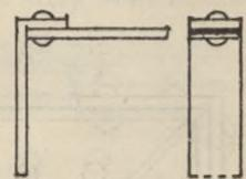
(Fig. 100) oder aber beide Flacheisen werden durch ein Winkeleisen miteinander verbunden (Fig. 101).
