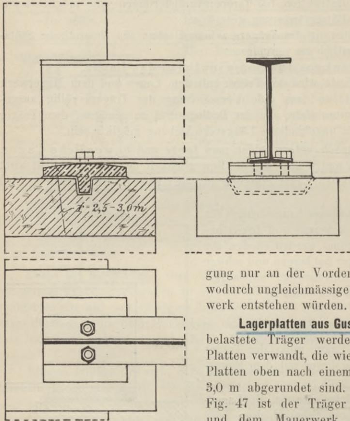
eine Aenderung ihrer Länge und der Anschluss an das Mauerwerk lässt sich leicht und sachgemäss bewirken. Durch die Wölbung der Platte ist ferner dafür Sorge getragen, dass der vom Träger ausgeübte Druck sich stets gleichmässig über eine grössere Fläche verteilt. Würde die Platte eben sein, so läge der Träger nach erfolgter Durchbiegung nur an der Vorderkante der Platte auf, wodurch ungleichmässige Pressungen im Mauerwerk entstehen würden.
