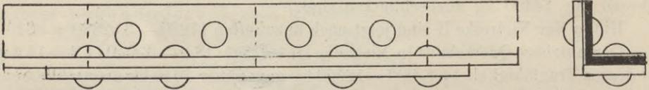
anschaulicht ist. In demselben Querschnitt stehen dann zwei Nieten, der eine  $1,5d$  vom äusseren Rande, der zweite im anderen Schenkel soweit von der
