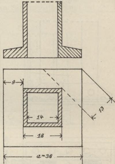
Für den oben berechneten quadratischen Querschnitt würde die Länge der quadratischen Fussplatte (Fig. 315) sich ermitteln aus:
