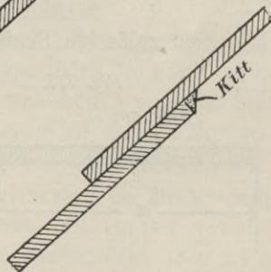
Bei längeren Oberlichtern entstehen häufig auch Quersfugen durch die Ueberdeckung der Tafeln. Das Mass der Ueberdeckung ist abhängig von der Neigung des Oberlichtes und ist zwischen 10 und 15 cm zu wählen (Fig. 778). Häufig wird die Quersfuge durch einen Kittstreifen gedichtet, der zwischen die Glasplatten gestrichen wird. Hierdurch geht indessen viel
