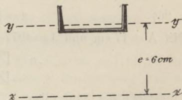
Beispiel 3. In Bezug auf die Achse  $x-x$  (siehe die Tabelle im Anhang) ist für zwei Winkeleisen N. P. Nr. 100/100/10  $F = 38 \text{ qcm}$ ,  $J_x = 360 \text{ cm}^4$ . Für die im Abstände  $e = 5,0 \text{ cm}$  gelegte parallele Achse  $z-z$  ist dann (Fig. 292a und b).
