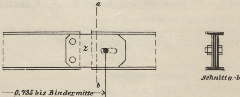
Da der Steg der  $\overline{\text{T}}$ -,  $\overline{\text{C}}$ - und  $\overline{\text{T}}$ -Eisen, die zu den Pfetten verwandt werden, sehr dünn ist, so kann man, um gegen Lochwanddruck eine grössere Festigkeit zu erzielen, denselben durch doppelseitig aufgenietete Flacheisen verstärken (Fig. 724). Eine andere Stossdeckung zeigt Fig. 725. Die aufgenieteten Flacheisen haben hier lediglich den Zweck, eine seitliche Verschiebung zu verhindern.
