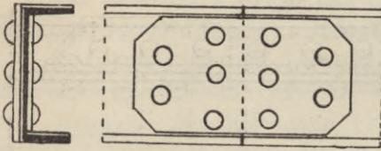
Stäbe damit begnügen, die beiden Teile des zu stossenden Gliedes stumpf gegeneinander stossen zu lassen, oder höchstens durch Anbringung einer mit wenigen Nieten anzuschliessenden Lasche die seitliche Verschiebung der Teile zu verhindern.
