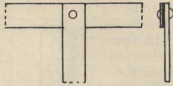
**Winkeleisen.** Der Anschluss eines Winkeleisens an ein anderes wird mit Hilfe von Winkelaschen, Knotenblechen oder unter gleichzeitiger Verwendung beider bewirkt (Fig. 120 bis 124).
