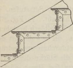
Ein anderes Beispiel dieser Art zeigt Fig. 616. Hier wird die an der Vorder- und Hinterkante rechtwinkelig umgebogene Trittstufe direkt mit der Setzstufe vernietet.
