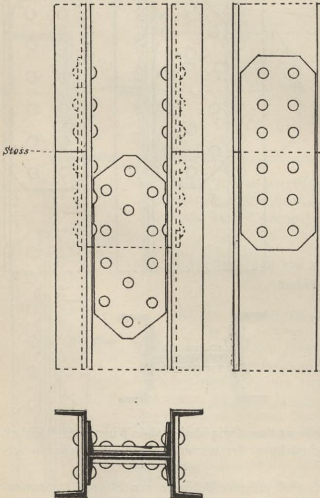
schnittig. Für die Querschnittsbestimmung der Decklaschen ist der Umstand massgebend, dass das Trägheitsmoment des Stehbleches gleich dem Trägheitsmoment der beiden Decklaschen sein muss.
