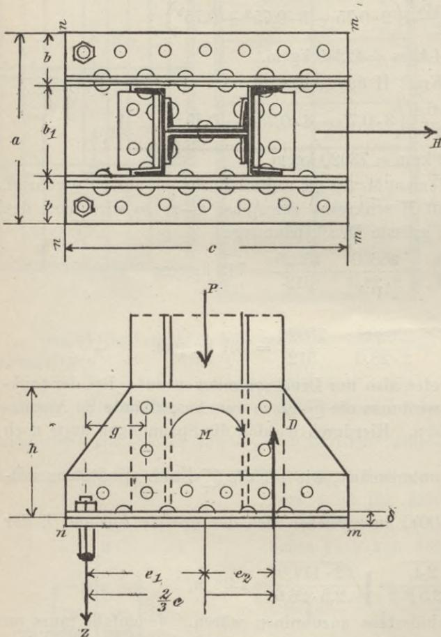
der gleichzeitigen Wirkung von P und M sich ergebenden Pressungen darstellt. Der gesamte Druck D auf den Auflagerstein wird repräsentiert durch das Dreieck m q s, die vom Anker aufzunehmende Zugspannung Z durch das Dreieck n o s. Z und D können in den Schwerpunkten der genannten Dreiecke angreifend gedacht werden. Aus der Aehnlichkeit dieser Dreiecke ergibt sich der Abstand  $e_1$  des Ankerzuges von der Plattenmitte leicht zu:
