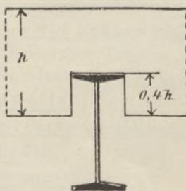
Die einfachste Anordnung ist die, dass die Balken auf den Unterzug gelagert werden. Dies geschieht vielfach mittels einer Verkämmung von 1 bis 2 cm. Bei geringer Konstruktionshöhe kann die Verkämmung bis  $\frac{2}{5}$  der Balkenhöhe vertieft werden (Fig. 212 u. 213).
