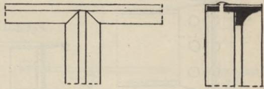
Die Verbindung von  $\perp$ -Eisen mit Winkeleisen, wie sie ebenfalls vielfach bei eisernen Fenstern vorkommt, ist in Fig. 129 dargestellt.
