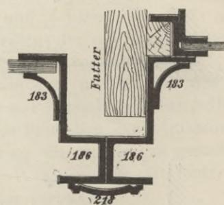
Laibung gewünscht wird. Die Kehlleiste in Fig. 407 dient zur Befestigung der Scheibe.
