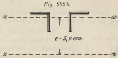
**Säulenquerschnitte aus T- und □-Eisen.** Es sei P die zu übertragende Last, l die Länge der Säule,  $J_{\text{erf}}$  das aus Gleichung 94) berechnete erforderliche kleinste Trägheitsmoment des Säulenquerschnittes, dann muss im Hinblick auf die Fig. 293 und 294 das Trägheitsmoment des gewählten Querschnittes sowohl für die  $x - x$  wie auch für die  $z - z$  Achse gleich  $J_{\text{erf}}$  sein.
