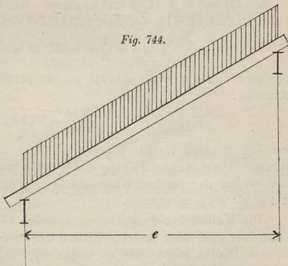
Ist  $p$  die Belastung pro qm Grundriss (Eigengewicht, Schnee- und Winddruck),  $e$  die Entfernung der Pfetten im Grundriss gemessen, ausgedrückt in Metern (Fig. 744), so wird, da das Wellblech als ein Träger auf zwei Stützen zu betrachten ist, das grösste Moment:
