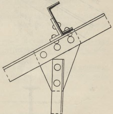
fällt. Bei vielen ausgeführten Dächern hat man indessen den Steg der Pfetten normal zur Dachfläche angeordnet (Fig. 726 bis 729). Hiermit ist aber die Gefahr einer seitlichen Durchbiegung vorhanden, wenn nicht genügend starke Profile gewählt werden.
