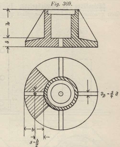
so ordne man Rippen an. Die Zahl der Rippen ist entweder vier oder acht (Fig. 308 und 309). Ist  $b$  der grösste Abstand zweier Rippen, so erhält man die Randstärke der Platte, wenn man den zwischen zwei Rippen liegenden Teil der Platte als einen längs der Rippen eingespannten Träger betrachtet, aus der Gleichung:
