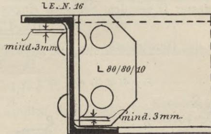
mangelhafte Vernietung zustande kommt. Dies ist namentlich wichtig bei den Trägeranschlüssen, wie dies die Figuren 35 bis 38 zeigen. Weiterhin wird bei den Trägeranschlüssen noch eingehender davon die Rede sein.
