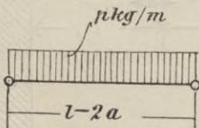
**Träger zwischen den Gelenken.** Die Länge des Trägers zwischen den Gelenken ist  $l - 2a$ , seine Belastung somit  $(l - 2a) \cdot p$  kg, wovon jedes Gelenk die Hälfte, also  $\frac{(l - 2a)p}{2}$  kg erhält. Das Moment  $M$  in der Mitte des kurzen Trägers zwischen den Gelenken ist nun nach Gleichung 51:
