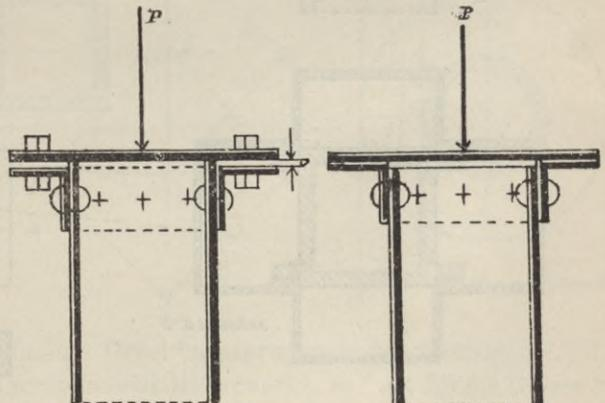
Um den Säulenfuß möglichst klein zu erhalten, wird zwischen Fundamentmauerwerk und Säulenfuß ein Auflagerstein eingeschaltet. Zwischen der Fussplatte und dem Fundament ist stets eine Zement- oder Bleifuge anzuordnen, damit die Unebenheiten der Steinoberfläche ausgeglichen werden und dadurch eine gleichmässige Druckverteilung erreicht wird.
