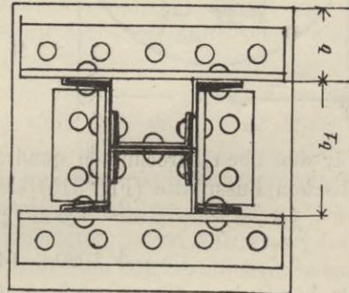
Beispiel 1. Es sollen die Abmessungen des Säulenfusses für die oben auf Seite 114 berechnete gusseiserne Säule bestimmt werden, unter der Annahme, dass ein Auflagerstein vorhanden ist, der mit 25 kg/qcm gedrückt werden darf.
