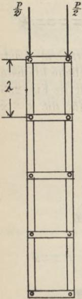
Die vorstehende Betrachtung gilt indessen nur unter der Voraussetzung, dass die Teilquerschnitte wie ein einheitlicher Querschnitt zur Wirkung gelangen. Würden daher die  $\text{I}$ - bzw.  $\text{C}$ -Eisen nicht miteinander verbunden sein (Fig. 295), so würden die Stäbe in der Richtung der  $x-x$  Achse einknicken. Es entsteht daher noch die Frage, wie oft müssen die Stäbe miteinander gekuppelt werden?
