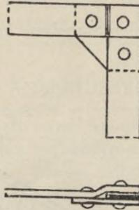
**Winkelisen.** Die Eckbildung bei Winkelisen geschieht am zweckmässigsten mit Hilfe von Knotenblechen, indem man die Winkel auf Gehrung schneidet (Fig. 104) oder den einen Winkel, was indessen nicht zu empfehlen ist, über den anderen kröpft (Fig. 105). Zur Erhöhung der Festigkeit tritt häufig noch eine winkelig gebogene Flacheisenlasche dazu (Fig. 106 und 107).
