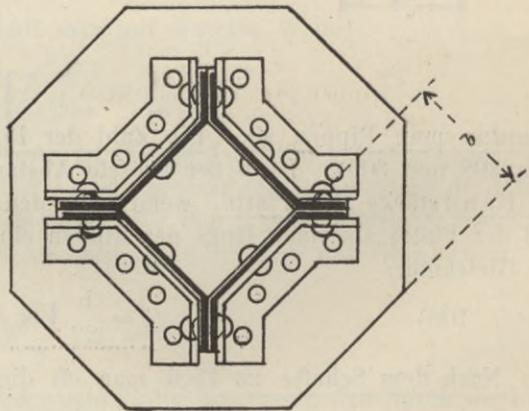
platte stossen lässt und beide Teile durch Winkeleisen miteinander verbindet. Die Fussplatte erfährt hierdurch gleichzeitig eine wesentliche Aussteifung.
