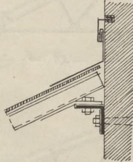
An den Seitenrändern kann der Anschluss nach Fig. 806 und 807 hergestellt werden. Ein guter Schutz wird durch Vorkragen der Mauern erreicht.
