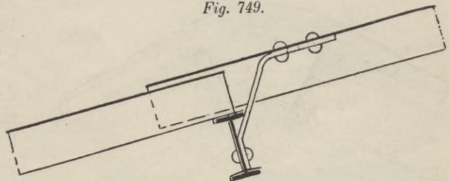
**Befestigung von Wellblech und Pfetten.** Die Verbindung der Tafeln mit den Pfetten geschieht am besten mit Hilfe der in Fig. 260 abgebildeten Agraffe, die an jeder 3. bis 4. Welle mit dem Wellenberge mit 2 bis 3 Nieten von 6 mm Durchmesser verbunden werden (Fig. 746 bis 748), während der untere Teil der Agraffe unter den Flansch der Pfette greift.
