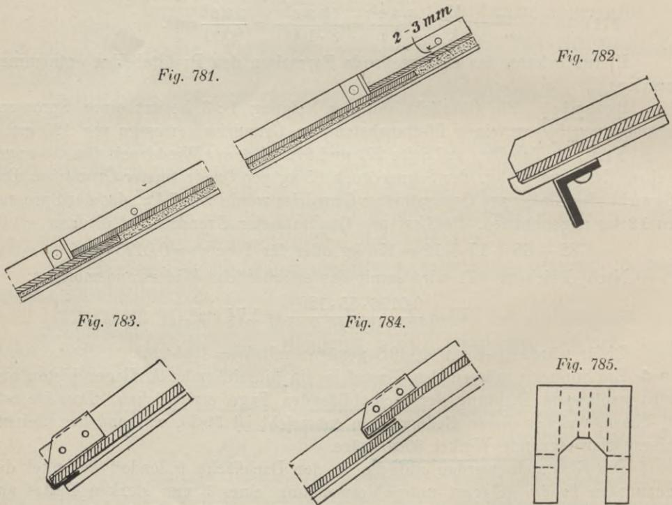
Kommen Querfugen vor (Fig. 781), so werden die dadurch entstehenden keilförmigen Fugen zwischen Glas und Sprossen gedichtet, entweder durch Kitt oder schlanke Keile aus hartem Holz oder Eisen. Die Querfugen werden zweckmässig durch Kitt gedichtet.
