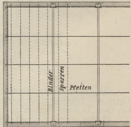
Pfetten behindert. Die Sparrenteilung wird man daher zweckmässig folgendermassen vornehmen. Man verlege zuerst die Sparren längs den Giebelwänden und teile die Entfernung der Binder in eine Anzahl gleiche Teile, deren Grösse der üblichen Sparrenentfernung entspricht. Nun zeichne man den zweiten Sparren ein im Abstände gleich der Hälfte des Teilmasses und hierauf die übrigen Sparren im Abstände des Teilmasses. Ueber den Bindern liegt alsdann kein Sparren,
