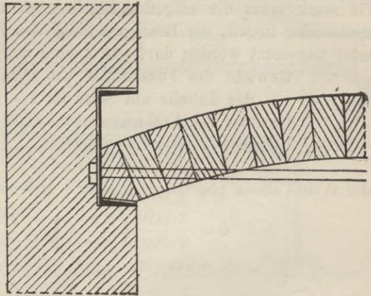
**Betondecken.** Die Betondecken zwischen eisernen Trägern haben in den letzten Jahren immer mehr an Bedeutung gewonnen. Sie gelangen sowohl als gerade wie auch als gewölbte Decken zur Ausführung.
