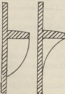
Zur rationellen Durchbildung des Säulenstosses werden oft Zwischenstücke eingeschaltet. Schon in Fig. 326 wurde ein Beispiel dieser Art dargestellt, in dem die Mauerbögen sich gegen ein Zwischenstück stützten, das gleichzeitig zur Aufnahme der oberen Säule diente.
