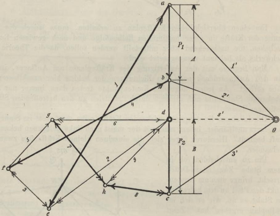
müssen die Pfeile aufeinanderfolgen. Der Umlaufungssinn im Kräftezuge  $daed$  ist daher durch die einfachen Pfeile ausgedrückt. Bringt man am Knoten  $A$  die Pfeile an, so weist der Pfeil von 1 nach  $A$ , so dass die Spannung im Stabe 1 Druck bedeutet. Im Stabe 2 zeigt der Pfeil von  $A$  weg, demnach ist die Spannung in 2 Zugspannung.
