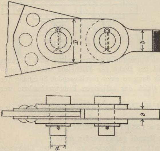
Soll die Zugstange an ein Knotenblech angeschlossen werden, dessen Stärke  $\delta$  dünner ist als die berechnete Stärke  $\delta$  des Auges, so sind auf das Knotenblech beiderseitig Futterstücke aufzunieten, so dass die Stärke des Knotenbleches gleich der des Auges wird (Fig. 59).
