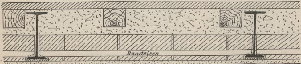
Trägerunterkante herunterragen und schliesst die unter Trägerflansch entstehende Nut mit Zementmörtel (Fig. 497). An den Umfassungswänden stemmt man ent-
