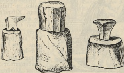
Fig. 15, 16, 17. Ambos mit Horn von einer griechischen Gemme. Luppen-Ambos nach einem pompejanischen Wandgemälde.
