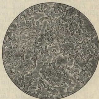
Fig. 401. Flussstahl, gehämmert, 0,62 % Kohlenstoff; geätzt und angelassen. Die hellfarbigen Theile sind Kristalleisen, die dunkleren Homogeneisen.
