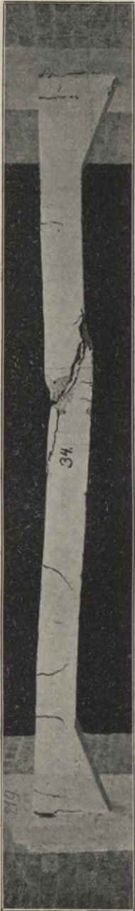
Abb. 217. Bruchbild des Balkens Nr. 34.
