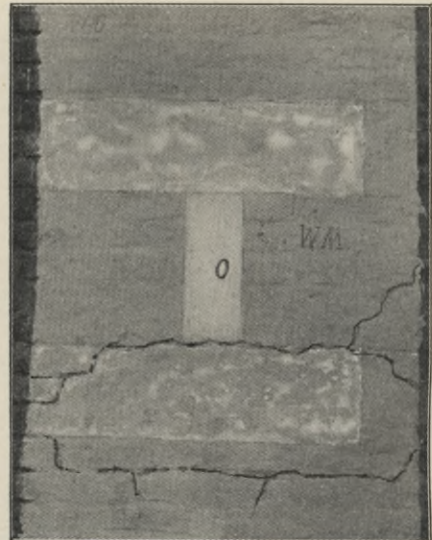
Abb. 237. Eruchbild des Balkens o.
