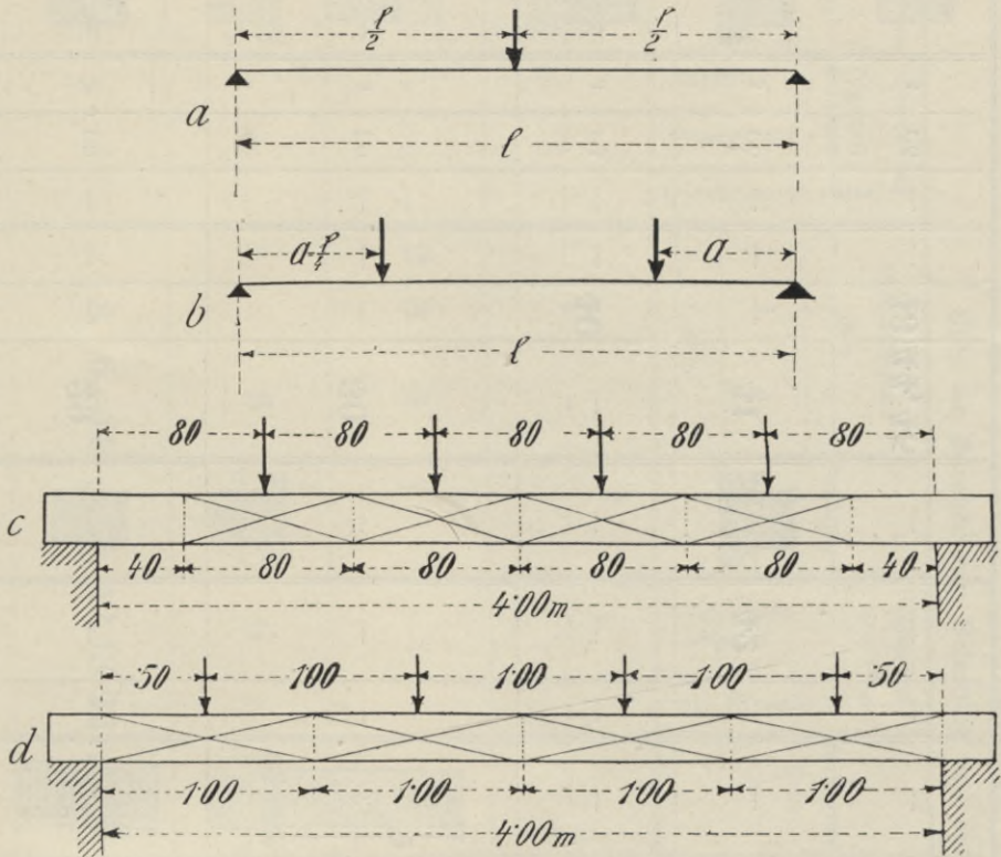
Abb. 4. Die Lastenverteilungen bei den Versuchen.
