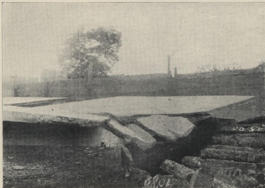
Abb. 82. Bruchbild des Objektes 7b (Balken 1', 3').
