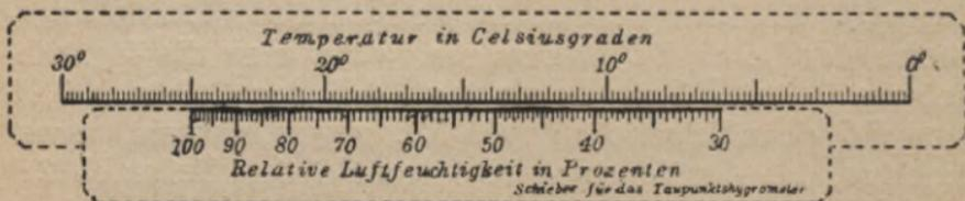
Bild 29. Schieber für das Taupunkthygrometer.
