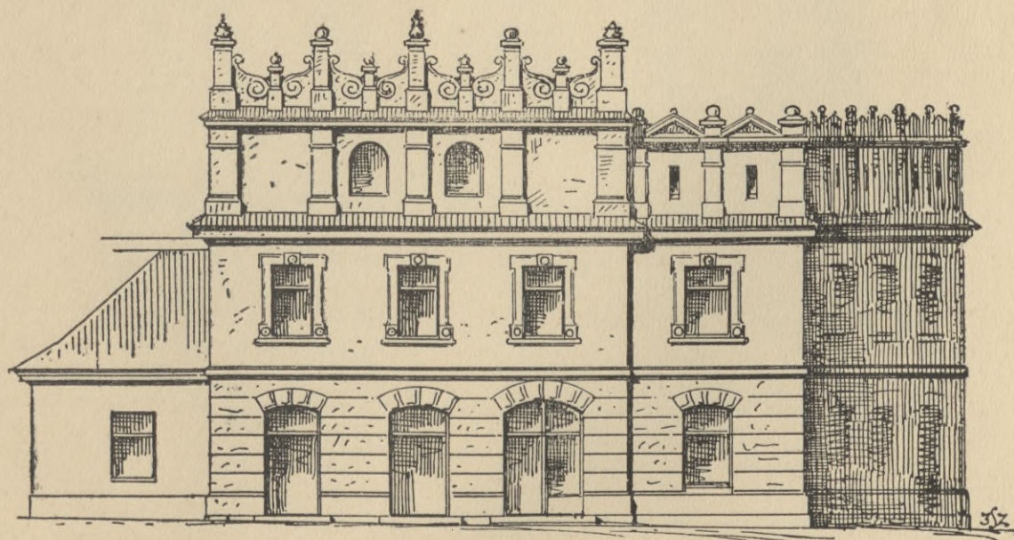
Dom narożny dwupiętrowy, z zastosowaniem u góry dachu t. zw. pograżonego, który jest zakryty ścianą czołową, czyli atyką polską. Ta ostatnia opiera się na prawie połowienia pojedynczego i podwójnego.
