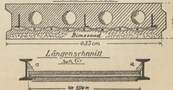
Fig. 162. Querschnitt der Cementdiele 1/3 nat. Grösse.
