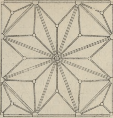
Fig. 294. Grundriss eines Stern- gewölbes (nach Ungewitter).
