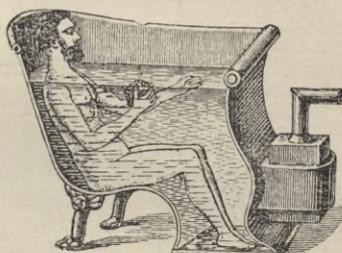
aber auch eine Erwärmung des in der Wanne befindlichen kalten Wassers durch Einleitung von Wasserdämpfen geschehen.
