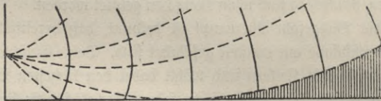
Schallablenkung und Schallschatten.
