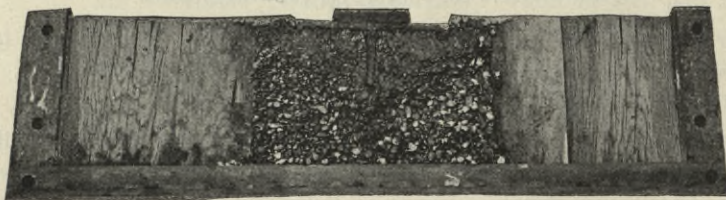
Bettungsquerschnitt bei 36 cm Schwellenabstand.
