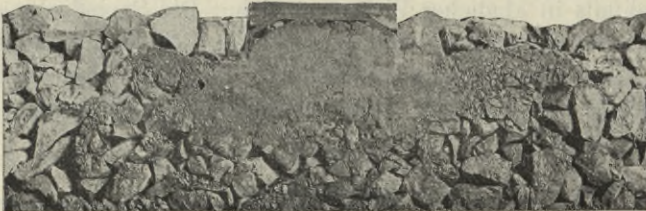
Schlackenbettung nach siebzehnmalem Stopfen.
