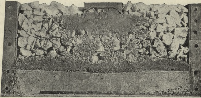
Querschnitt einer hohen Steinschlagbettung mit Thonunterlage.
