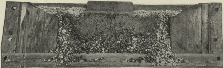
Bettungsquerschnitt bei 55 cm Schwellenabstand.
