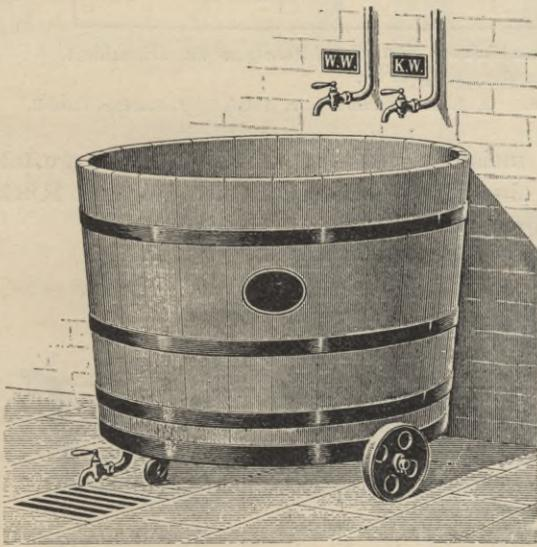
Fahrbarer Einweichbottich mit Kalt- und Warmwasserzuleitung<sup>11)</sup>. —  $\frac{1}{25}$  w. Gr.
