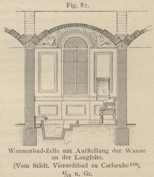
Die Umfassungswände der Zelle werden am besten aus Stein bis an die Decke hinaufreichend hergestellt (vergl. die Ausführungen bezüglich der Benutzung durch beide Geschlechter in Art. 143, S. 105). Vielfach sind auch Holzwände
