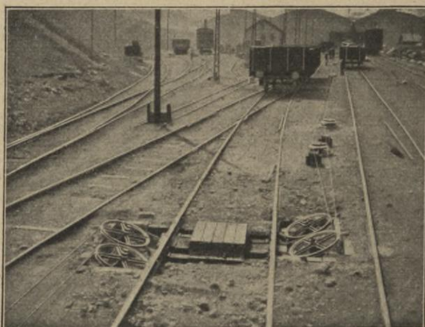
Rangieranlage mit endlosem Seil; Seil über Rollen geführt, läuft stetig um. Nach Ausf. der Firma *Ad. Bleichert & Co.*-Leipzig-Gohlis.
