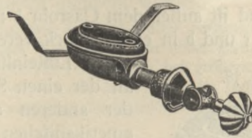
Einringbrenner von Schneider & Trenkamp zu Cleveland.
