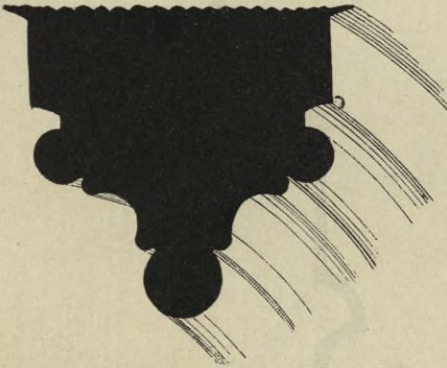
Gewölbegurt in der Abteikirche zu St.-Denis 37) .
