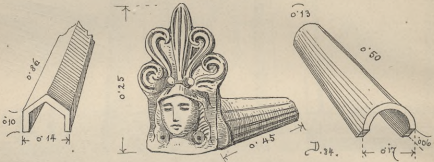
Terracottahohlziegel aus Pompeji.
