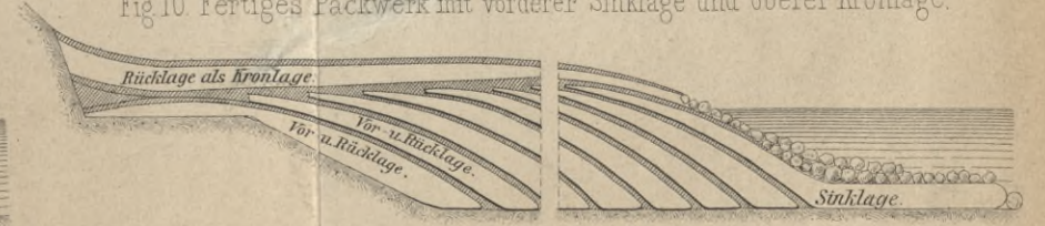
Fig 10. Fertiges Packwerk mit vorderer Sinklage und oberer Kronlage.
