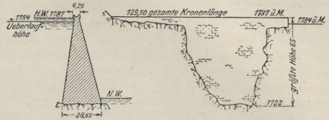
Abb. 215. Ansicht und Querschnitt der Pathfinder-Talsperre.
