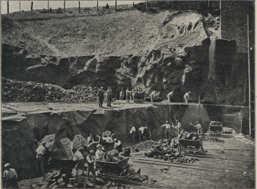
Abb. 292. Tuffsteingrube bei Kruft im Nettetale für die Gewinnung von Traß.
