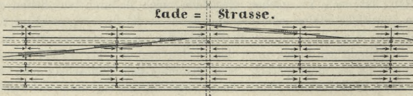
Maßstab 1 : 2000. Bahnhofsentwässerung incl. offenen Mulden und Kanälen.
