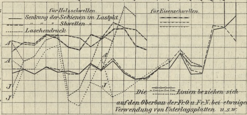
Fig. 250. Darstellung der Oberbaukosten bei verschiedenen Anordnungen bezüglich der Spannungen und Senkungen der einzelnen Gleisheile im Vergleich zum Preussischen Oberbau 6 d.
