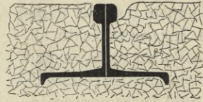
Mafsstab 1 : 20. Haarmann'sche Schwellenschiene in Landstraßen, ohne Spurrille.
