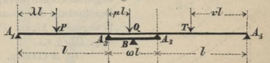
$(A_2) = (A_3)$  hervor, wie die ebenso grofse Last  $P$  im Abstände  $\nu l = \lambda l$  von  $A_4$ . Bezeichnet man daher die bei irgend einer Belastung an den Enden des Wagebalkens hervorgerufenen Stützendrücke mit  $(A_2) = (A_3)$ , dagegen diejenigen Stützendrücke, welche an denselben Stellen, bei derselben Belastung, jedoch bei unnachgiebigen Stützen erzeugt werden, mit  $A_2$  und  $A_3$ , so ist stets
