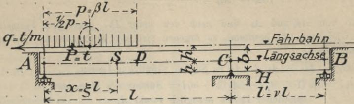
In gleicher Weise, wenn 2. Feld  $l$  unbelastet und Feld  $l'$  auf die Länge  $p' = \nu l \cdot \beta'$  belastet ist, wobei sich  $p' = \nu l \beta'$  auf die Mittelstütze bezieht, mit  $\mathfrak{P} = (q \nu l) [\xi' - 1] b \beta'$
