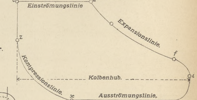
Abb. 80. Einfluss der Drosselung auf Anfang und Ende der Dampfperioden.
