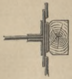
Abb. 143. Schutzholz an den Rückseiten der Riegel. 1:25.
