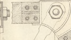
Fig. 18. Verbinding eindstijl met de randen.
