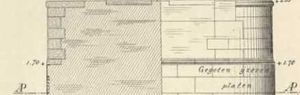
Tuschenpijler der draaibrug tegenover de Oosterdok-sluis te Amsterdam. Fig. 12-15. Doorsnede Fig. 12. Opstand Fig. 13.
