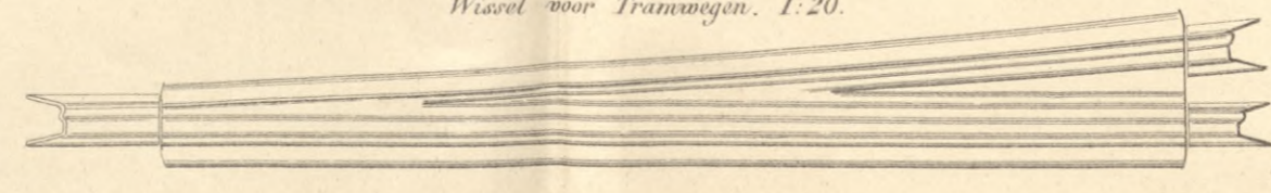
Fig. 12. Aanslaande tong voor tramwegwissels. 1:25.
