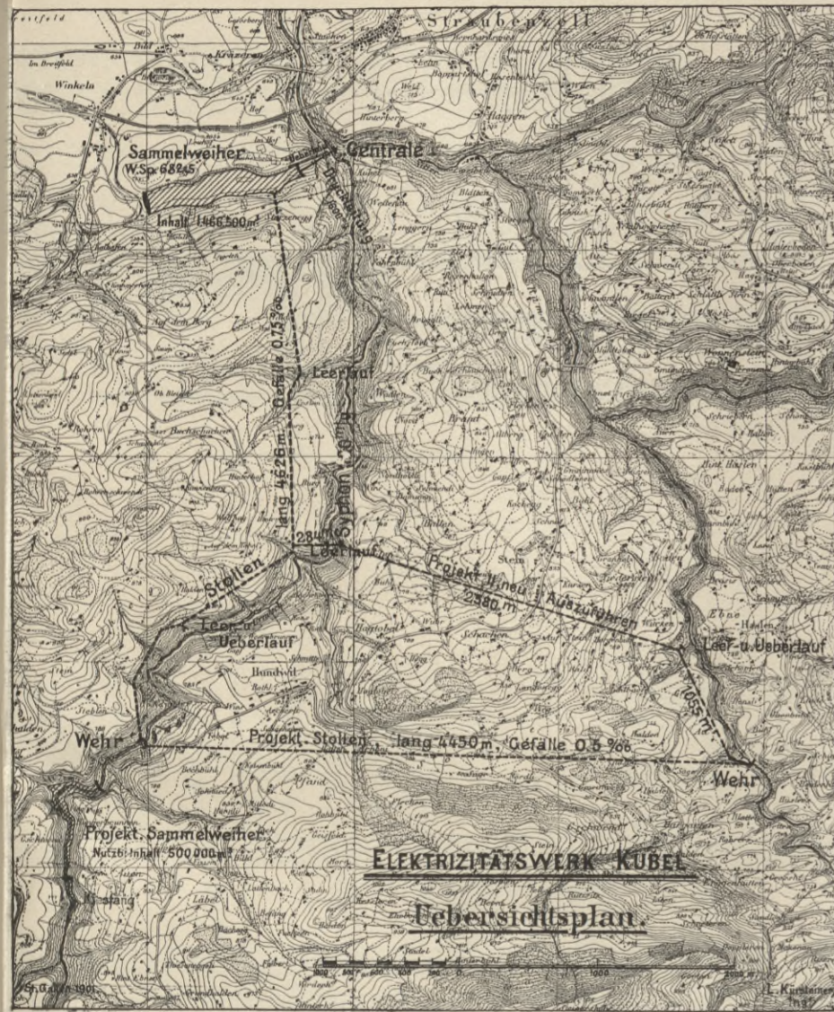
Figur 1. Übersichtsplan der Wasserkraftanlage. Massstab 1 : 50,000.
