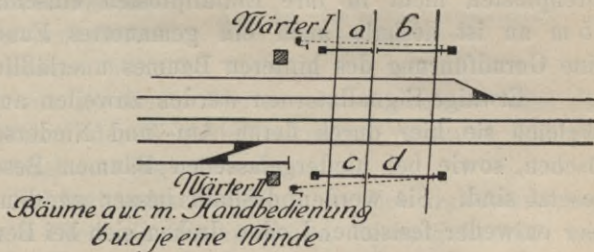
Abb. 51. Schranke mit einzeln bedienten Schlagbäumen.
