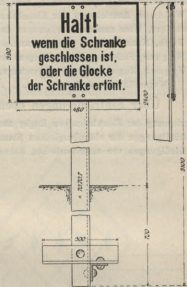
Abb. 105. Warnungstafel für Wegübergänge mit Schranken von E. Pfeffer, Erfurt.
