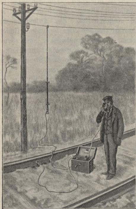
Abb. 296. Tragbarer Fernsprecher der Bayerischen Staatsbahnen von F. Reiner, München.
