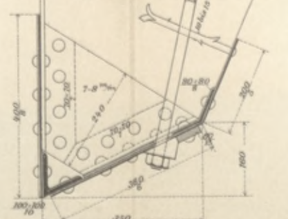
Abb. 6. Einzelheiten. der Schneide. M. 1:12 1/2.
