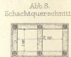
Abb. 8. Schachtquerschnitt. M. 1:100.
