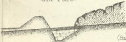
Abb. 5 u. 6. Dammrutschung an der ungarischen Nord-Ost Bahn.
