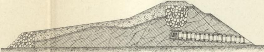
Abb.10u.11. Rutschung am Staudamm des Staubeckens von Cercey am Kanal du Bourgogne.
