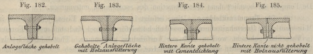
Fig. 182 bis 185. Verschiedene Dichtungsarten.
