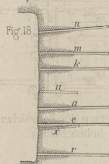
Ansetzen der Bohrlöcher mit vier Maschinen Dubois u. François.
