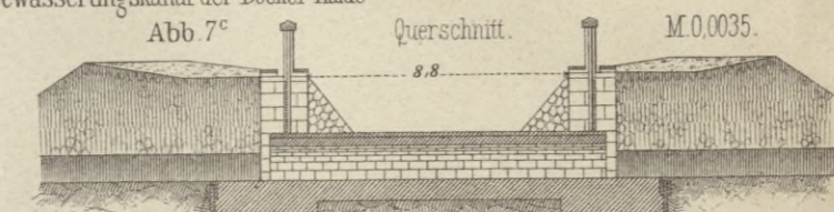
Abb. 7 a -7 c Aquadukt für einen Bewässerungskanal der Bocker Haide M. 0,0035
