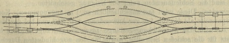
Abb. 157. Abt's selbstthätige Ausweiche mit doppeltem Spurkranz.
