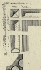
Fig. 79. Batzdorf, Herrenhaus, Fenstergewände.
