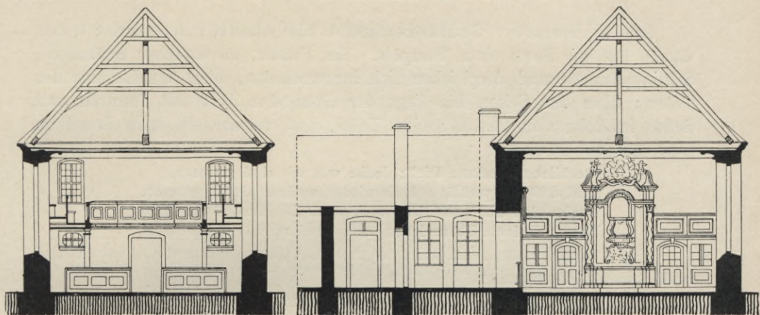
Fig. 426 und 427. Skassa, Kirche, Querschnitte, Zustand vor 1901.
