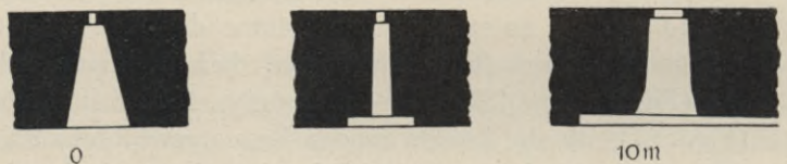
Fig. 596. Zschorna, Schloß, Kellergeschoß, schießchartenartige Fenster.
