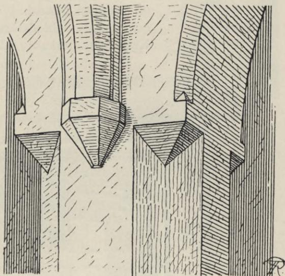
Fig. 271. Löbau, Nikolaikirche, Pfeiler, Grundriß des Rippenansatzes.
