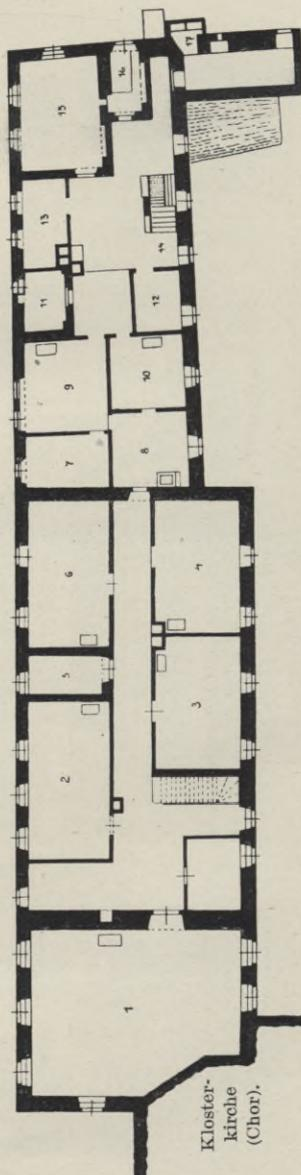
Fig. 320. Löbau. Schule. II. Obergeschoß. Zustand von 1855.
