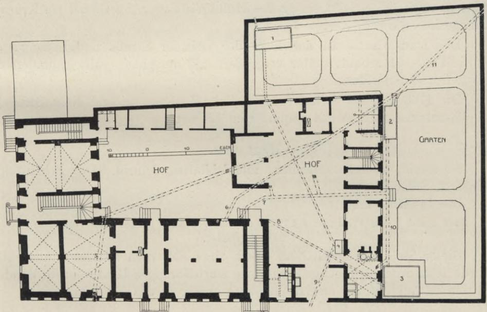
Fig. 189 und 190. Herrnhut, Dürningersches Haus, Schauseite und Erdgeschoßgrundriß.
