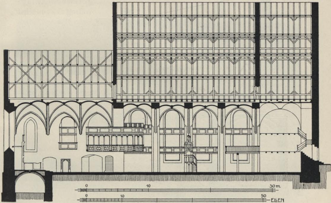
Fig. 266. Löbau, Nikolaikirche, Längsschnitt, Zustand vor 1884.
