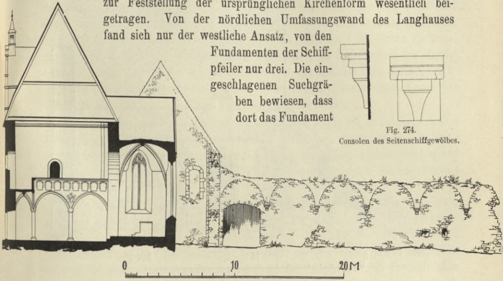
Fig. 273. Kloster Buch. Längsschnitt durch die Kirchenachse.
