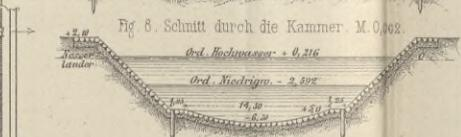
Fig. 7, 8, 9, 21. Neue Seeschleuse bei Emden.
