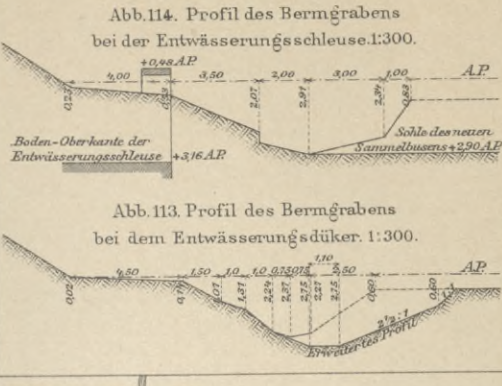
Abb. 114. Profil des Bermgrabens bei der Entwässerungsschleuse. 1:300.
