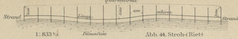
Abb. 45. Anordnung der Schirme am Dünenfuss im Grundriss.
