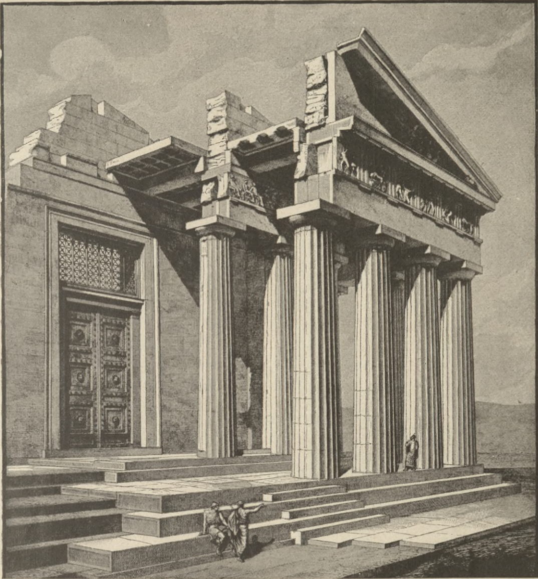
Fig. 93. Aufbau einer Ecke des Parthenon. (Wiener Vorlegeblätter, Niemann.)
