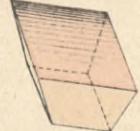
Vue de la Clef de la Voûte plate
