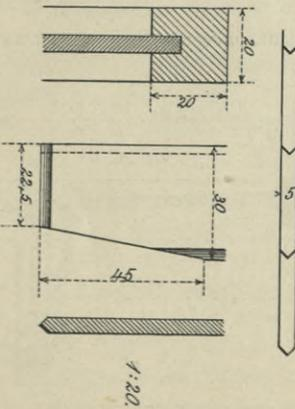
Fig. 376. Nadelwehr (Holzkonstruktion).
