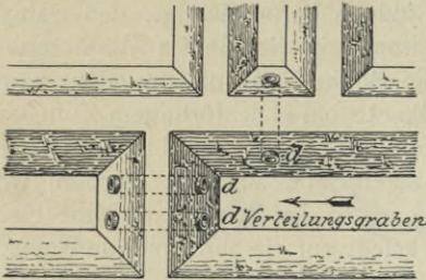
Fig. 420. Erddammsperre mit Röhrendurchlässen.
