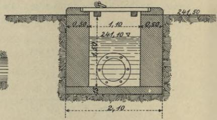
Querschnitt durch den Einlaufschacht.
