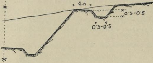
Fig. 181. Abwässerung durch Saumgräben. Querschnitt.
