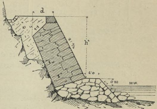
Fig. 162. Steinsatz und Trockenmauer.
