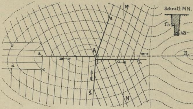
Fig. 273. Drainsystem auf abgeschlossenen Mulden (Becken).
