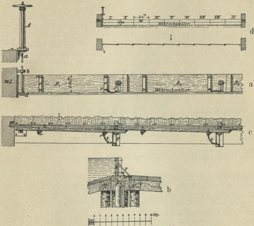
Fig. 368. Bewegliche Wehraufsätze für eine Pfostenhöhe (System Friedrich).
