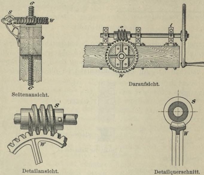
Fig. 335. Schützensaufzug mit einer Schraubenspindel.
