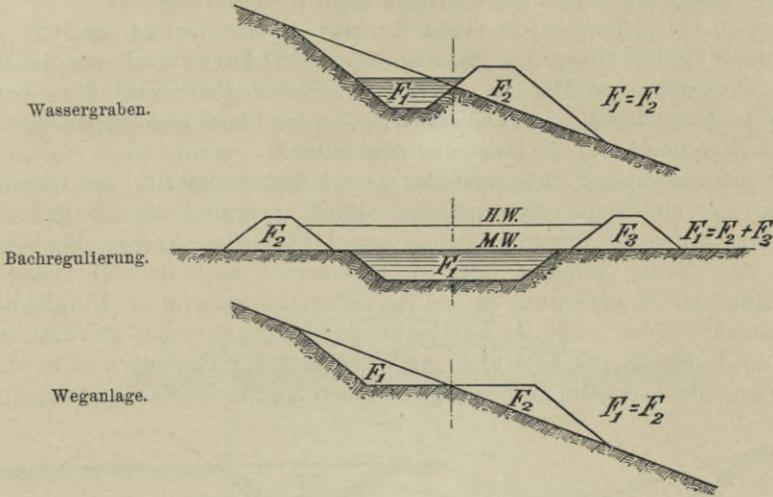
Fig. 114. Seitlicher Massenausgleich.
