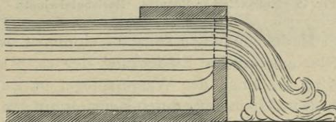
Fig. 71. Ausfluß mit sehr geringer Druckhöhe.
