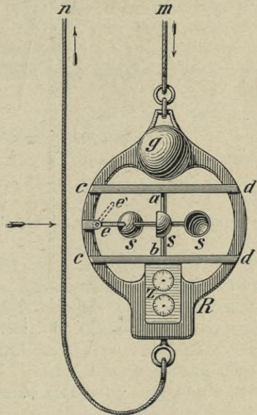
Fig. 55. Arwidsonscher Stromgeschwindigkeitsmesser.
