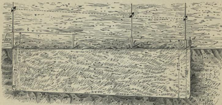
Fig. 286. Herstellung eines Draingrabens mit verschiedener Sohlentiefe.
