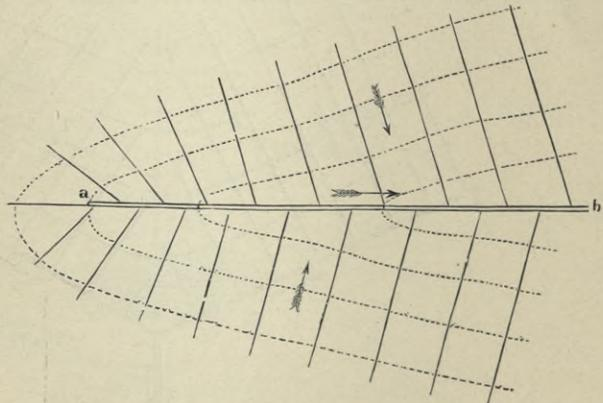
Fig. 272. Drainsystem in einer offenen Längsmulde.
