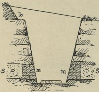
Fig. 178. Verkleidung loser Schichten.
