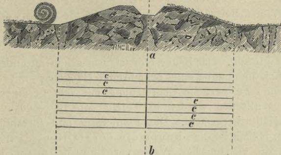
Fig. 453. Rasendeckung der Böschungen eines aufgedämmten Grabens.
