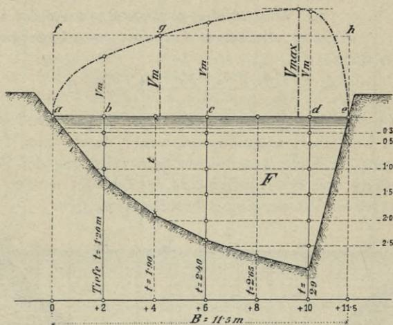
Fig. 95. Bachprofil mit der Kurve der mittleren Vertikalgeschwindigkeiten.
