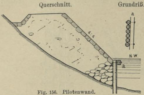
Fig. 156. Pilotenwand.
