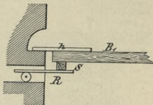
Fig. 372. Auslösung mit Schubriegel
