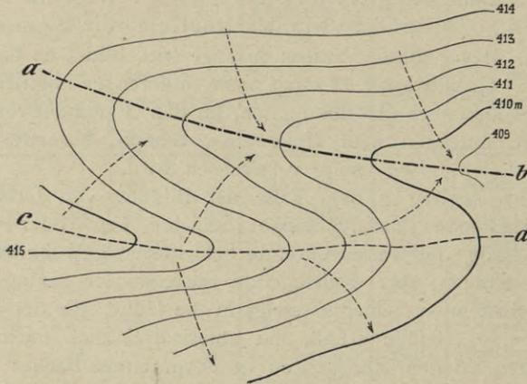
Fig. 29. Grundwasserschichtenplan.
