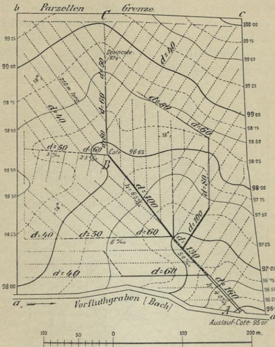
Fig. 282. Entwässerungsplan mittels Längsdrainage.
