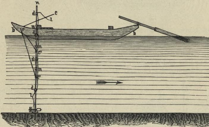
Fig. 43. Stromgeschwindigkeits-Messung mit dem Woltmannschen Flügel. Seitenansicht.
