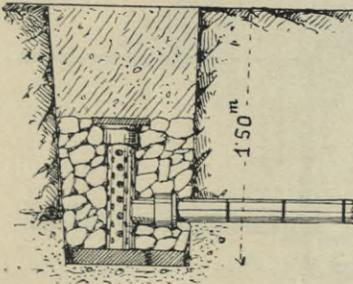
Fig. 312. Quellenfassung mittels gelochter Steinzeugrohre.
