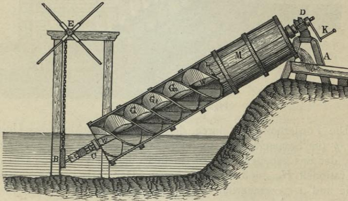
Fig. 243. Mantelschnecke.
