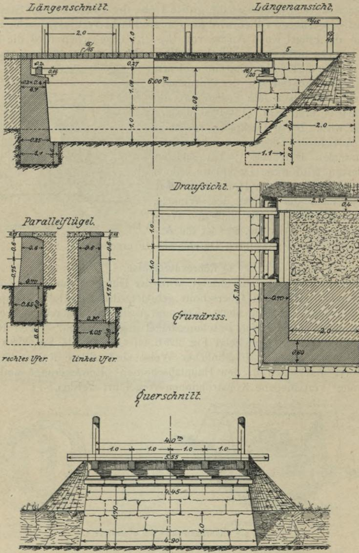
Fig. 230. Normalplan einer Brücke (Holzkonstruktion mit gemauerten Landpfeilern).
