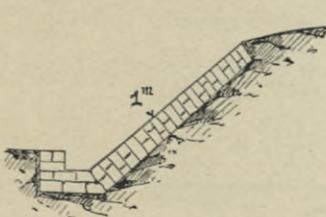
Fig. 199. Steinsatzbekleidung als Widerlager.
