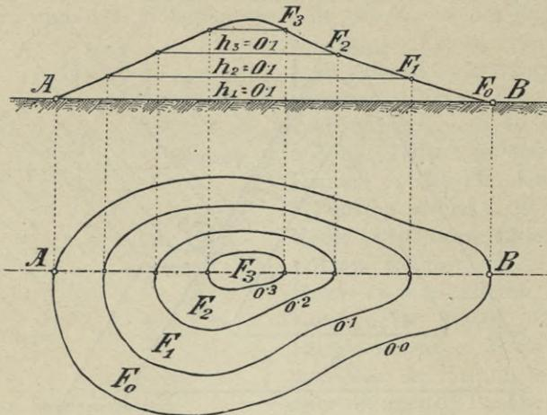
Fig. 112. Kubaturberechnung eines Hügels.
