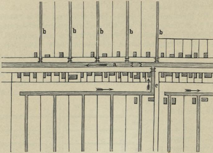
Fig. 330. Veenanlage (Zweikanalsystem).
