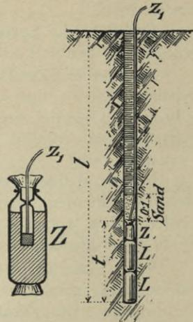
Fig. 109. Bohrlochladung.
