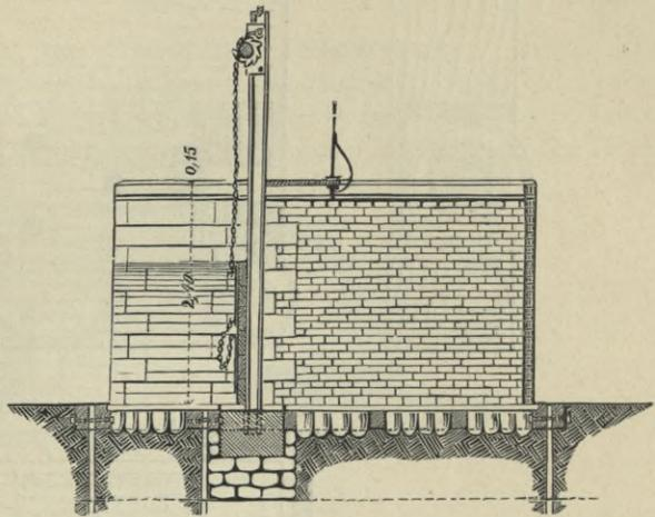
Fig. 339. Schleuse mit eisernem Schützenrahmen. Längenschnitt.
