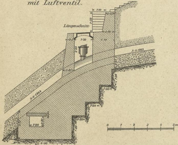
Fig. 16. Unterführung des Canal du Moulin und Entleerung.
