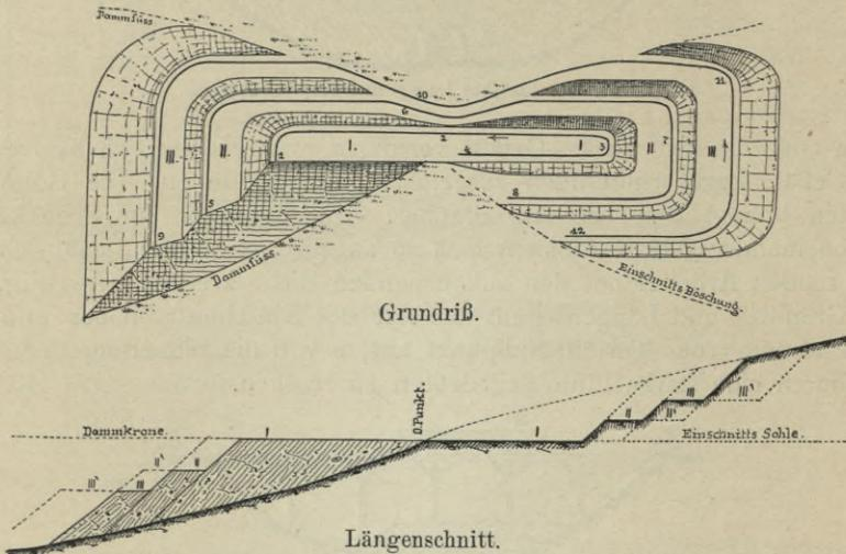
Fig. 169. Lagerschüttung (Anordnung der Fahrbahnen).
