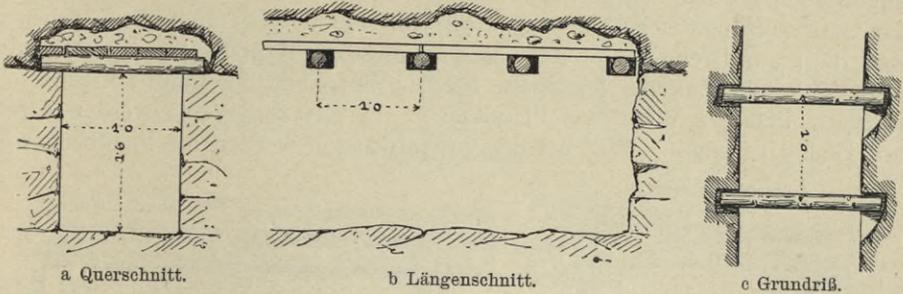
Fig. 202. Firstausbau.
