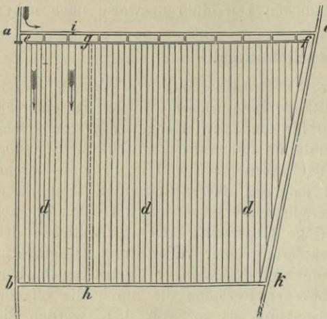
Fig. 413. Furchenbewässerung bei kleinem Terraingefälle.
