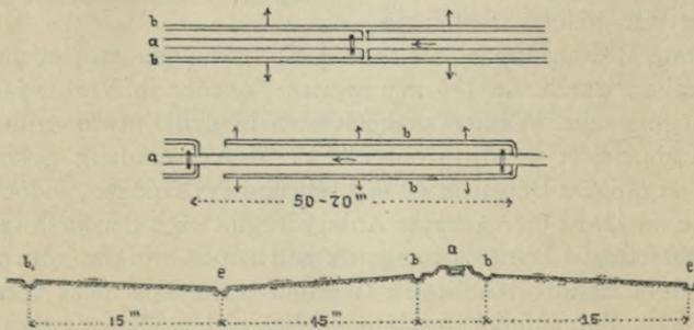
Fig. 435. Abzweigung der Wassergräben aus dem Hauptgraben.
