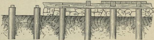
Fig. 403. Pfahlrost. Querprofil.
