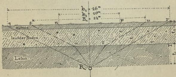
Fig. 265. Bestimmung der Drainstrangentfernung nach Blauth.
