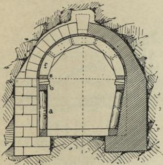
Fig. 206. Stollenausmauerung mit senkrechten oder schiefen Widerlagern.
