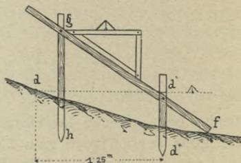
Fig. 129. Aufstellung des Dammfußprofils.
