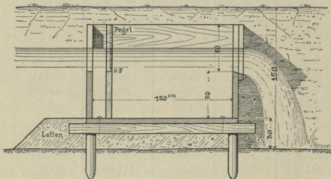
Fig. 89. Apparat zur Wassermessung mittels Überfall. Längenschnitt.
