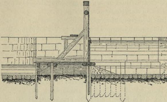
Fig. 380. Hauptstauschleuse (Querschnitt).
