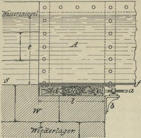
Fig. 356. Aquäduktichtung ohne Dilatation. Längenschnitt.
