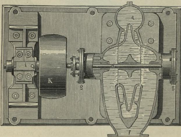
Fig. 250. Zentrifugalpumpe. Grundriß mit teilweise Horizontalschnitt.
