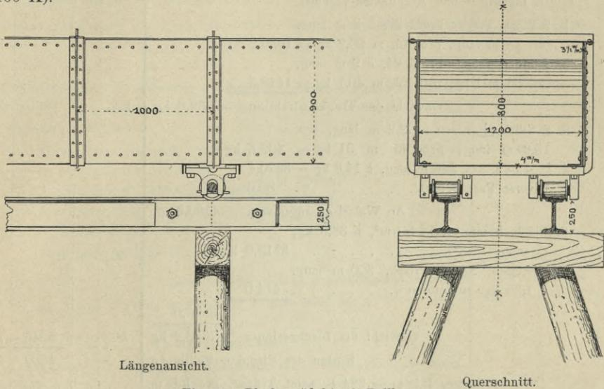
Fig. 355. Blechaquädukt mit Rolllager.
