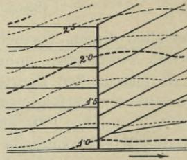
Fig. 264. Querdrainage.
