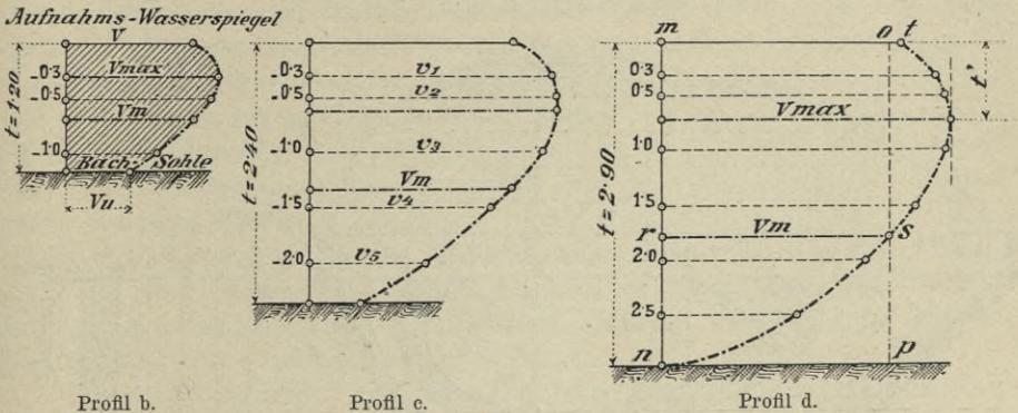
Fig. 96. Kurven der Vertikalgeschwindigkeiten.
