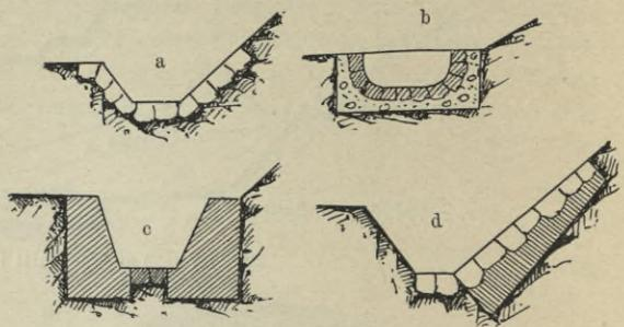
Fig. 179. Sicherung der Einschnittsgräben.
