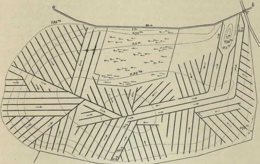
Fig. 279. Beispiel der Längsdrainage eines beckenartigen Terrains.
