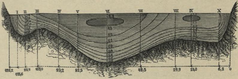
Fig. 97. Isotacheen-Profil der Elbe bei Herrnskretschchen.
