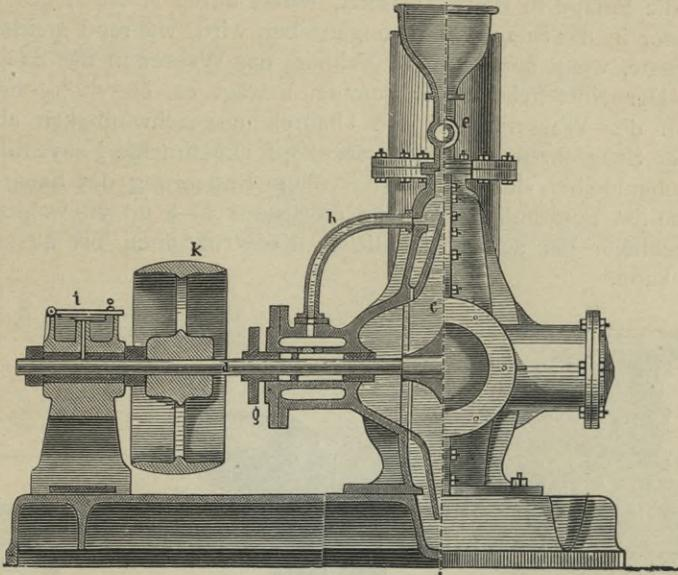
Fig. 249. Zentrifugalpumpe. Querschnitt mit teilweiser Seitenansicht.
