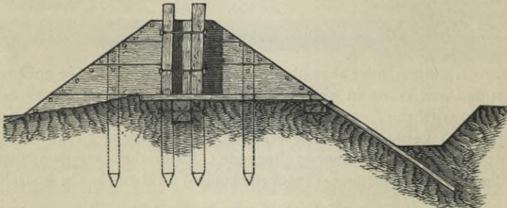
Fig. 240. Ablassung des Kolmationswassers mittels Versatzbohlen. Durchschnitt.
