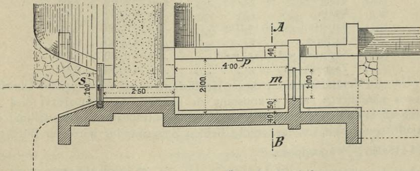
Fig. 76. Modul mittels Überfall. Grundriß.
