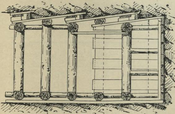
Fig. 205 *α*. Getriebezimmerung (Längsschnitt des Stollens).
