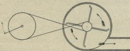
Fig. 213. Ventilator mit blasender Wirkung.
