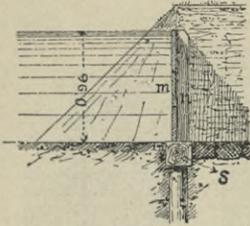
Fig. 364. Stauschwelle in Holzkonstruktion.
