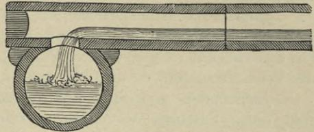
Fig. 298. Einmündung eines Saugdrains in einen Sammeldrain.
