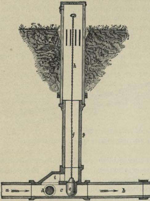
Fig. 446. v. Raumersches Ventil. Durchschnitt.
