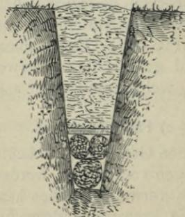
Fig. 260. Faschinendrain.
