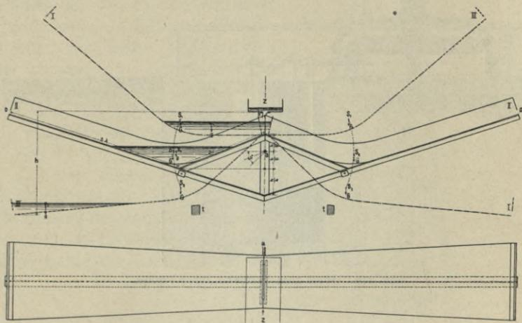
Fig. 412. Wodickas Hebelmotor.
