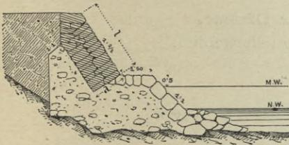
Fig. 161. Steinsatz und Trockenmauer.
