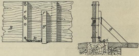
Fig. 370. Aufsätze mit hölzernen Stützen.
