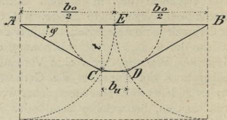
Fig. 100. Konstruktion der rationellsten Profilform.
