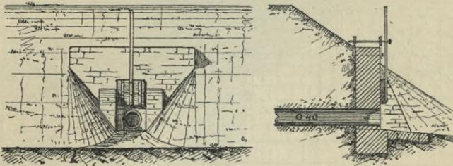
Fig. 341. Zementrohrdurchlaß.
