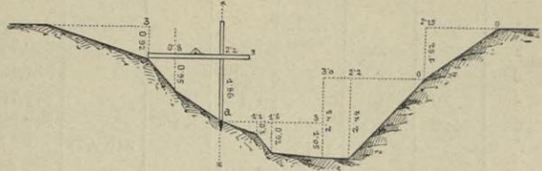
Fig. 120. Abstaffelung eines Querprofils.
