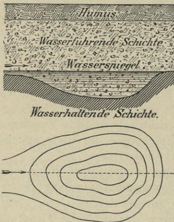
Fig. 30. Horizontalgrundwasser.
