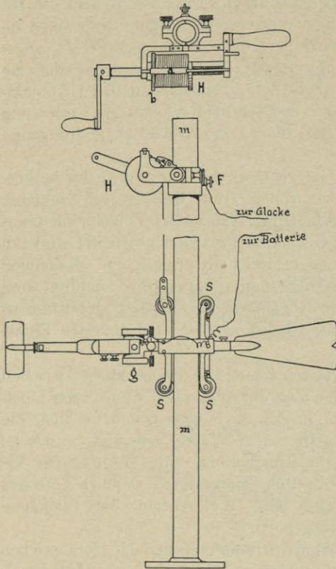
Fig. 49. Flügel mit elektrischer Zeichengebung und Schlittenführung.
