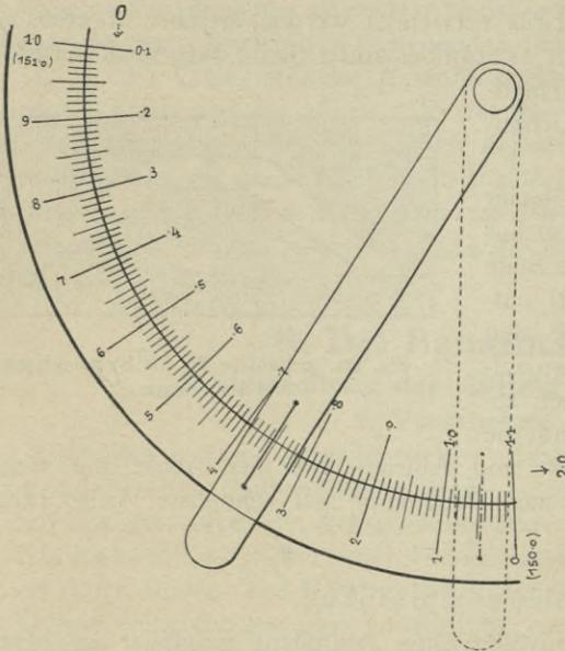
Fig. 122. Höhenkotenrechner von Gjuran.
