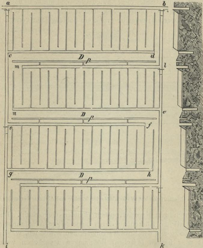
Fig. 440. Wiederbenutzung des Wassers beim Rückenbau.
