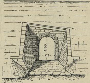
Fig. 228. Auslauf eines schiefen Objektes.
