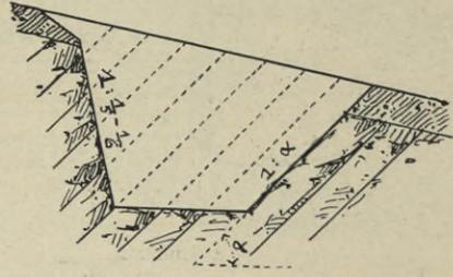
Fig. 172. Profil bei geneigten Felschichten.
