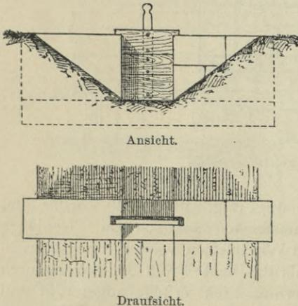
Fig. 346. Kleine Handstauschütze in Mauerwerk.
