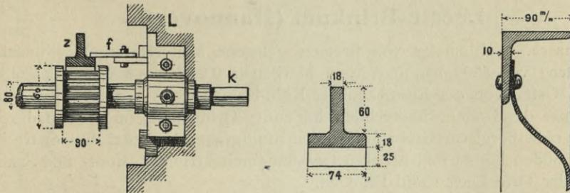
a) Grundriß des Seitenständers  $L$ . b) Profil der Zahnstange. c) Detail des Schützenrahmens.
