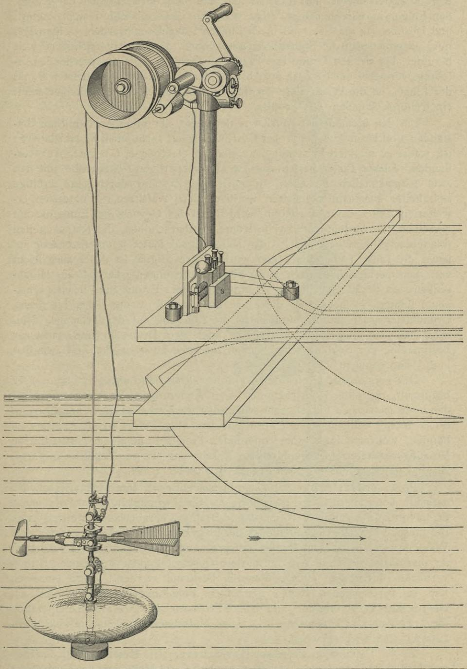
Fig. 50. Amsler-Laffonscher Flügel mit Aufhängevorrichtung und elektrischem Grundtaster.
