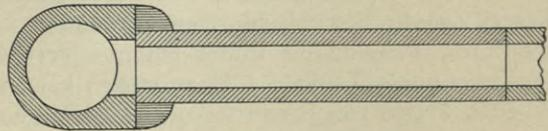
Fig. 301. Formstücke bei seitlicher Einmündung.
