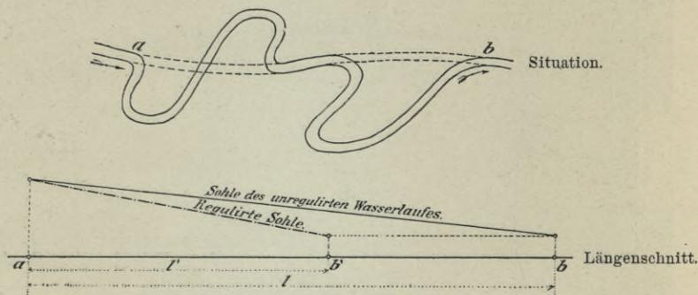
Fig. 235. Anlage von Durchstichen.
