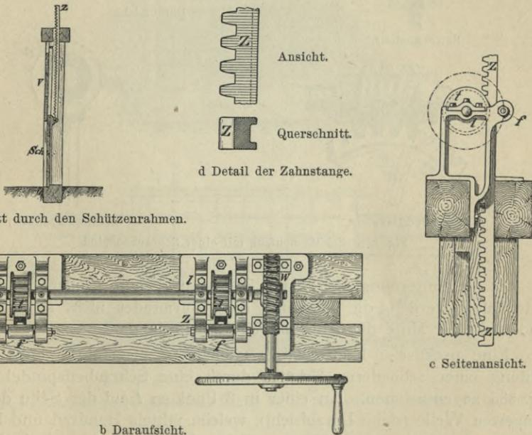
a Querschnitt durch den Schützenrahmen.
