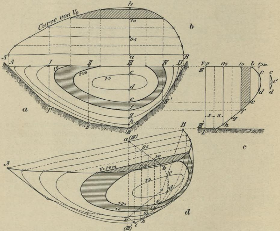
Fig. 98. Konstruktion der Isotacheen.
