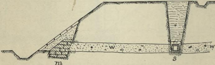
Fig. 186. Entwässerung durch Steinschichtung und Sickergräben.
