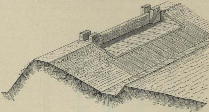
Fig. 239. Überfall für das Kolmationswasser.
