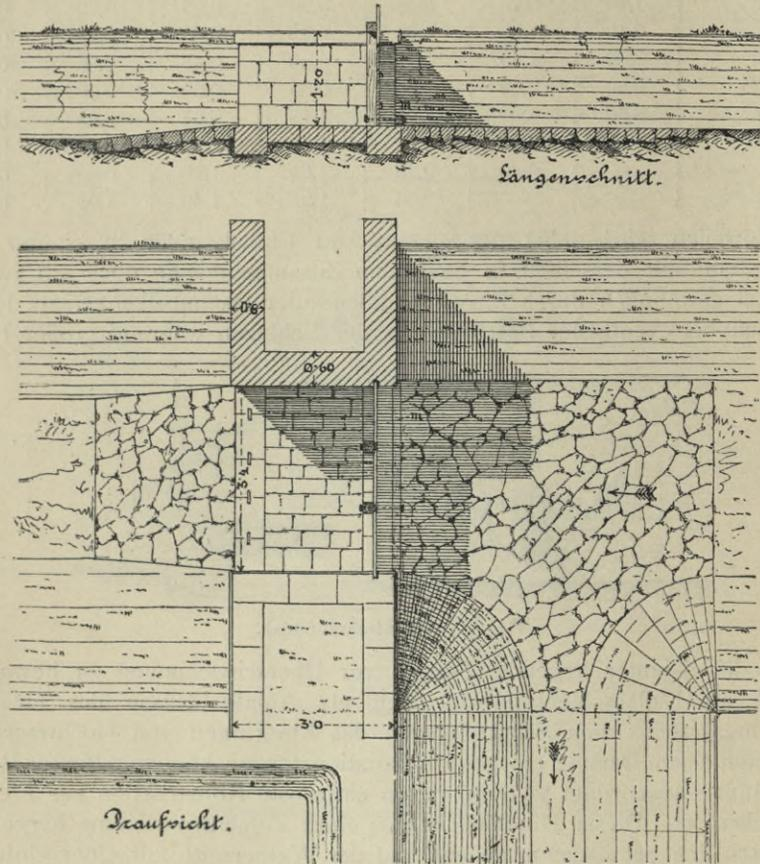
Fig. 342. Stauschleuse mit Sohlengefällebruch im Hauptzubringer.
