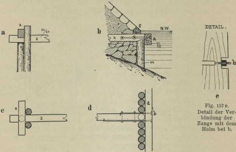
Fig. 157. Pilotenwand mit Erdanker.
