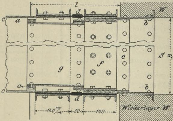
Fig. 357. Aquäduktbildung mit Dilatation. Daraufrsicht.
