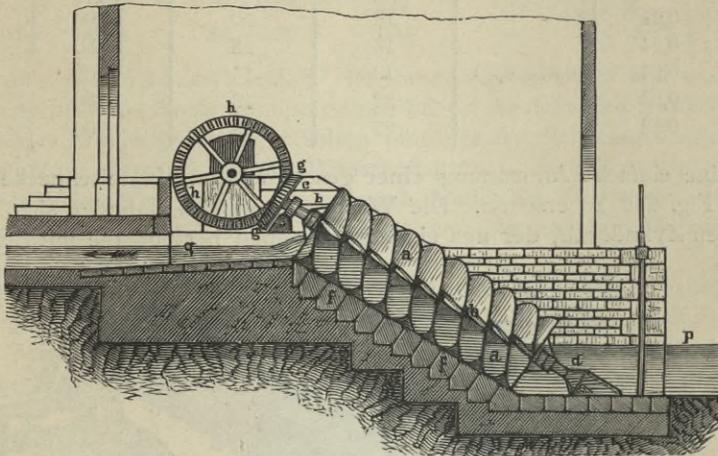
Fig. 242. Wasserschraube.
