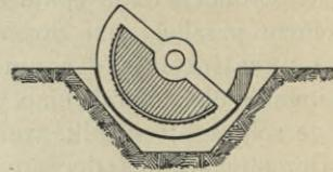
Fig. 421. Staudrehschütze aus Steingut.
