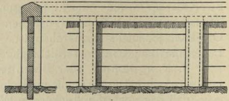
Fig. 386. Einfache Pfahlwand.
