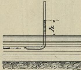
Fig. 36. Hydrometrische Röhre.
