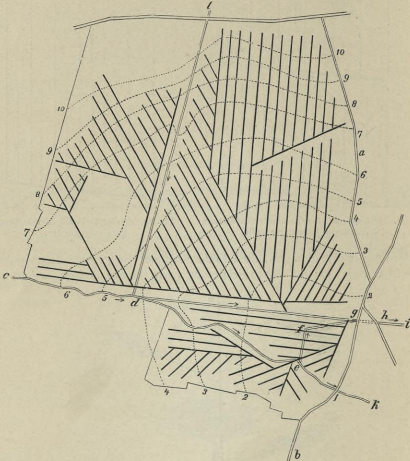
Fig. 278. Beispiel einer Längsdrainage, verbunden mit offenen Gräben.
