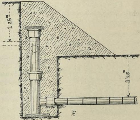
Fig. 310. Absturzschaft (Querschnitt) aus glasierten Steinzeugröhren.
