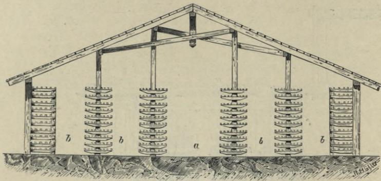
Fig. 324. Trockenschuppen. Querschnitt.
