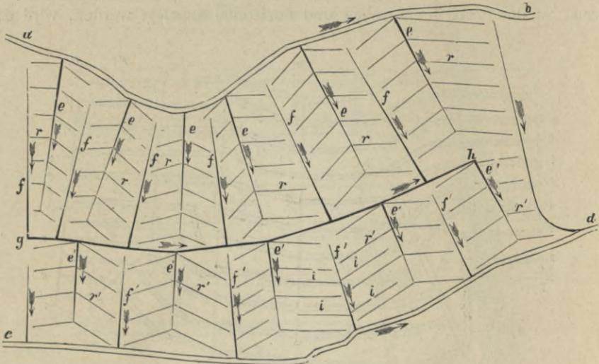
Fig. 426. Etagenhangbau mit geneigten Rieselrinnen.
