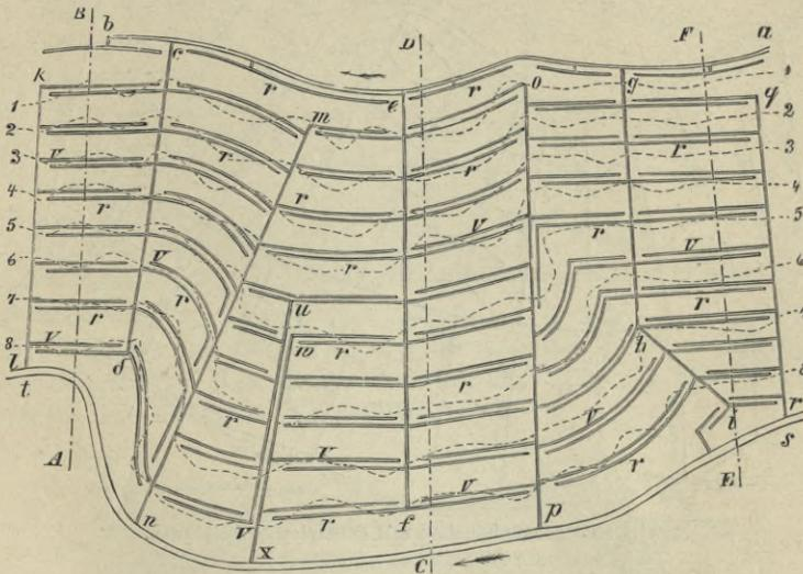
Fig. 425. Kunsthangbau mit Entwässerungsgräben auf kuppeltem Terrain ohne Wiederbenutzung des Wassers.
