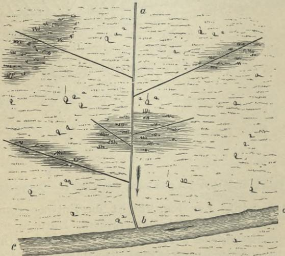
Fig. 277. Drainierung von quelligem Boden (Einzel- oder Partialdrainage).
