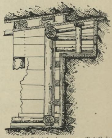
Fig. 205 *β*. Getriebezimmerung (Detail des Zimmerungsfortschrittes vor Ort).
