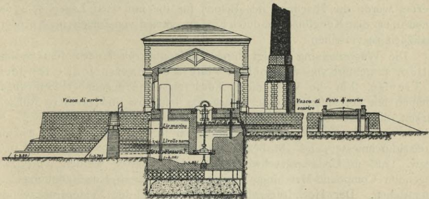
Fig. 485. Querschnitt durch das Pumpwerk von Ostia.
