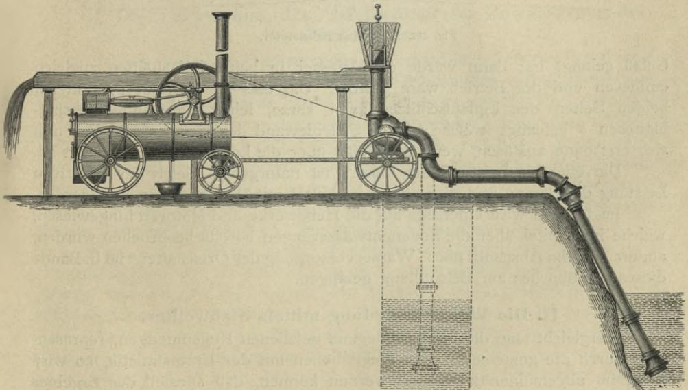
Fig. 411. Lokomobile mit Zentrifugalpumpe.
