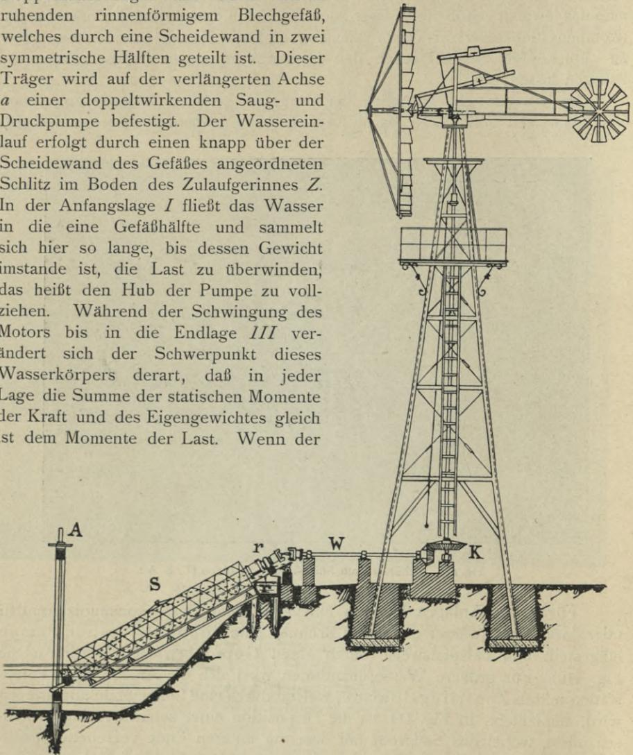
Fig. 409. Reinscher Windmotor für Bewässerungszwecke.
