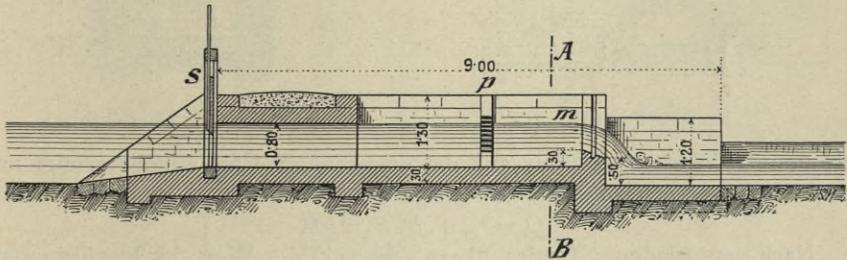
Fig. 75. Modul mittels Überfall. Längenschnitt.
