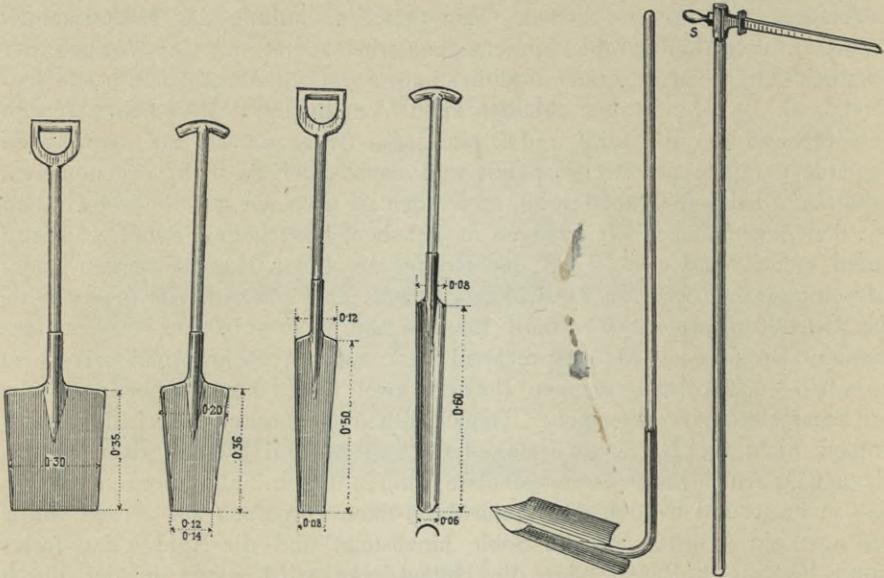
Fig. 287. Breitspaten. Fig. 288. Stichspaten I. Fig. 289. Stichspaten II. Fig. 290. Hohlspaten. Fig. 291. Schippe. Fig. 292. Legehaken.
