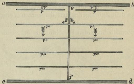
Fig. 417. Natürlicher Hangbau ohne Entwässerungsrinnen in ebenem Terrain.
