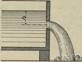
Fig. 64. Wasserzoll. Längenschnitt.
