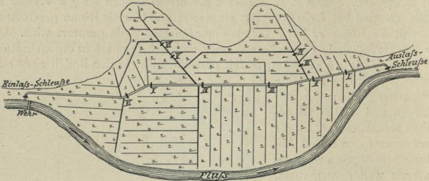
Fig. 415. Grabenstaubau. (I—VI Grabenstauschleusen.)
