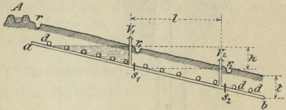
Fig. 445. Petersensches System. Längenschnitt.
