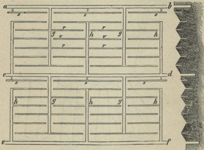
Fig. 439. Wiederbenutzung des Wassers beim Rückenbau
