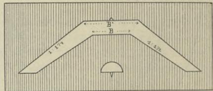
Fig. 121. Schablone für die Einzeichnung der Böschungen.
