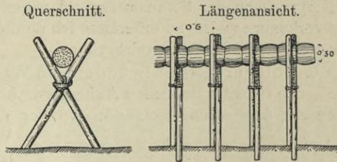
Fig. 139. Gerüste zur Wippenherstellung.
