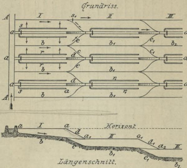
Fig. 441. Etagenrückenbau mit kombinierter frischer und Abwasserberieselung.
