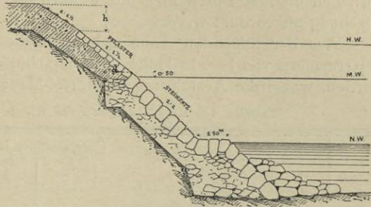
Fig. 160. Steinsatz und Pflaster.
