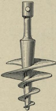
Fig. 3. Erdbohrer für leichtere Erde.
