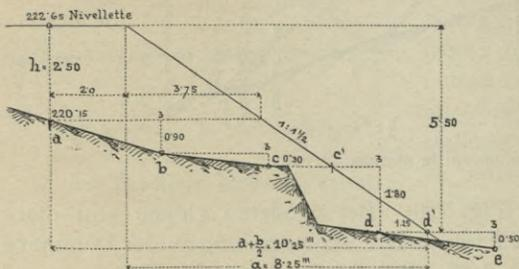
Fig. 128. Bestimmung des Fußpunktes durch Abstufung.
