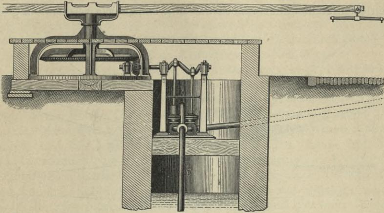
Fig. 410. Göpel zum Betriebe einer Pumpe.
