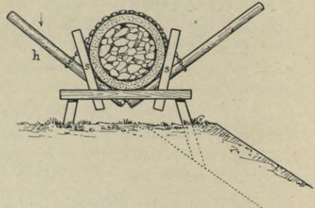
Fig. 150. Herstellung einer Sinkwalze.
