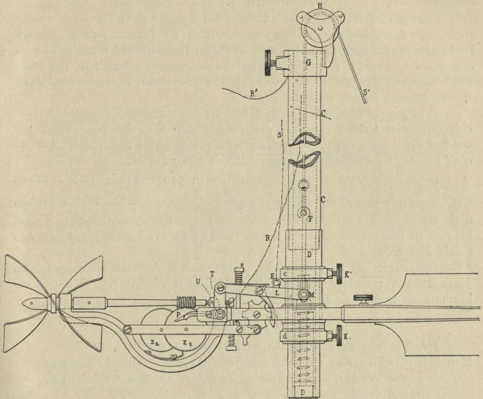
Fig. 46. Amsler-Laffonscher Flügel mit Zählwerk und elektrischer Zeichengebung.
