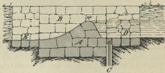
Fig. 367. Festes Wehr aus Quadermauerwerk.
