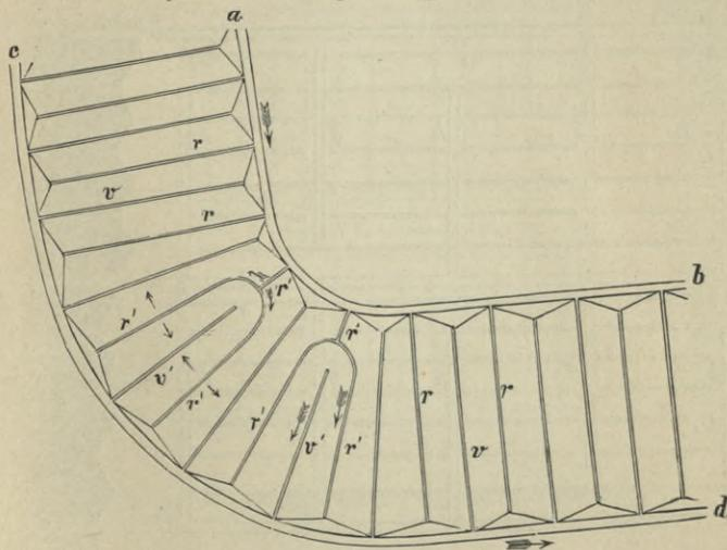
Fig. 437. Rückenbau auf kupiertem Terrain.
