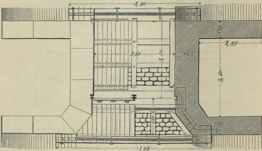
Fig. 338. Schleuse mit eisernem Schützenrahmen. Grundriß mit Horizontalschnitt.
