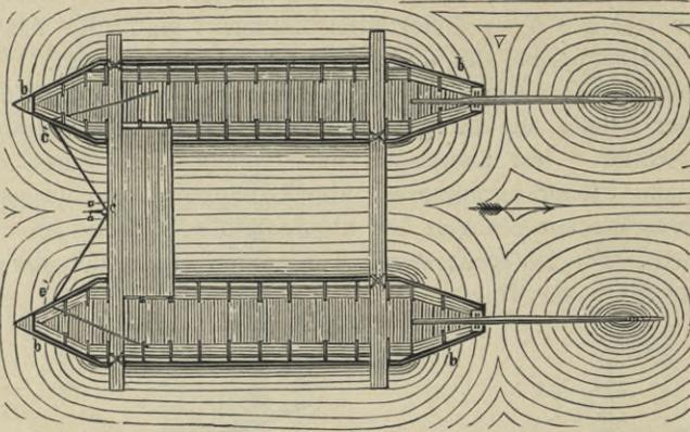
Fig. 44. Stromgeschwindigkeits-Messung mit dem Woltmannschen Flügel. Grundriß.
