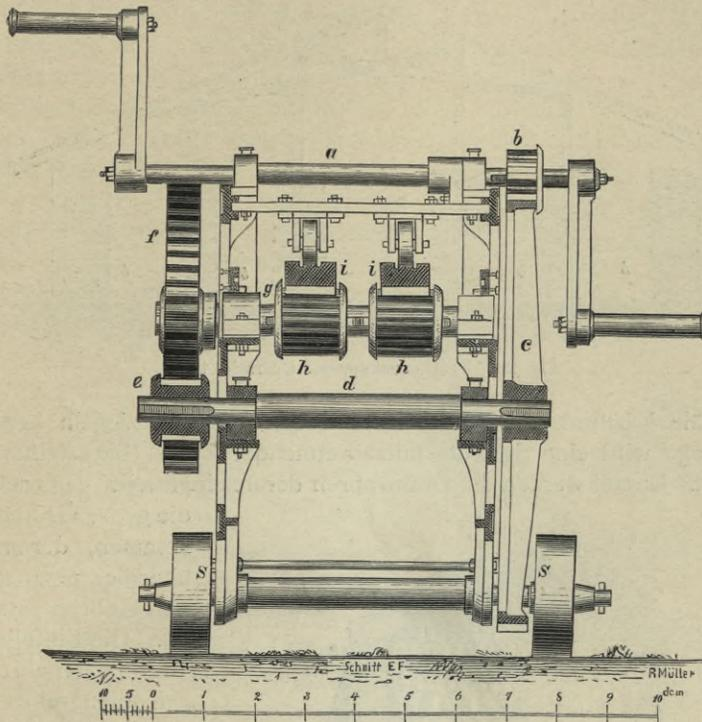
Fig. 321. Drainröhrenpresse. Querschnitt durch das Getriebe.
