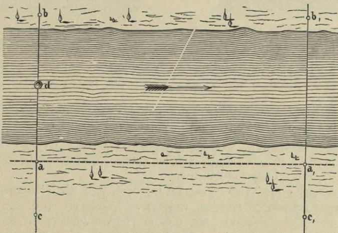
Fig. 32. Schwimmermessung.
