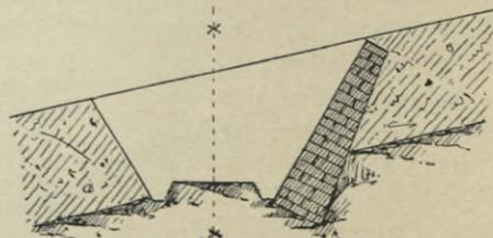
Fig. 200. Stützmauer als Widerlager.
