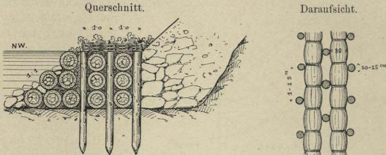
Fig. 152. Parallelwerk aus Sinkwalzen.
