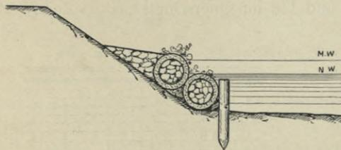
Fig. 151. Dammfuß-Sicherung durch Sinkwalzen.
