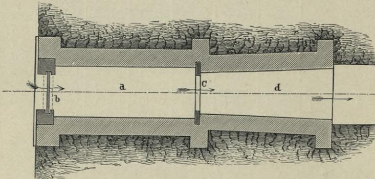
Fig. 73. Mailändischer Modulus. Horizontalschnitt.
