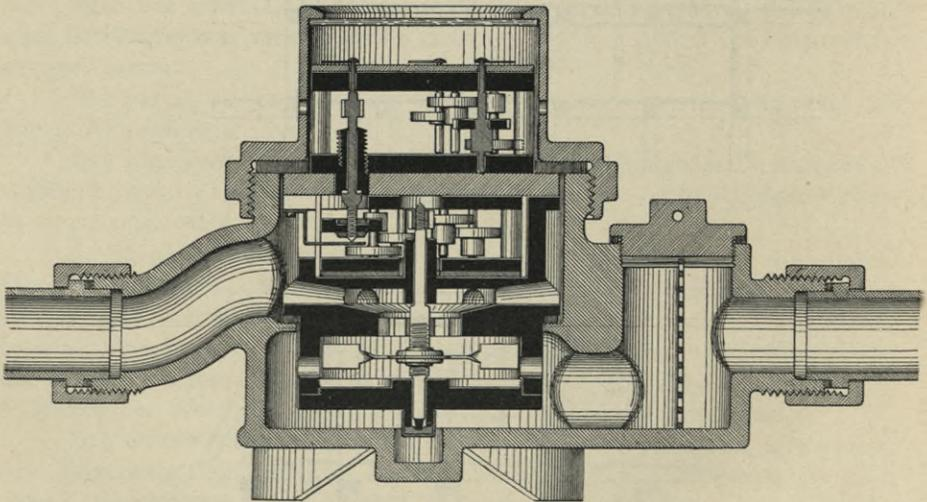
Fig. 61. Schinzelscher Wassermesser. Längenschnitt.
