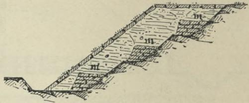
Fig. 185. Entwässerung mit Steinschichtungen.
