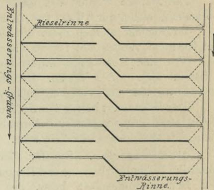
Fig. 455. Rückenbau der Marcite.
