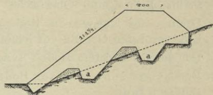
Fig. 125. Dammfeld auf steilen Abhängen.
