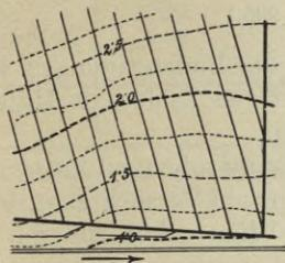
Fig. 263. Längsdrainage.
