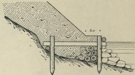
Fig. 153. Versicherung der Vorsteckpfähle durch Erdzangen.
