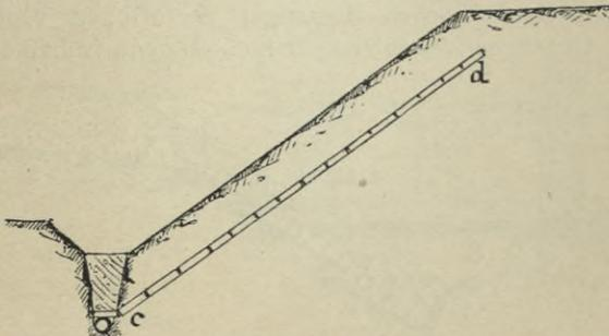
Fig. 189 b. Entwässerung durch Längsdrainage. Querschnitt.
