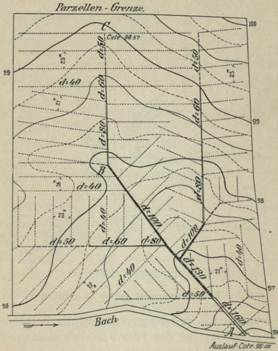
Fig. 283. Entwässerungsplan mittels Querdrainage.
