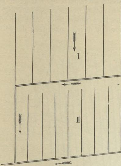
Fig. 275. Drainsystem mit vermindertem Abstand der Saugdrains am unteren Ende.
