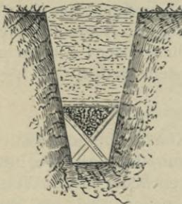
Fig. 259. Faschinendrain
