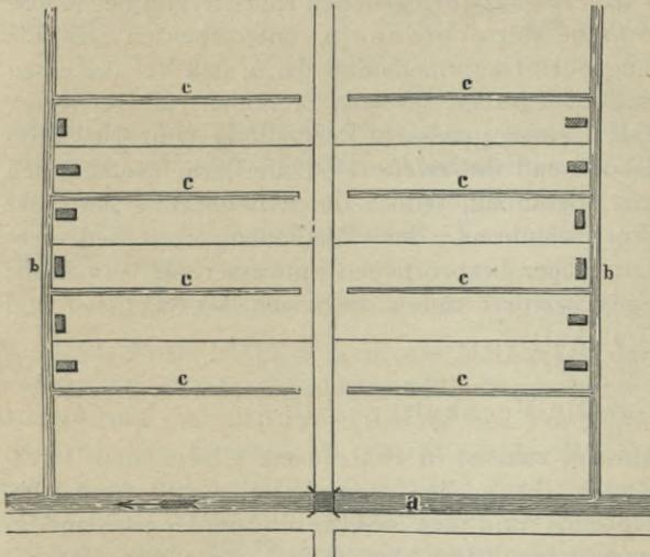
Fig. 328. Veenanlage mit Hauptwyken.
