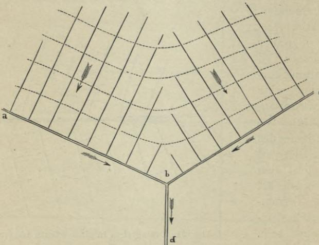
Fig. 274. Drainsystem auf einem Terrainrücken.
