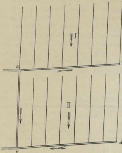
Fig. 268. Einzeichnung des Drainrohrnetzes bei sehr flachem Terrain.
