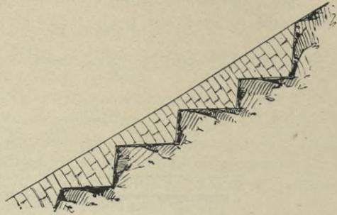
Fig. 193. Steinrippen (Querschnitt).
