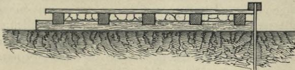
Fig. 397. Liegender Rost. Längensprofil.
