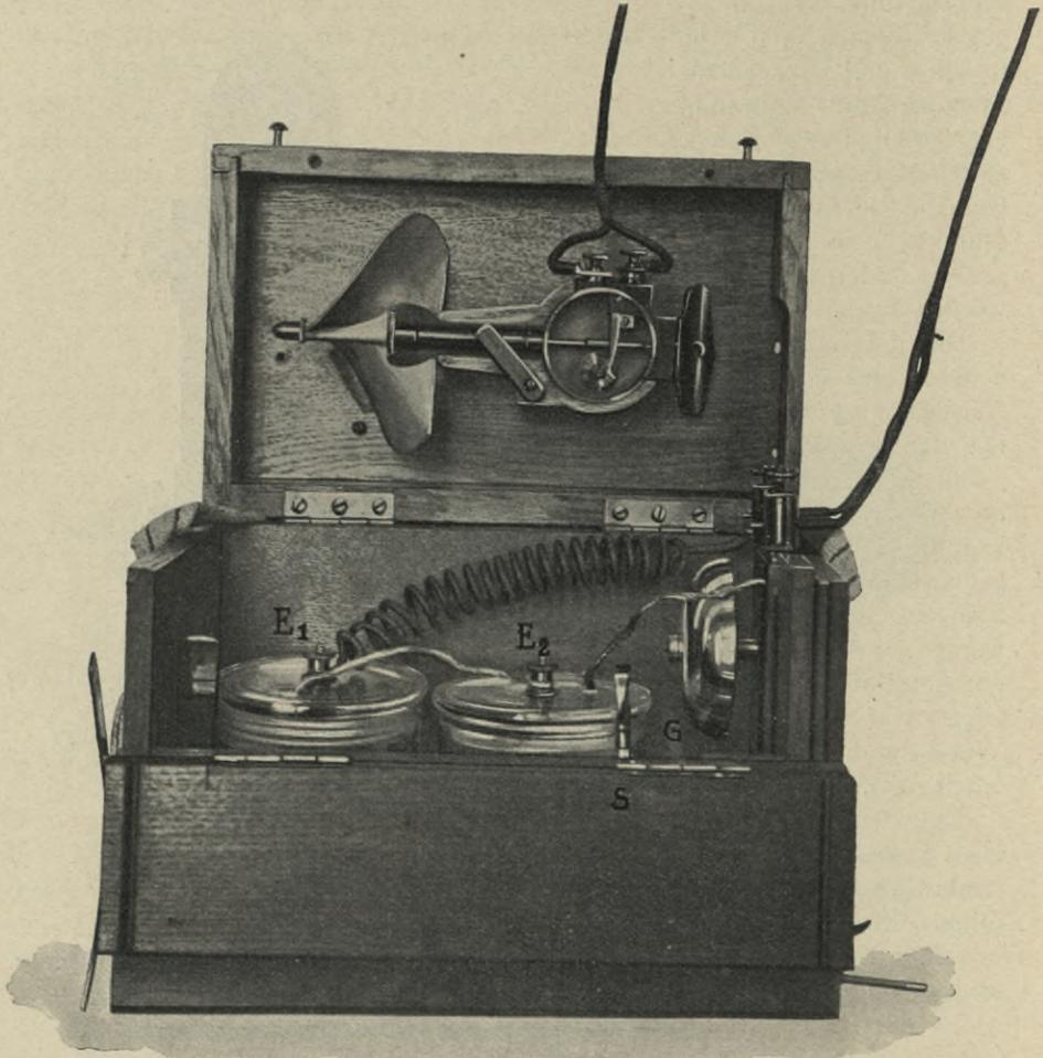
Fig. 54. Gauserscher hydrometrischer Taschenflügel.
