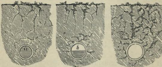
Fig. 315. Veränderung der Bodenstruktur durch die Drainage.
