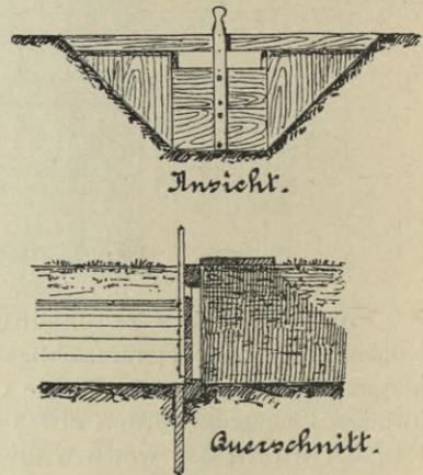
Fig. 347. Kleine Handstauschütze in Holz.
