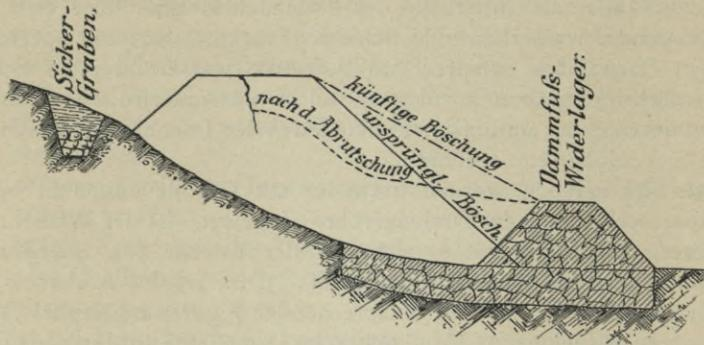
Fig. 130. Sicherung eines abgerutschten Dammes durch ein Fußwiderlager.
