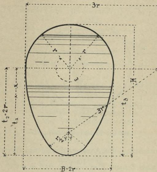
Fig. 103. Eiförmiges Kanalprofil.
