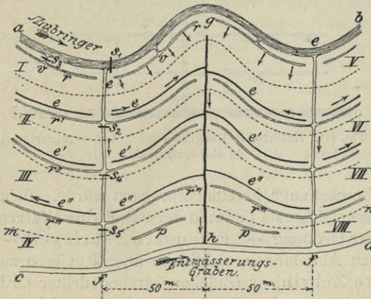
Fig. 419. Natürlicher Hangbau mit Entwässerungsrinnen in kuptiertem Terrain.
