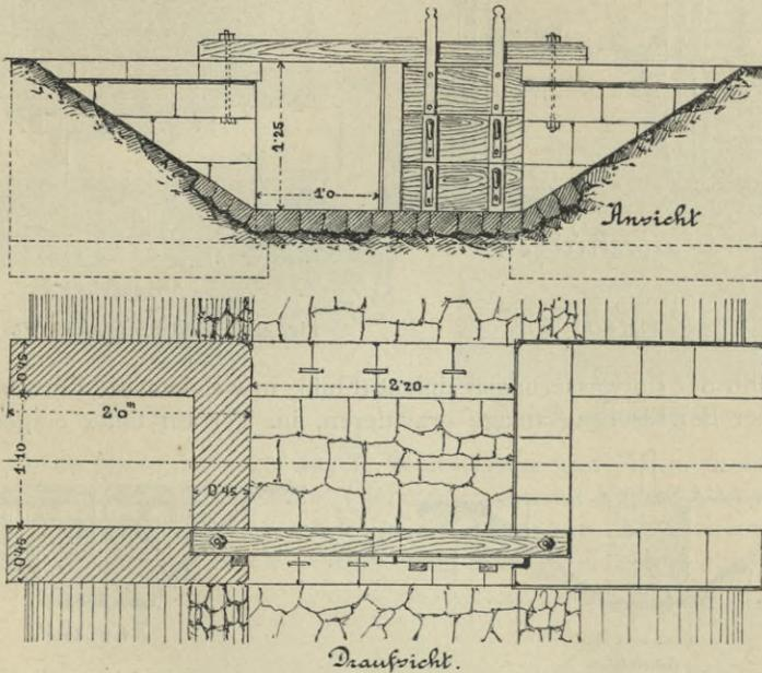
Fig. 343. Stauschütze im Zuleitungsgraben.
