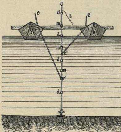
Fig. 45. Stromgeschwindigkeits-Messung mit dem Woltmannschen Flügel. Vorderansicht.
