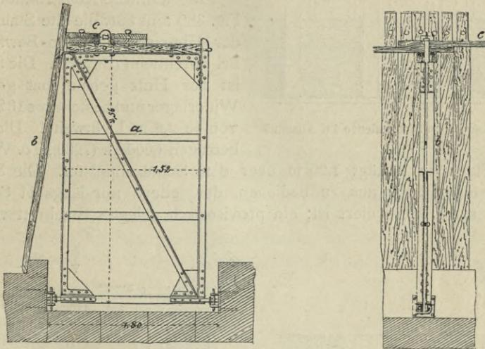
Fig. 377. Nadelwehr (Eisenkonstruktion).
