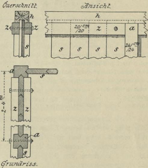
Fig. 393. Spundwand mit provisorischen Leitzangen.
