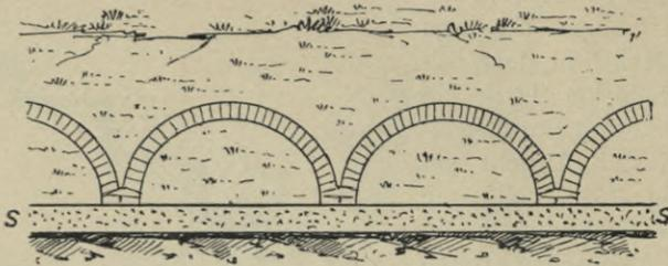
Fig. 196. Bogenförmige Steinsporen (Ansicht).
