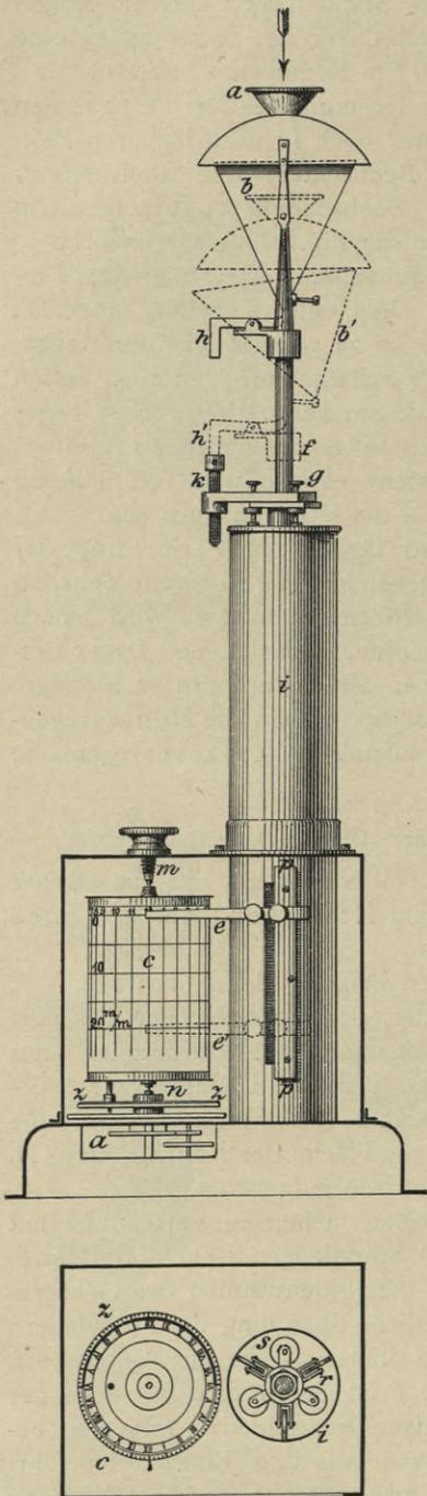
Fig. 25. Selbstregistrierender Regenmesser (System Hottinger).
