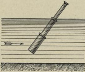
Fig. 35. Hydrometrischer Stab.
