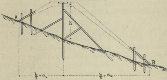
Fig. 127. Dammprofil in steilem Terrain.
