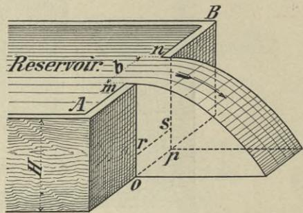
Fig. 82. Ausfluß aus dünnen Wänden.
