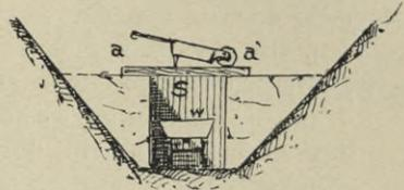
Fig. 176. Abbau mit Sohlenslitz.
