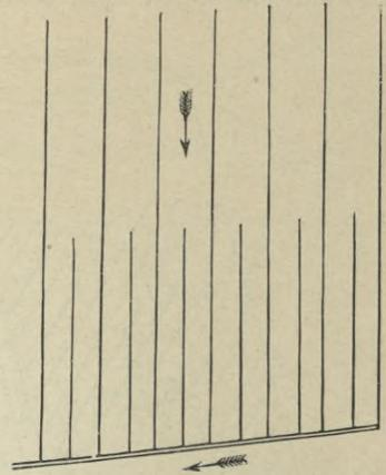
Fig. 276. Drainsystem mit Einschaltung kurzer Saugdrains.
