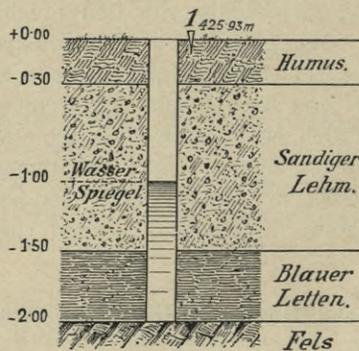
Fig. 9. Graphische Darstellung der Bohrung für Bohrloch No. 1.
