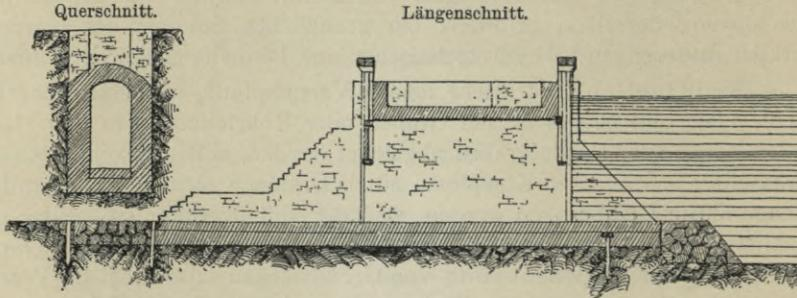
Fig. 236. Kolmationsschleuse.
