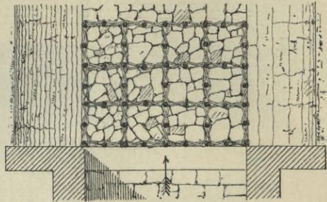
Fig. 358. Grabensohlensicherung im Anschluß an die Einlaßschleuse.
