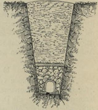
Fig. 258. Dachziegeldrain.
