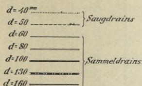
Fig. 269. Bezeichnung der Drainstränge in schwarzer Farbe.
