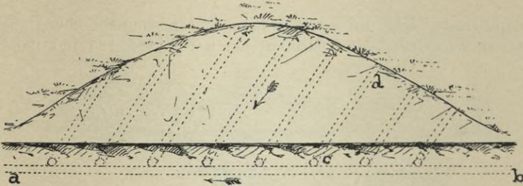
Fig. 189 a. Entwässerung durch Längsdrainage. Ansicht.
