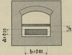
Fig. 74. Einlaufkammer.
