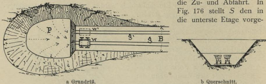
Fig. 174. Etagen-Abbau ohne Rampen.
