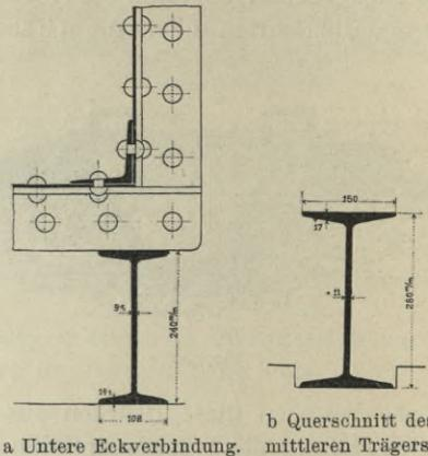
Fig. 354. Details zum Blechaquädukt (Tafel IX).
