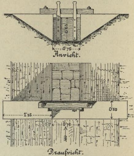
Fig. 345. Stauschütze eines Wassergrabens.
