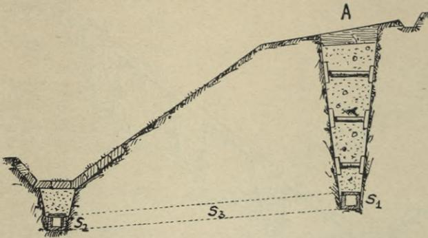
Fig. 188. Ausspülung tiefer Sickerschlitzte.
