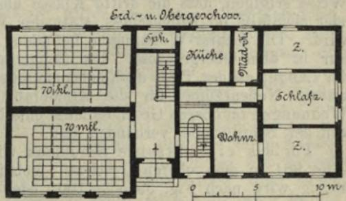
weiterung der Schule ist es zweckmässig, Lage und Abmessung der Wohnräume so einzurichten, dass durch Fortnahme leichter Wände ohne erheblichen Zeit- und Kostenaufwand ein neues Schulzimmer hergestellt werden kann, in welchem Fall die Lehrerwohnung in das Dachgeschoss oder einen neuen Geschossaufbau verlegt wird. Noch leichter wird im Bedarfsfall die zweite Klasse über der ersten errichtet, wozu besonders die Anordnung Fig. 88 sich eignet. Das Dach
