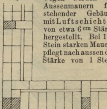
Des Wärmeschutzes wegen werden die Aussenmauern freistehender Gebäude mit Luftschichten von etwa 6 cm Stärke hergestellt. Bei  $1\frac{1}{2}$  Stein starken Mauern pflegt nach aussen die Stärke von 1 Stein
