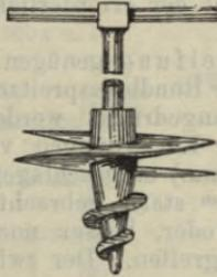
Grube zum Einsetzen von Gerüstpfählen usw.
