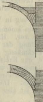
Ueber diese, nach der Form des Bogens abgesehen, werden  $\frac{2}{4}$  cm starke, vorher 24 Stunden in Wasser geweichte Latten gebogen und genagelt. Diese Lehrbögen werden 0,60 m von einander entfernt gestellt und mit 2 cm starken Brettern eingeschalt.
