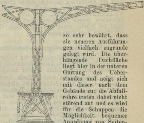
so sehr bewährt, dass sie neueren Ausführungen vielfach zugrunde gelegt wird. Die überhängende Dachfläche liegt hier in der unteren Gurtung des Ueberstandes und neigt sich mit dieser nach dem Gebäude zu; die Abfallrohre treten dabei nicht störend auf und es wird für die Schuppen die Möglichkeit bequemer Anordnung von Seitenlicht gewonnen.
