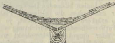
gleich breiten Gebände — Strakort — eingedeckt, Fig. 57 a, b, c, d, wobei die Linie, mit welcher sich die Strakortsteine überdecken, eine gerade, wie in Fig. 57 b, zuweilen aber auch, mit Ausnahme des untersten Steines, eine gebogene oder stumpfwinklige sein kann. Auch das Fussgebände besteht dann aus gleich hohen Platten.
