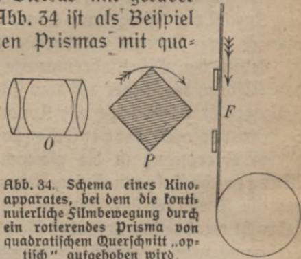
Abb. 34. Schema eines Kinoapparates, bei dem die kontinuierliche Filmbewegung durch ein rotierendes Prisma von quadratischem Querschnitt „optisch“ aufgehoben wird.
