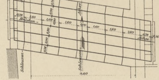
Abb. 11. Querschnitt durch die Brücke über der Schleuse. 1:20.
