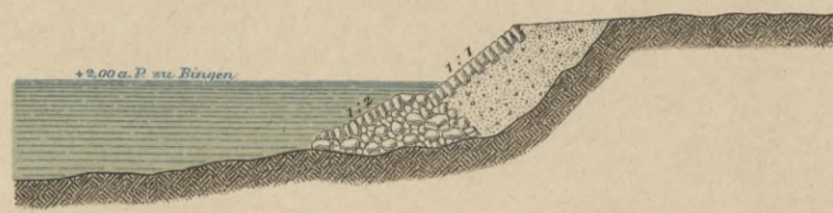
Querschnitt der Uferdeckwerke. 1:250.
