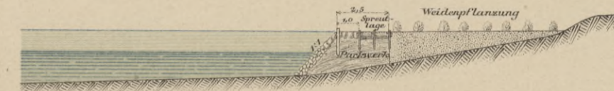
Anfertigung und Versenkung eines Senkstücks. 1:250.
